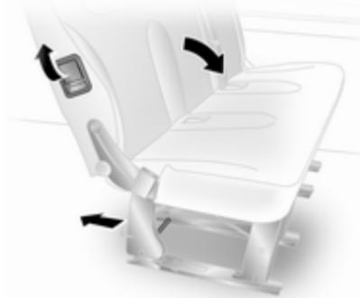
Odstranite vzglavnike ⇨ 31. Potisnite zaklopno ročico na naslonjalu in spustite naslonjalo na sedež. Po potrebi odpnite sponki varnostnega pasu iz njunih zaklepov.
