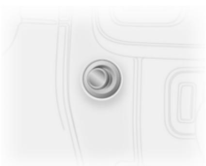
12 V električne vtičnice se nahajajo v armaturni plošči in v zadnjem delu vozila.
