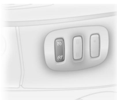
Pritisnite stikalo ☱; na instrumentni plošči sveti indikator ☱ oranžno.
