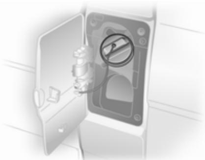
Odpiranje pokrova odprtine: vstavite ključ, ga obrnite v obratno smer urinega kazalca in odvijte pokrov. Po
