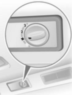
Stopnja zračnega pritoka je odvisna od ventilatorja. Temperaturo lahko uravnavate s temperaturnim stikalom na armaturni plošči.
