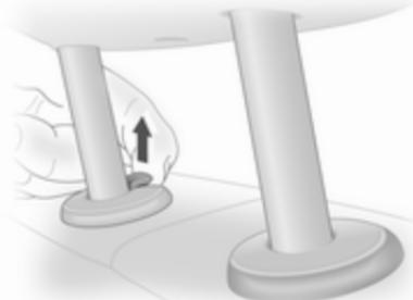
Za odstranitev vzglavnika povlecite zaskočni gumb in vzglavnik izvlecite. Vzglavnik zavarujte v prtljažniku. Ne vozite vozila z odstranjениm vzglavnikom, če je zadevni sedež zaseden.
