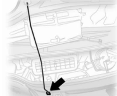
Zataknite podporno prečko.
