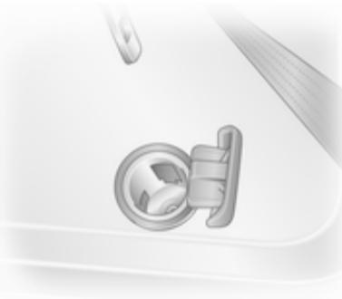
Če motor ne obratuje, utegne poraba električnega toka pri vklopljeni dodatni električni opremi izprazniti akumulator. Maksimalna poraba moči ne sme presegati 120 vatov.
