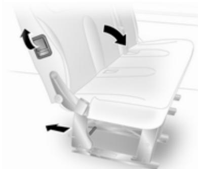
Odstranite vzglavnike ⚫ 32. Potisnite zaklopno ročico na naslonjalu in spustite naslonjalo na sedež. Po potrebi odpnite sponki varnostnega pasu iz njunih zaklepov.
