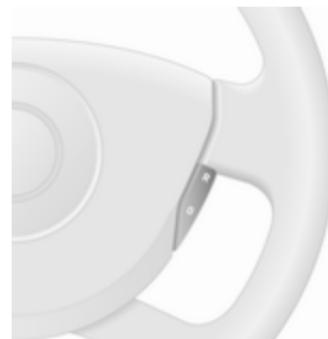
Pritisak tipke **O**: Tempomat je izklopljen in zelena kontrolna lučka na instrumentni plošči ugasne.
