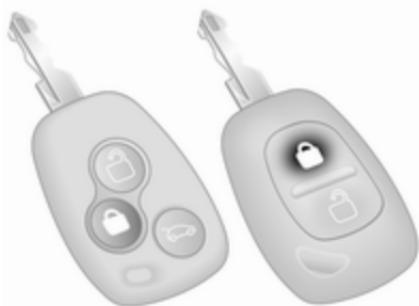
Za aktiviranje alarmne naprave pritisnite gumb . V potrditev aktiviranja dvakrat utripnejo varnostne utripalke.
