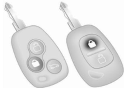
Pritisnite in pridržite gumb ; v potrditev se oglasi zvočni signal. To stanje se ohrani, dokler ne odklenete vrat.
