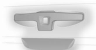
Po odklepanju z radijskim daljinskim upravljalnikom pritisnite gumb na vratih prtljažnika in dvignite vrata do konca navzgor.
