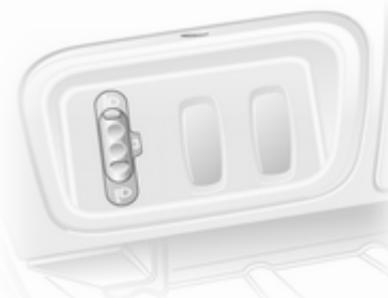
Nastavite višino žarometov glede na obtežbo vozila, da ne slepite nasproti vozečih.
