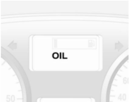
Če je dosežen minimalni nivo motornega olja, se v voznikovem informacijskem zaslonu po vključitvi kontakta vžiga prikaže sporočilo **OIL** za 30 sekund. Preverite nivo olja ▷ 117.
