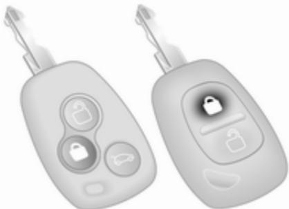
Za aktiviranje alarmne naprave pritisnite gumb . V potrditev aktiviranja dvakrat utripnejo varnostne utripalke.
