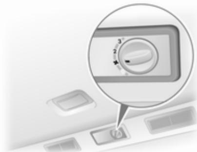
Stopnja zračnega pritoka je odvisna od ventilatorja. Temperaturo lahko uravnavate s temperaturnim stikalom na armaturni plošči.
