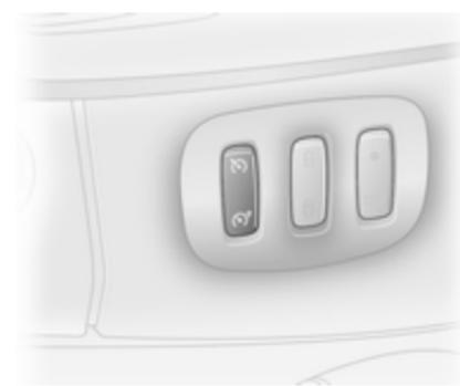
Pritisnite stikalo ; na instrumentni plošči sveti indikator v rumeni barvi.
