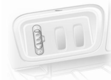
Nastavite višino žarometov glede na obtežbo vozila, da ne slepite nasproti vozečih.
