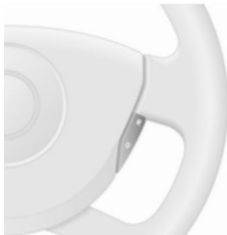
Pritisnite gumb **O**: Tempomat je izklopljen in zelena kontrolna lučka na instrumentni plošči ugasne.
