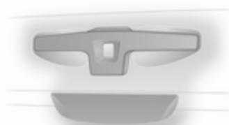
Po odklepanju z radijskim daljinskim upravljalnikom pritisnite gumb na vratih prtljažnika in dvignite vrata do konca navzgor.
