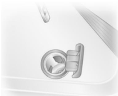
Če motor ne obratuje, utegne poraba električnega toka pri vklopljeni dodatni električni opremi izprazniti akumulator. Maksimalna poraba moči ne sme presegati 120 vatov. V vtičnice ne vklapljamte dostavnikov električne energije, npr. polnilcev ali baterij.
