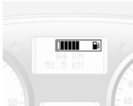
Ko je rezervoar poln, so osvetljene vse črtice razen opozorilne črtice za rezervo (črtica na skrajni levi strani merilnika količine goriva), ki ostane plitva.
