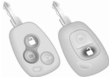
Za odklepanje vozila pritisnite (ali pritisnite in pridržite) gumb .
