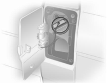
Odpiranje pokrova odprtine: vstavite ključ, ga obrnite v obratno smer urinega kazalca in odvijte pokrov. Po dotakanju goriva namestite pokrov na odprtino in obrnite ključ do konca v desno.
