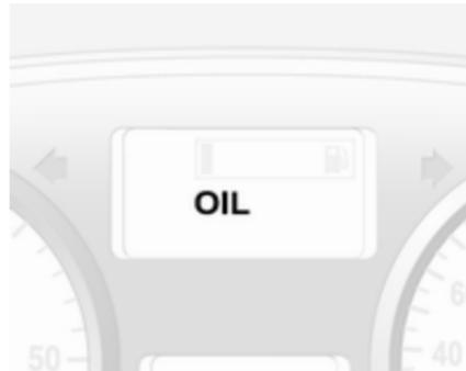
Če je dosežen minimalni nivo motornega olja, se v voznikovem informacijskem zaslonu po vključitvi kontakta vžiga prikaže sporočilo OIL za 30 sekund. Preverite nivo olja  $\diamond 120$ .
