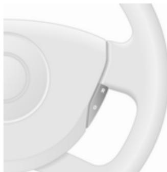
Pritisnite gumb **O**: Tempomat je izklopljen in zelena kontrolna lučka
