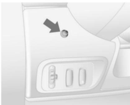
Namesto daljinskega upravljalnika lahko za vključitev in izključitev ogrevanja uporabljate tudi tipko na armaturni plošči. S pritiskom na to tipko se ogrevanje vključi za 30 minut.
