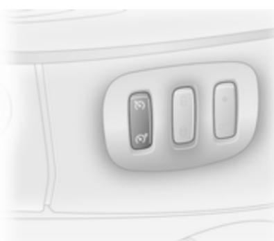
Pritisnite stikalo ; na instrumentni plošči sveti indikator v rumeni barvi.
