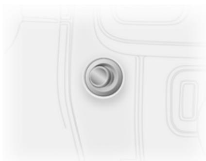
12 V električne vtičnice se nahajajo v armaturni plošči in v zadnjem delu vozila.
