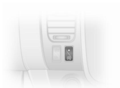
Za ročno izključitev sistema Stop-start pritisnite
