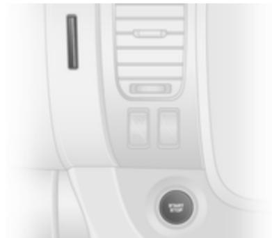
Elektronski oddajnik (ključ) mora biti v vozilu v čitalniku kartic ali v sprednjem delu potniške kabine.
