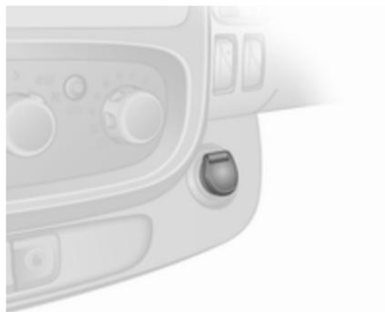
12-V električne vtičnice se nahajajo v armaturni plošči in v zadnjem delu vozila. Pokrov preklonite navzgor.
