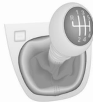
Vzvratno prestavo vklopite, ko vozilo miruje: pritisnite pedal sklopke, potegnite navzgor vzvod na ročici in prestavite prek točke upora.
