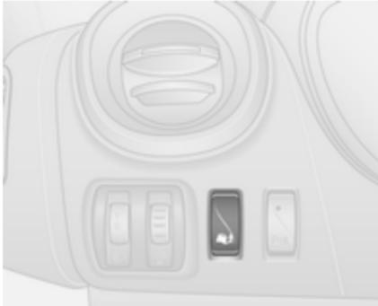
Po potrebi lahko v primeru, da so cestne površine mehke, pokrite z blatom ali snegom, izklopite ESP®Plus, da povečate oprijem: Pritisnite
