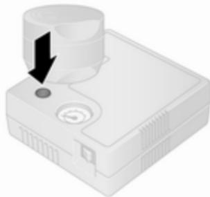
12. Predpisana vrednost tlaka mora biti dosežena v 15-ih minutah. Tlak v pnevmatikah  $\hat{>}$  204. Ko je ustrezna vrednost tlaka dosežena, kompresor izključite. Če predpisan tlak ni dosežen v roku 15-ih minut, odstranite komplet za popravilo pnevmatik. Premaknite vozilo za en obrat kolesa (približno 2 metra). Ponovno priklopite komplet za popravilo pnevmatik in nadaljujte s postopkom polnjenja pnevmatike še dodatnih 15 minut. Če predpisan tlak tudi po tem ni dosežen, je pnevmatika preveč
