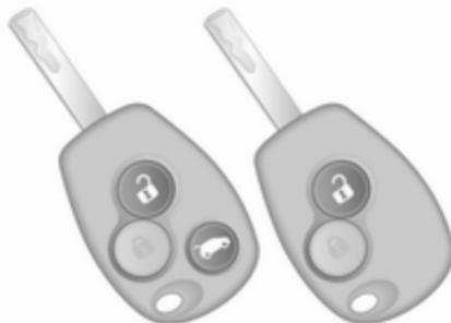
Za odklepanje voznikovih vrat pritisnite
