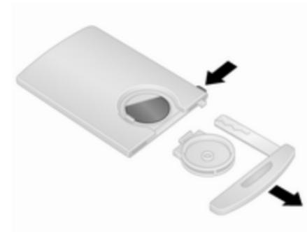
Pritisnite in držite sprostilni gumb na bočnem delu elektronskega oddajnika (ključa) ter izlecite zasilni ročni ključ iz zgornjega dela. Odpnite pokrov baterije na zadnji strani elektronskega oddajnika (ključa). Nato pritisnite baterijo na eni strani, da se sprost, ter jo odstranite.
