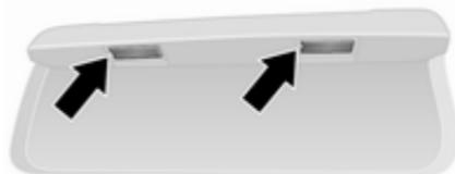
1. Iztaknite luč s ploščatim izvijačem na prikazanih mestih.
