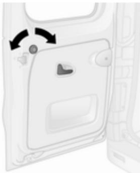
Stikalo zaklepa zasukajte v desno, da zaklenete zadnja leva vrata. Zaklep odklopite tako, da stikalo zasukate v levo.
