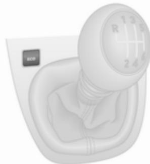
Pritisnite **ECO**. Pri vključenem stanju sveti kontrolna lučka **ECO** na instrumentni plošči.
