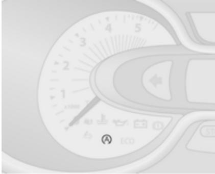
Funkcijo Autostop označuje lučka **A** na instrumentni plošči ↗ 92.
