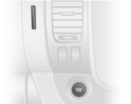
Elektronski oddajnik (ključ) mora biti v vozilu v čitalniku kartic ali v sprednjem delu potniške kabine.
