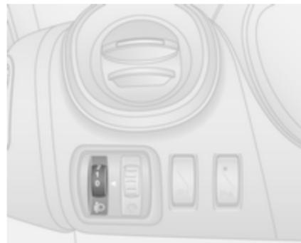
Nastavite višino žarometov glede na obtežbo vozila, da ne slepite nasproti vozečih.
