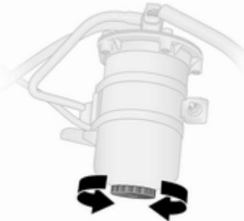
Iz filtra spustite vodo po vsaki zamenjavi motornega olja in filtra.
