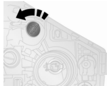
1. Obrnite nosilec z žarnico v nasprotni smeri urnega kazalca in ga izvlecite iz luči.
