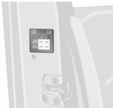
Nalepka s podatki o tlaku v pnevmatikah na voznikovem stebri vrat navaja ustrezne tlake polnjenja za originalne pnevmatike. Pnevmatike vedno napolnite do tlaka, navedenega na oznaki.
