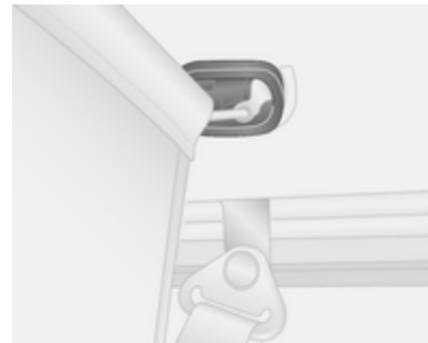
Za dostop do pritrdilnih točk sprostite pokrove v stropni oblogi (z ravnim izvijačem), nato vstavite palice varnostne mreže prtljažnika v leve in desne pritrdilne točke ter jih pritrdite.
