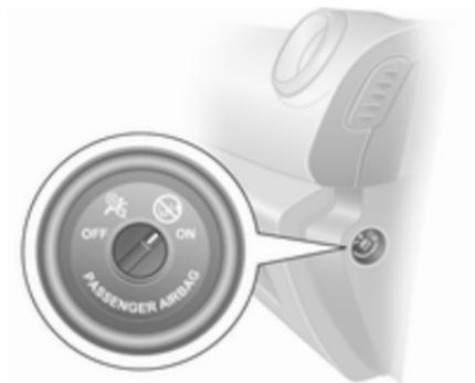
Za izklop sistema čelnih varnostnih blazin je na stranici armaturne plošče vgrajeno stikalo oz. ključavnica. Za dostop do stikala odprite sovoznikova vrata.
