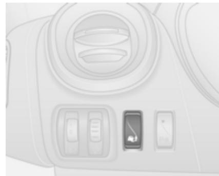
Po potrebi lahko v primeru, da so cestne površine mehke, pokrite z blatom ali snegom, izklopite sistem proti zdrsru pogonskih koles (TC), da povečate oprijem:
