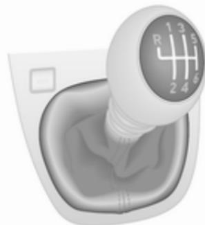
Vzratna prestava: ko vozilo miruje, pritisnite pedal sklopke, tako počakajte 3 sekunde, potegnite vzvod (pušo) navzgor in prestavite.
