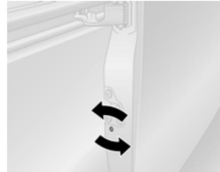
Varovalni zaklep za otroke na stranskih drsni vratih je na zadnjem robu vrat.
