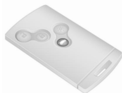
Za zaklepanje/odklepanje zadnjih vrat/prtljažnika (in stranskih drsnih vrat) pritisnite
