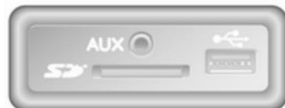
Izklopite Infotainment sistem in vstavite SD-kartico v režo na instrumentni plošči. SD kartica je lomljiva, ne upogibajte je.
