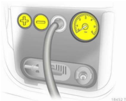
9. Vključite kompresor s pritiskom na gumb **+**. Pnevmatika se napolni s tesnilnim sredstvom.
