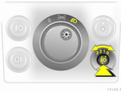
Za prilagoditev višine svetlobnega snopa, da ne slepite ostalih udeležencev v prometu: Pritisnite gumb, da izskoči in ga obrnite v zeleni položaj.
