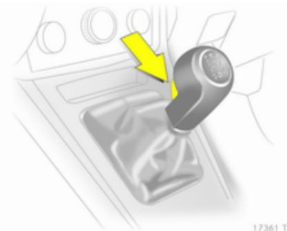
Za vklop vzratne prestave: ko vozilo miruje, pritisnite pedal sklopke, tako počakajte 3 sekunde, pritisnite gumb na prestavni ročici in prestavite.
