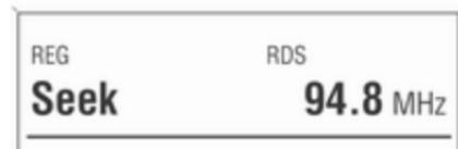
Radio utihne, dokler ne najde postaje. Če radijski sprejemnik ne najde postaje, se samodejno preklopi na občutljivejšo stopnjo iskanja (ne DAB). Če radio še vedno ne najde
