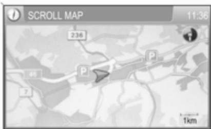
Pogled zemljevida se samodejno preklopi v dvodimenzionalni način/z zgornjo stranjo na severu (glejte "Nastavitev navigacijskega sistema" spodaj), če ta način še ni aktiven.
