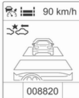
Za prikaz strani adaptivnega tempomata na voznikovem informacijskem zaslonu pritisnite gumb **MENU** na ročici smernika in obrnite namestitveni obroček, da izberete stran adaptivnega tempomata.
