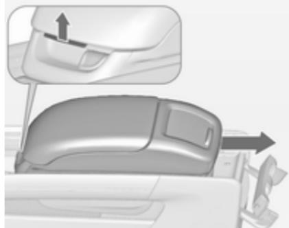
Povlecite ročico na sprednjem delu naslona za roke in ga potisnite proti zadnjem delu ter ven iz konzole. Namestitev opravite v obratnem vrstnem redu.
