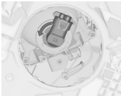
2. Nosilec žarnice obrnite v obratno smer urinega kazalca. Izvlecite nosilec z žarnico iz žarometa.
