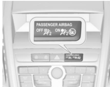
Če kontrolna lučka OFF ne sveti, se sovoznikova varnostna blazina sproži v primeru trka.
