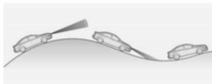
Učinkovitost sistema na klancih in med vleko prikolice je odvisna od hitrosti vozila, obremenjenosti vozila, razmer na cesti in vrste ceste. Sistem med vožnjo po klancih morda ne bo zaznal vozila na vaši poti. Na strmih klancih boste morda morali uporabiti stopalko za plin, da ohranite hitrost vozila. Pri vožnji po klancu navzdol, še posebej ob vleki prikolice, boste morda morali zavirati, da ohranite ali zmanjšate hitrost vozila.
