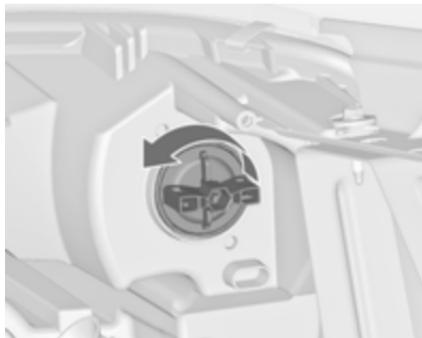
1. Držalo žarnice (3) obrnite v obratno smer urinega kazalca. Izvlecite držalo žarnice iz žarometa.
