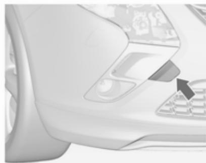
Vstavite izvijač v kratki rob pokrova. Odpnite pokrov s previdnim pomikom izvijača vstran. Za zaščito vstavite med izvijač in okvir mehko krpou.
