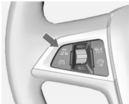
Pritisnite gumb . Trenutna nastavitev se prikaže na informacijskem centru voznika. Znova pritisnite gumb , da spremenite občutljivost opozorila. Nastavitev se prikaže tudi v zgornji vrstici voznikovega informacijskega zaslona.
