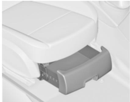
Pritisnite gumb v odprtini in izvlecite predal. Maksimalna nosilnost: 3 kg. Zapiranje predala: potisnite ga pod sedež, da se zatakne.
