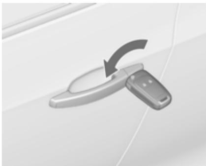
Odklenite voznikova vrata z obratom ključa v ključavnici. Vključite kontakt in pritisnite stikalo za odklepanje vseh vrat, prtljažnika in lopute rezervoarja goriva. Ob vklopu kontakta za vžig se izklopi varovalni zaklep proti kraji.
