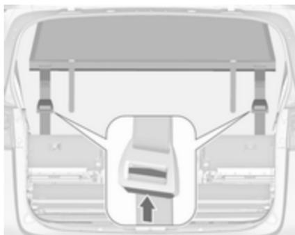
Pritisnite gumb na napenjalcu, da sprostite trak na obeh straneh. Sprostite kljukice iz ušesc. Odpnite droga varnostne mreže iz nosilcev v strešnem okviru. Navijte mrežo in jo zavarujte s trakom.
