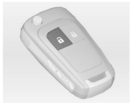
V ta namen pritisnite pri izključenem kontaktu tipko
