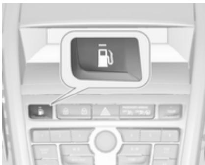
S pritiskom gumba preklapljujate med pogonom na bencin in pogonom na naravni plin. Preklop ni mogoče med veliko obremenitvijo motorja (npr. močno pospeševanje, vožnja s polnim plinom). Stanje LED lučk opozarja na trenutni način delovanja.
