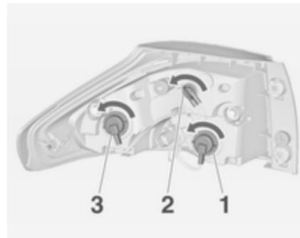
5. Odstranite in zamenjajte žarnico z obračanjem držala žarnice.
