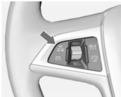
Pritisnite gumb . Trenutna nastavitev se prikaže na informacijskem centru voznika. Znova pritisnite gumb , da spremenite razdaljo sledenja. Nastavitev se prikaže tudi v zgornji vrstici voznikovega informacijskega zaslona.
