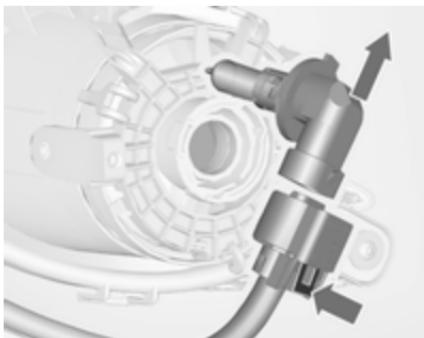
3. Držalo žarnice razvlecite s kabelskega priključka s pritiskom pritrnilne zaponke.
