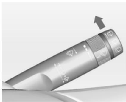
Potisnite ročično stikalo naprej. Šoba poškropi zadnje steklo, obenem brisalec nekajkrat obriše steklo.
