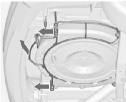
5. Dvignite nosilec rezervnega kolesa in odpnite obe varovali.
