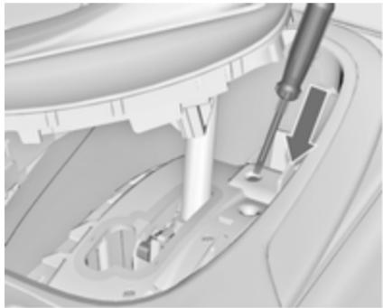
3. V odprtino vstavite izvijač do konca in premaknite izbirno ročico iz P ali N. Če pretaknete znova v P ali N, se ročica ponovno blokira. Vzrok prekinite napajanja dajte nemudoma odpraviti strokovnjakom v servisni delavnici.
