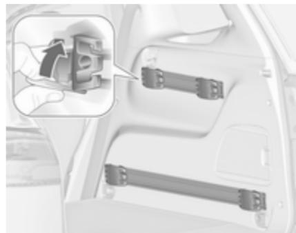
Ročico (vzvod) adapterja preklopite navzgor, adapter vstavite v zgornjo in spodnjo režo vodila in ga pomaknite v želeni položaj. Za pritrditev adapterja obrnite vzvod navzgor. Za odstranitev obrnite vzvod navzdol in ga izvlecite iz vodila.
