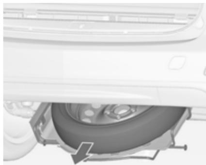
8. Nosilec kolesa spustite do konca navzdol in vzemite ven rezervno kolo.
