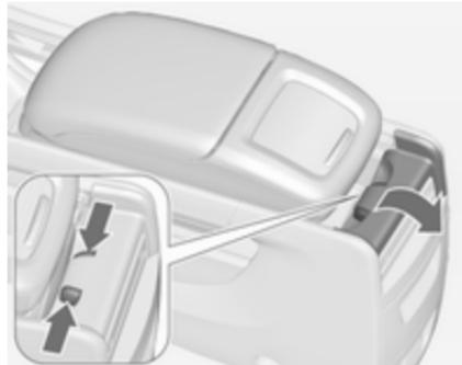
Pritrdilne elemente potisnite navznoter in prepognite navzdol zaklepni mehanizem v zadnjem delu naslona za roko.
