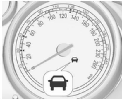
V merilniku hitrosti se prižge zelena kontrolna lučka za spredaj vožeče vozilo
