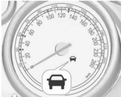
V merilniku hitrosti se prižge zeleni simbol za spredaj vočevo vozilo , če je sistem zaznal vozilo v smeri vožnje pred vami. Predpogoj za to je, da je v meniju za osebne nastavitev vozila vključeno opozorilo za trk spredaj ⇨ 126 in da funkcija ni bila izključena s tipko .
