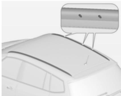
Za nameščanje strešnega prtljažnika vstavite pritrdirilne vijake v odprtine, prikazane na sliki.
