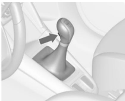
Za vklop vzvratne prestave: ko vozilo miruje, pritisnite pedal sklopke, tako počakajte 3 sekunde, pritisnite gumb na prestavnici ročici in prestavite.
