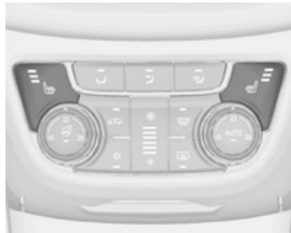
Nastavite želeno stopnjo ogrevanja s pritiskom ustreznega stikala enkrat ali večkrat. Indikator v stikalniku označuje nastavitev.
