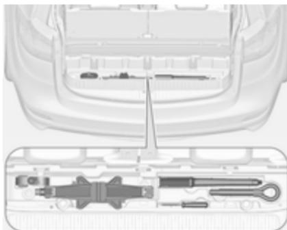
Orodja in oprema za dviganje vozila so v prostoru za spravljanje v tleh prtljažnika pred vrati prtljažnika.
