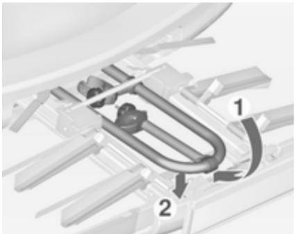
Preklopite nosilec nazaj, nato ga potisnite naprej do naslona (1). Pritisnite nosilec v zadnjem delu navzdol (2).
