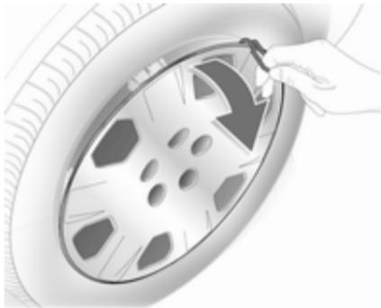
1. Pokrove vijakov odstranite s pomočjo izvijača. S kavljem iztaknite in snemite okrasni pokrov kolesa. Orodje vozila ⇨ 235.
