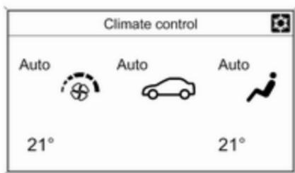
Vsaka sprememba nastavitev je prikazana na informacijskem prikazovalniku za nekaj sekund. Primerno delovanje elektronske klimatske naprave je zagotovljeno le pri obratujočem motorju.
