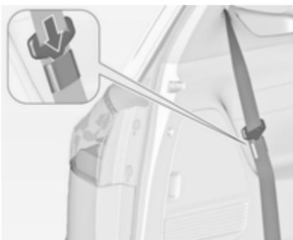
Ko varnostnih pasov ne uporabljate ali pa zlagate sedeže, vstavite zaskočno ploščo varnostnega pasu na obeh straneh v žep, ki je nameščen na pasu.
