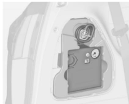
Če je vozilo opremljeno s kompletom za popravilo pnevmatik, odstranite celotno škatlo.
