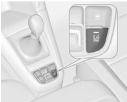
Sistem za opozorilo o nenamerni menjavi vozneg pasu se aktivira s pritiskom gumba . LED v stikalniku označuje, da je sistem vključen. Kadar kontrolna lučka na instrumentni tabli sveti zeleno, je sistem pripravljen na delovanje.
