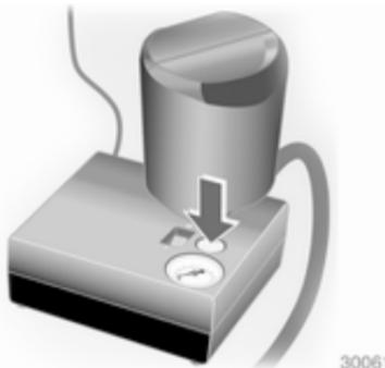
Če predpisani tlak ni dosežen v roku 10-ih minut, odstranite komplet za popravilo pnevmatik. Premaknite vozilo za en obrat kolesa. Ponovno priklopite komplet za popravilo pnevmatik in nadaljujte s postopkom polnjenja pnevmatike še dodatnih 10 minut. Če predpisani tlak tudi po naknadnih 10-ih minutah ni dosežen, je pnevmatika preveč poškodovana. Poiščite strokovno pomoč v servisni delavnici.
