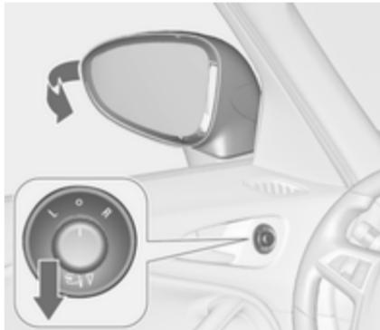
Obrnite stikalo v **0**, nato pritisnite stikalo navzdol. Obe zunanji ogledali se preklopita.
