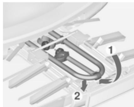
Preklopite nosilec nazaj, nato ga potisnite naprej do naslona (1). Pritisnite nosilec v zadnjem delu navzdol (2).
