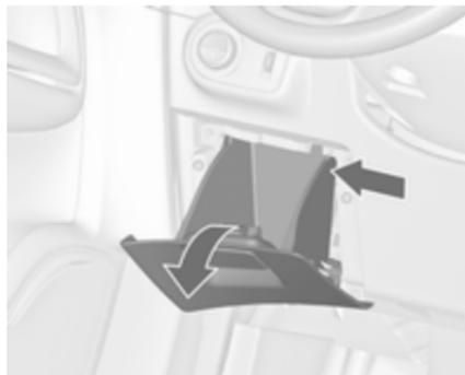
V modelih z volanom na desni: škatla varovalk se nahaja za prostorom za spravljanje v armaturni plošči.
