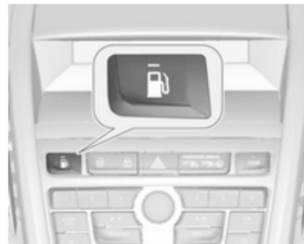
S pritiskom gumba
