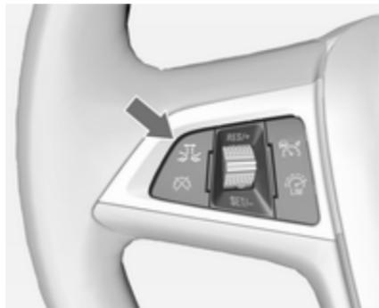
Pritisnite gumb . Trenutna nastavitev se prikaže na informacijskem centru voznika. Znova pritisnite gumb , da spremenite razdaljo sledenja.
