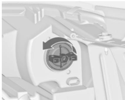
1. Držalo žarnice (3) obrnite v obratno smer urinega kazalca. Izvlecite držalo žarnice iz žarometu.
