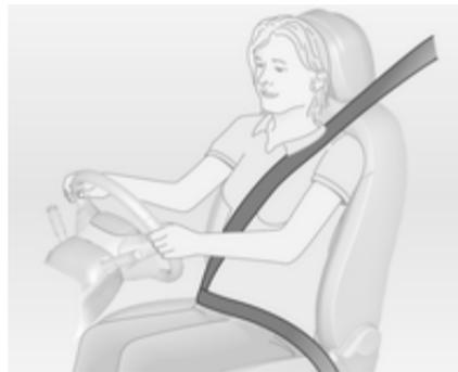
Izvalcite varnostni pas in ga zataknete v zaklep. Bočni del pasu ne sme biti zviti na nobenem delu in se mora tesno prilagati k telesu. Naslonjalo naj ne bo nagnjeno preveč nazaj (priporočen kot nagiba: največ 25°).
