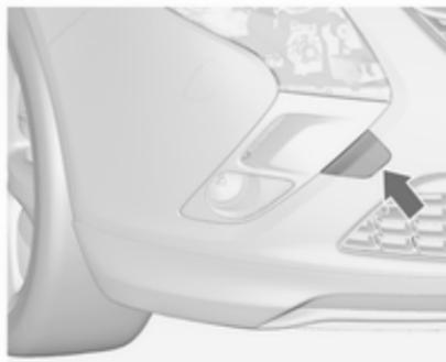
Vstavite izvijač v kratki rob pokrova. Odpnite pokrov s previdnim pomikom izvijača v stran. Za zaščito vstavite med izvijač in okvir mehko krpo.
