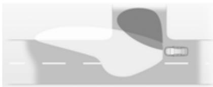
V ozkih ulicah, na križiščih ali pri zavijanju s ceste se v odvisnosti od kota volana in/ali vklopa smernika vklopi dodaten žaromet, ki osvetli cesto v pravem kotu v zeleni smeri vožnje. Funkcija deluje le pod hitrostjo 40 km/h.
