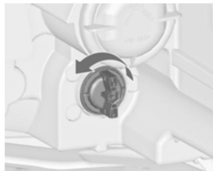
1. Držalo žarnice (2) obrnite v obratno smer urinega kazalca. Izvlecite držalo žarnice iz žarometa.
