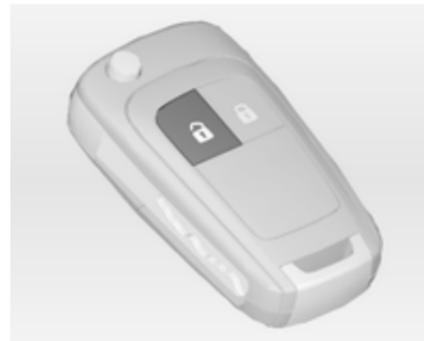
V ta namen pritisnite pri izključenem kontaktu tipko
