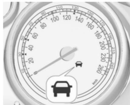
V merilniku hitrosti se prižge zeleni simbol za spredaj vozeče vozilo 🚗, če je sistem zaznal vozilo v smeri vožnje pred vami. Predpogoj za to je, da je v meniju za osebne nastavitve vozila vključeno opozorilo za trk spredaj ↷ 129 ali da funkcija ni bila izključena s tipko ⌘ (odvisno od sistema, glejte nadaljevanje).
