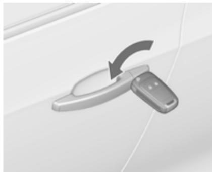
Odklenite voznikova vrata z obratom ključa v ključavnici. Vključite kontakt in pritisnite stikalo
