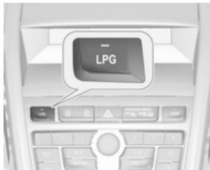
S pritiskom na gumb **LPG** preklapljate med pogonom na bencin in pogonom na utekočinjen naftni plin. Stanje LED-lučk
