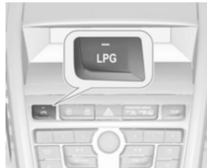
Po pritisku na tipko **LPG** se preklop med bencinskim in plinskim pogonom izvrši, takoj ko so izpolnjeni zahtevani pogoji (temperatura hladilne tekočine, temperatura plina in
