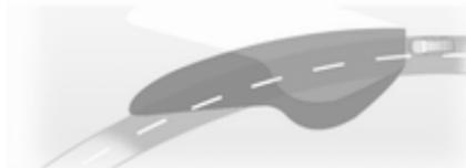
Zglobi žarometov se obračajo v odvisnosti od zavoja volana in hitrosti vozila za boljšo osvetlitev zavojev.
