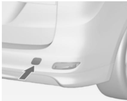
Vstavite izvijač v spodnji rob pokrova. Odpnite pokrov s previdnim pomikom izvijača navzdol. Za zaščito vstavite med izvijač in okvir mehko krpo.
