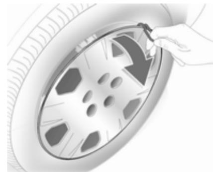
1. Pokrove vijakov odstranite s pomočjo izvijača. S kavljem iztaknite in snemite okrasni pokrov kolesa. Orodje vozila ↪ 241.
