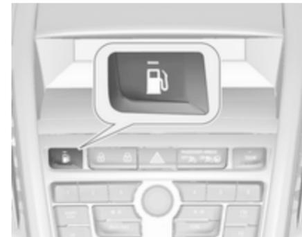
S pritiskom na gumb
