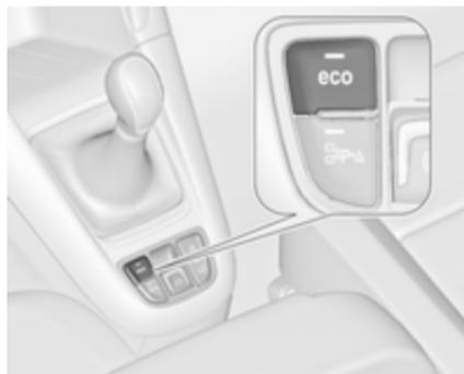
Start-stop sistem lahko ročno izklopite s pritiskom na tipko **eco**. Izklop signalizira ugasnjen LED indikator v stikalu.
