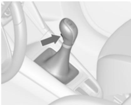
Vzvratna prestava: ko vozilo miruje, pritisnite pedal sklopke, pritisnite gumb na prestavnih ročicah in prestavite.
