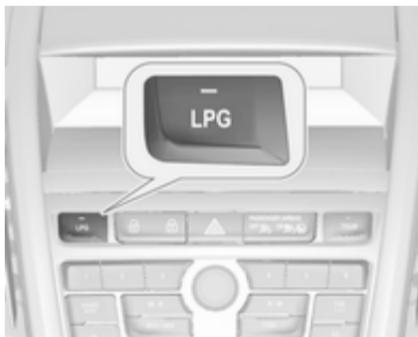
Po pritisku **LPG** se preklop med bencinskim in plinskim pogonom izvrši, takoj ko so izpolnjeni zahtevani pogoji (temperatura hladilne tekočine, temperatura plina in minimalno število vrtljajev motorja). Ti pogoji so običajno izpolnjeni po približno 60 sekundah (odvisno od zunanjih temperature) in prvem odločnejšem pritisku na pedal za plin. Stanje LED lučk opozarja na trenutni način delovanja.
