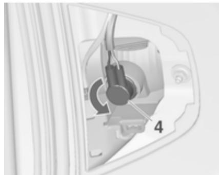
2. Nosilec žarnice odvijte v nasprotno smer urinega kazalca in ga odstranite iz žarometa.
