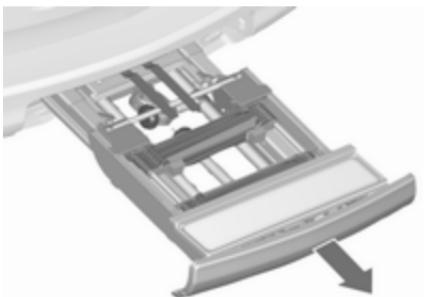
Potegnite zadnji nosilec do konca navzven, da se zaskoči.
