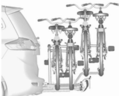
Nosilec na zadku vozila (Flex-Fix sistem) omogoča nameščanje dveh koles na raztegljiv nosilec, ki je vgrajen v podvozju. Adapter omogoča pritrditve dveh dodatnih koles. Prevoz drugih stvari ni priporočljiv.
