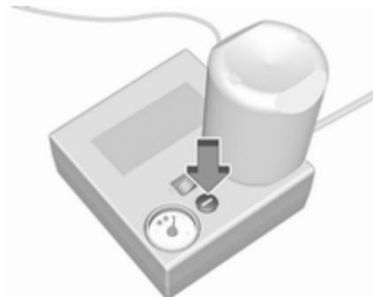
Če predpisani tlak ni dosežen v roku 10-ih minut, odstranite komplet za popravilo pnevmatik. Premaknite vozilo za en obrat kolesa. Ponovno priklopite komplet za popravilo pnevmatik in nadaljujte s postopkom polnjenja pnevmatike še dodatnih 10 minut.
