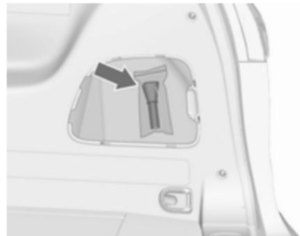
Za to namenjen lijak je v prostoru za spravljanje na desni strani prtljažnika. Lijak uporabite za dolivanje motornega olja v odprtino za motorno olje.
