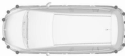
Napredni parkirni pomočnik vodi voznika na parkirno mesto z navodili na voznikovem informacijskem zaslonu in zvočnim signaliziranjem. Voznik mora sam upravljati s plinom, zavorami in menjalnikom.
