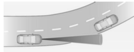
Adaptivni tempomat izračuna predvideno pot na osnovi centrifugalne sile. Ta predvidena pot upošteva značilnosti trenutnega zavoja, vendar pa ne more upoštevati spremembe zavoja v prihodnje. Sistem lahko izgubi vozilo pred vami ali upošteva vozilo ki ni na vašem vozнем pasu. To se lahko zgodi ob vstopu v zavoj ali izstopu iz njega ali če zavoj postane bolj ali manj oster. Če sistem več ne zaznava spredaj vočevega vozila, kontrolna lučka 🚗 ugasne.
