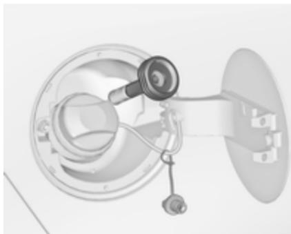
**Adapter ACME:** Privijte matico točilne pištole na adapter. Pritisnite navzdol varovalno ročico na točilni pištolji.
