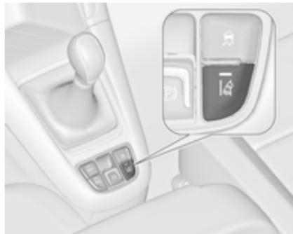
Sistem za opozorilo o nenamerni menjavi vozneg pasu se aktivira s pritiskom . LED v stikalju označuje, da je sistem vključen. Kadar kontrolna lučka na instrumentni tabli sveti zeleno, je sistem pripravljen na delovanje.
