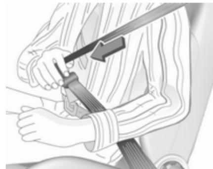
Enakomerno potegnite pas iz navjalca, ga nezvitega namestite čez telo in vstavite zaponko v zaklep, da se slišno zaskoči. Med vožnjo si pas na diagonalnem delu večkrat zategnjte.
