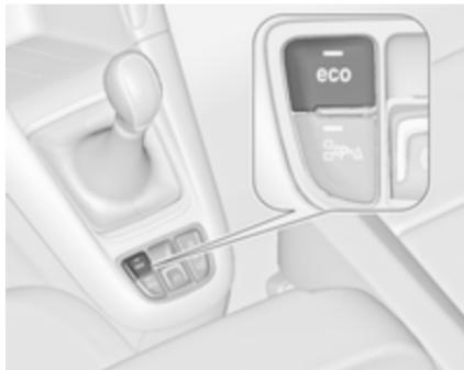
Start-stop sistem lahko ročno izklopite s pritiskom **eco**. Izklop signalizira ugasnjen LED indikator na stikalu.
