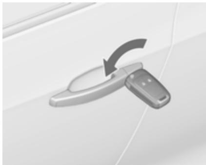
Odklenite voznikova vrata z obratom ključa v ključavnici. Vključite kontakt in pritisnite za odklepanje vseh vrat, prtljažnika in lopute rezervoarja goriva. Ob izklopu kontakta za vžig se izklopi varovalni zaklep proti kraji.
