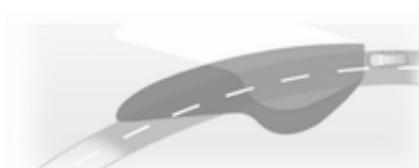
Zglobi žarometov se obračajo v odvisnosti od zavoja volana in hitrosti vozila za boljšo osvetlitev zavojev. Kontrolna lučka ☰ ▷ 119.
