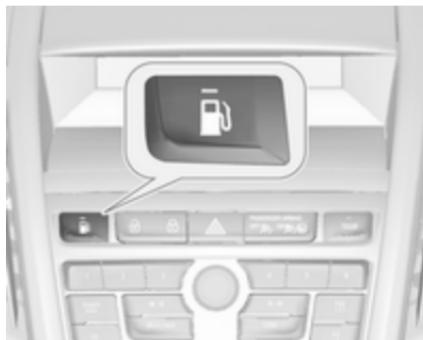
Pritisnite za preklapljanje med pogonom na bencin in pogonom na zemeljski plin. Preklop ni mogoče med veliko obremenitvijo motorja (npr. močno pospeševanje, vožnja s polnim plinom). Stanje LED lučk opozarja na trenutni način delovanja.
