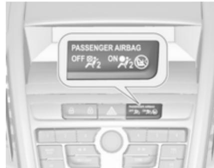
Če sveti kontrolna lučka ON (VKLOP)<sup>2</sup> približno 60 sekund po vključitvi kontakta vžiga, je sistem varnostnih blazin na sovoznikovi strani pripravljen za sprožitev.
