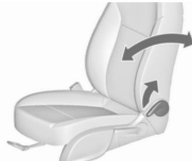
Potegnite vzvod, nastavite naklon in sprostite vzvod. Sedežno naslonjalo naj se primerno zaskoči.
