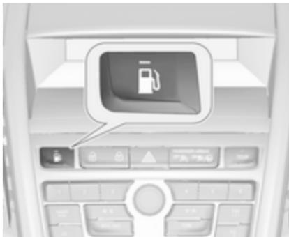
Pritisnite za preklapljanje med pogonom na bencin in pogonom na zemeljski plin. Preklop ni mogoče med veliko obremenitvijo motorja (močno pospeševanje, vožnja s polnim plinom). Stanje LED lučk opozarja na trenutni način delovanja.
