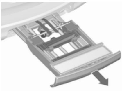
Potegnite zadnji nosilec do konca navzven, da se zaskoči.
