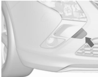
Vstavite izvijač v kratki rob pokrova. Odpnite pokrov s previdnim pomikom izvijača vstran. Za zaščito vstavite med izvijač in okvir mehko krpo.
