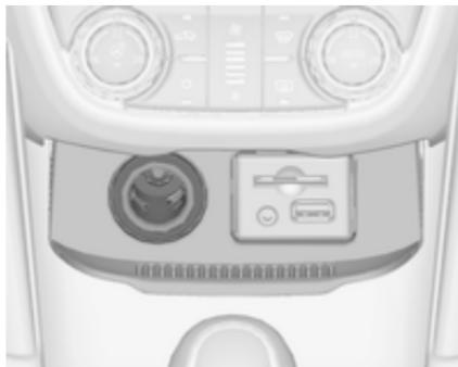
12-voltna električna vtičnica se nahaja v sprednji konzoli. Pokrov preklopite navzdol.
