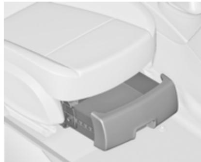
Pritisnite gumb v odprtini in izvlecite predal. Maksimalna nosilnost: 3 kg. Zapiranje predala: potisnite ga pod sedež, da se zatakne.
