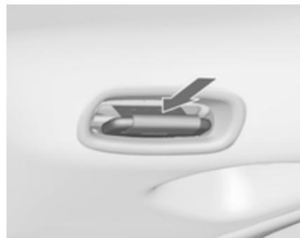
Pas z zaponkama, obrnjenima proti odprtini, vstavite v držalo v stropni prevleki.
