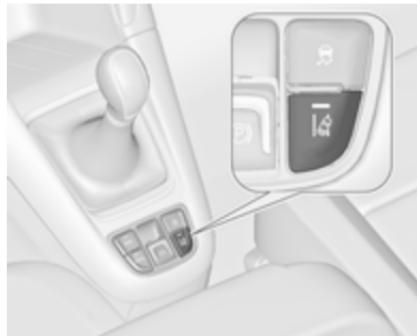
Sistem za opozorilo o nenamerni menjavi voznega pasu se aktivira s pritiskom . LED v stikalni označuje, da je sistem vključen. Kadar kontrolna lučka na instrumentni tabli sveti zeleno, je sistem pripravljen na delovanje.
