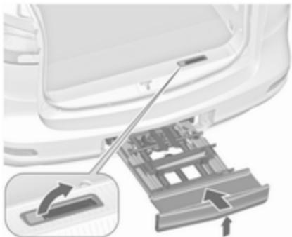
Povlecite zaklepni vzvod navzgor. Sistem nosilca na zadku vozila rahlo dvignite in ga potisnite v odbijač, da se zaskoči.
