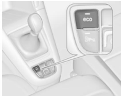
Start-stop sistem lahko ročno izklopite s pritiskom **eco**. LED dioda v gumbu ugasne in s tem označuje izključeno stanje.
