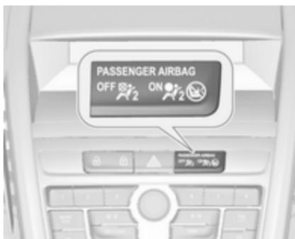
Če sveti kontrolna lučka ON (VKLOP) približno 60 sekund po vključitvi kontakta vžiga, je sistem varnostnih blazin na sovoznikovi strani pripravljen za sprožitev.
