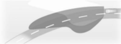
Zgubi žarometov se obračajo v odvisnosti od zavoja volana in hitrosti vozila za boljšo osvetlitev zavojev. Kontrolna lučka ⇨ ⇨ 118.
