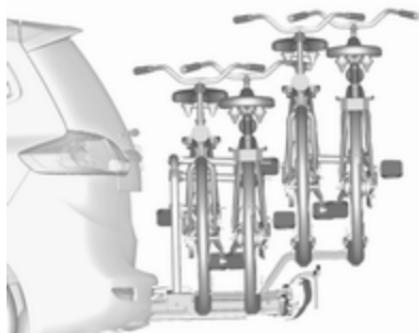
Nosilec na zadku vozila (Flex-Fix sistem) omogoča nameščanje dveh koles na raztegljiv nosilec, ki je vgrajen v podvozju. Adapter omogoča pritrditev dveh dodatnih koles. Prevoz drugih stvari ni priporočljiv.
