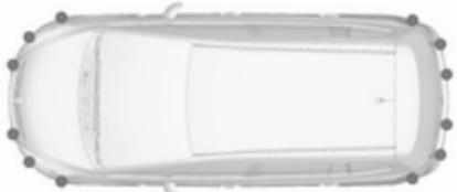
Napredni parkirni pomočnik vodi voznika na parkirno mesto z navodili na vozniškem informacijskem zaslonu in z zvočnim signaliziranjem. Voznik mora sam upravljati s plinom, zavorami in menjalnikom.
