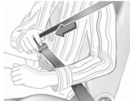
Enakomerno potegnite pas iz navjalca, ga nezvitega namestite čez telo in vstavite zaponko v zaklep, da
