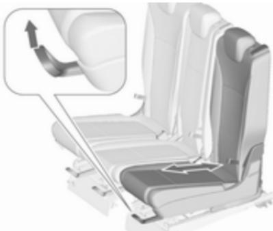
Privzdignite ročico, pomaknite sedež v želeni položaj, spustite ročico in pustite, da se sedež zaskoči.
