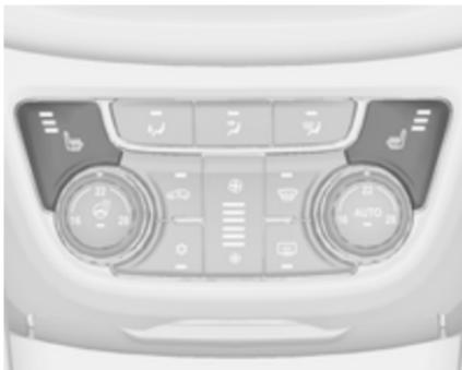
Nastavite želeno stopnjo ogrevanja s pritiskom na enkrat ali večkrat. Indikator v stikalnu označuje nastavitev.
