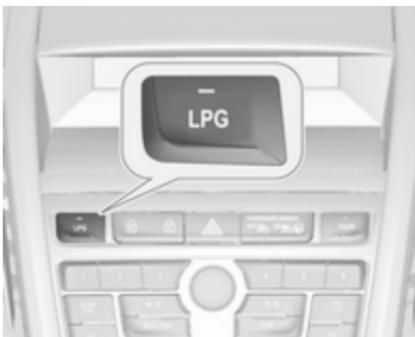
Po pritisku **LPG** se preklop med bencinskim in plinskim pogonom izvrši, takoj ko so izpolnjeni zahtevani pogoji (temperatura hladilne tekočine, temperatura plina in minimalno število vrtljajev motorja). Ti pogoji so običajno izpolnjeni po približno 60 sekundah (odvisno od zunanjega temperature) in prvem
