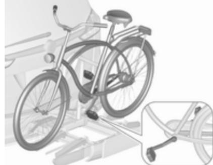
1. Obrnite pedala v položaj, ki je prikazan na sliki, in postavite kolo v prvo podporo za kolo.
