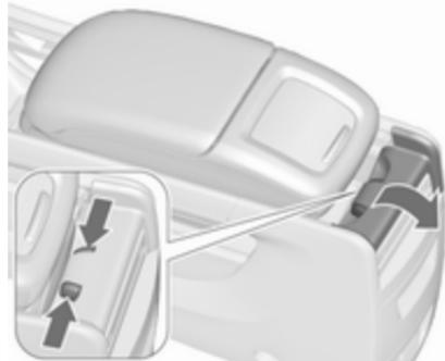
Pritrdilne elemente potisnite navznoter in prepognite navzdol zaklepni mehanizem v zadnjem delu naslona za roko.
