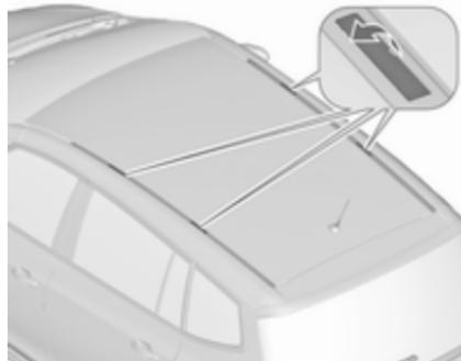
Za namestitev strešnega prtljažnika odprite pokrove v stranskih vodilih na strehi. Vstavite namestitvene adapterje v nosilce, kot je prikazano na sliki.
