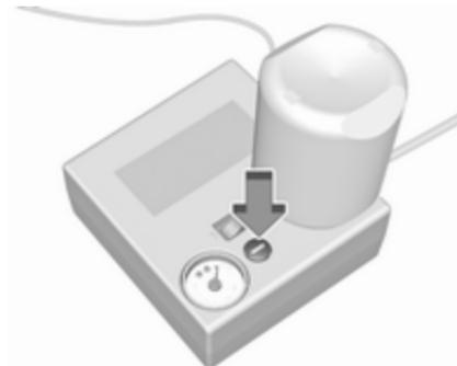
Če predpisani tlak ni dosežen v roku desetih minut, odstranite komplet za popravilo pnevmatik. Premaknite vozilo za en obrat kolesa. Ponovno priklopite komplet za popravilo pnevmatik in nadaljujte s postopkom polnjenja pnevmatike še dodatnih deset
