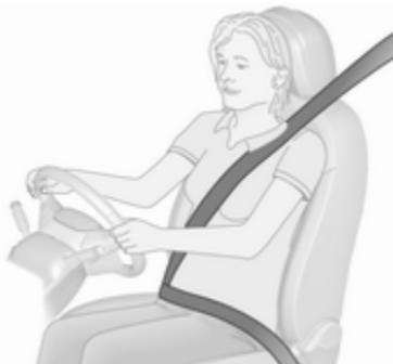
Izvlecite varnostni pas in ga zataknite v zaklep. Bočni del pasu ne sme biti zvit na nobenem delu in se mora tesno prilegati k telesu. Naslonjalo naj ne bo nagnjeno preveč nazaj (priporočen kot nagiba: največ 25°). Pas odpnete s pritiskom na rdeč gumb na zaklepu.
