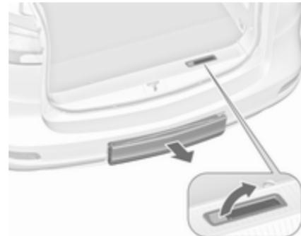
Potegnite zaklepni vzvod navzgor. Nosilec na zadku vozila se sprosti in izskoči iz zadnjega odbijača.
