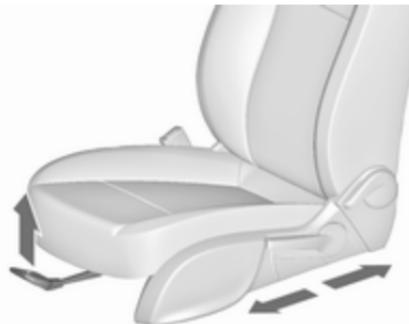
Potegnite ročico, pomaknite sedež, sprostite ročico. Poskusite premakniti sedež nazaj in naprej in se tako prepričajte, da je sedež zavarovan v izbranem položaju.
