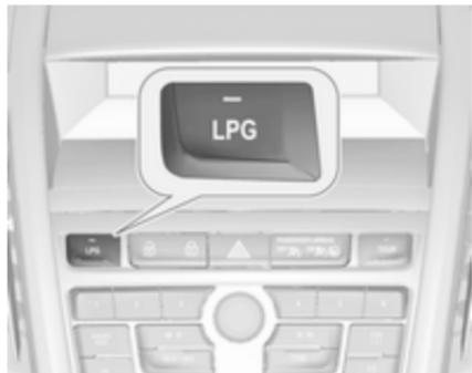
Pritisnite **LPG** za preklapljanje med pogonom na bencin in pogonom na utekočinjen naftni plin. Stanje LED-lučk
