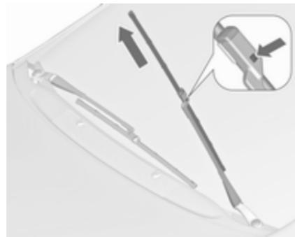
Dvignite roko brisalca, dokler ne ostane dvignjena, pritisnite gumb za sprostitev metlice in jo odstranite.
