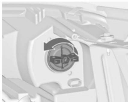
1. Držalo žarnice (3) obrnite v obratno smer urinega kazalca. Izvlecite držalo žarnice iz žarometa.
