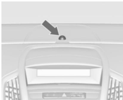
Varnostni LED indikator je vgrajen v senzor na armaturni plošči.
