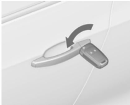
Odklenite voznikova vrata z obratom ključa v ključavnici. Vključite kontakt in pritisnite za odklepanje vseh vrat, prtljažnika in lopute rezervoarja goriva. Ob vklopu kontakta za vžig se izklopi varovalni zaklep proti kraji.
