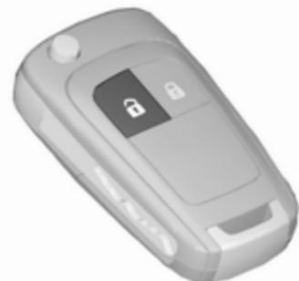
V ta namen pri izključenem kontaktu pritisnite . Vrata prtljažnika se odklenejo in jih lahko odprete z dotikom tipke pod prijemkom na vratih.
