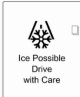
Če se zunanja temperatura zniža na 3 °C, se na kombiniranem voznikovem informacijskem zaslonu višje stopnje prikaže opozorilo.
