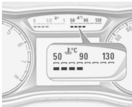
Število vklopljenih indikatorjev LED prikazuje temperaturo hladilne tekočine.
