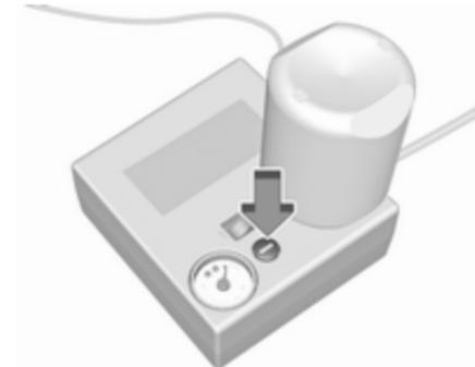
Če predpisan tlak ni dosežen v roku desetih minut, odstranite komplet za popravilo pnevmatik. Premaknite vozilo za en obrat kolesa. Ponovno priključite komplet za popravilo pnevmatik in nadaljujte s postopkom polnjenja pnevmatike še dodatnih deset
