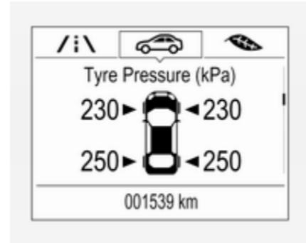
6. Za začetek postopka usklajevanja položajev senzorjev pritisnite **SET/CLR**. Prikazati se mora sporočilo, ki zahteva odobritev postopka.
