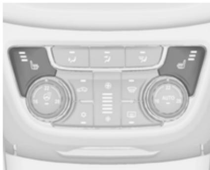
Nastavite želeno stopnjo ogrevanja s pritiskom na
