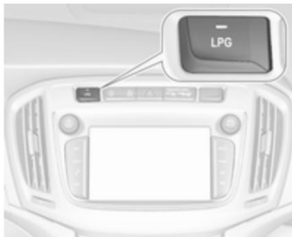
Po pritisku **LPG** se preklon med bencinskim in plinskim pogonom izvrši, takoj ko so izpolnjeni zahtevani pogoji (temperatura hladilne tekočine, temperatura plina in minimalno število vrtljajev motorja). Ti pogoji so običajno izpolnjeni po približno 60 sekundah (odvisno od zunanje temperature) in prvem
