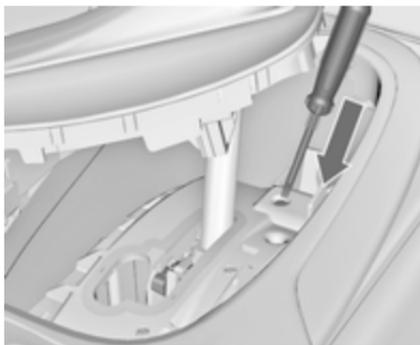
3. Potisnite navzdol sprostitveni ročaj in prestavite izbirno ročico iz **P** ali **N**. Če ponovno prestavite v ta položaja, se izbirna ročica ponovno zaklene. Vzrok prekinitve napajanja dajte nemudoma odpraviti strokovnjakom v servisni delavnici.
