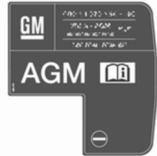
Akumulator AGM lahko prepoznate po identifikacijski nalepki. Priporočamo uporabo originalnega akumulatorja vozila Opel.
