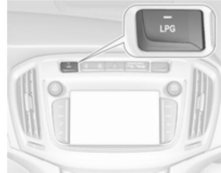
Pritisnite **LPG** za preklapljanje med pogonom na bencin in pogonom na utekočinjen naftni plin. Stanje LED-lučk
