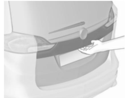
Za odpiranje vrat prtljažnika se dotaknite stikala pod vdolbino na vratih prtljažnika po odklepanju. Sistem centralnega zaklepanja ⇨ 23.
