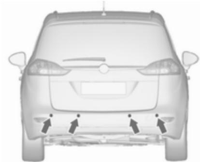
Sistem vsebuje štiri senzorje, vgrajene v zadnjem in sprednjem odbijaču.
