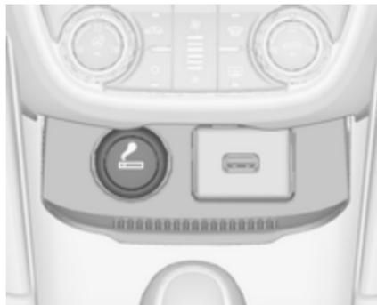
Vžigalnik se nahaja v sprednji konzoli. Pokrov preklonite navzdol.
