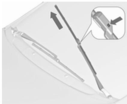
Dvignite roko brisalca, dokler ne ostane dvignjena, pritisnite gumb za sprostitve metlice in jo odstranite.
