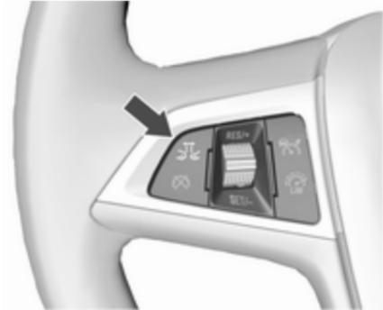
Pritisnite **RES/+**. Trenutna nastavev se prikaže na informacijskem centru voznika. Znova pritisnite **RES/+**, da spremenite razdaljo sledenja. Nastavev se prikaže tudi na voznikovem informacijski zaslonu.
