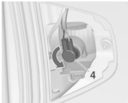
2. Nosilec žarnice odvijte v nasprotno smer urinega kazalca in ga odstranite iz žarometu.
