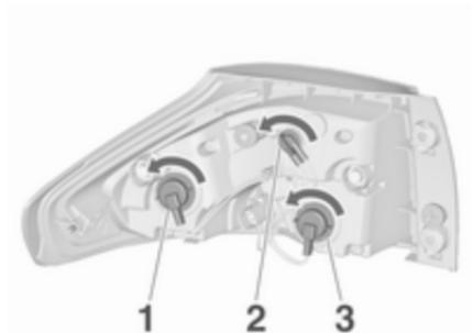
5. Odstranite in zamenjajte žarnico z obračanjem držala žarnice.
