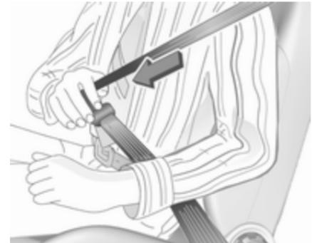
Enakomerno potegnite pas iz navijalca, ga nezvitega namestite čez telo in vstavite zaponko v zaklep, da
