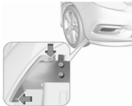
1. Odstranite zunanje vijake pokrova, kot je prikazano na ilustraciji.
