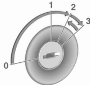
Obrnite ključ v položaj **1**, da se sprosti zaklep volana.
