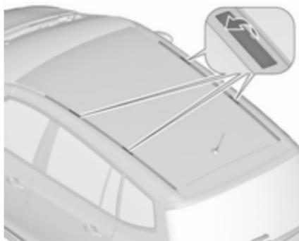
Za namestitev strešnega prtljažnika odprite pokrove v stranskih vodilih na strehi. Vstavite namestitvene adapterje v nosilce, kot je prikazano na sliki.
