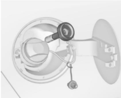
**Adapter ACME:** Privijte matico točilne pištrole na adapter. Pritisnite navzdol varovalno ročico na točilni pištoli.
