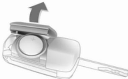
Pritisnite gumb, da izskoči ključeva brada in odprite ključ. Zamenjajte baterijo (tip baterije CR 2032). Pazite na pravilno vstavitve nove baterije. Zaprite daljinski upravljalnik in ga sinhronizirajte.
