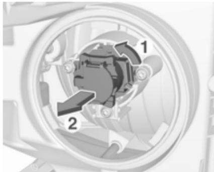
2. Nosilec žarnice obrnite v obratno smer urinega kazalca. Izvlecite držalo žarnice iz ohišja žarometu.
