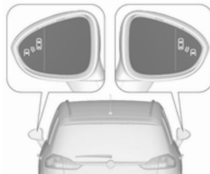
Opozorilo na stransko slepo točko deluje od hitrosti 10 km/h do hitrosti 140 km/h. Pri hitrejši vožnji od 140 km/h se sistem izklopi, kar je označeno z vklopom opozorilnih simbolov <sup>a</sup><sub>b</sub> z nizko jakostjo v obeh zunanjih ogledalih. Če znova znižate hitrost pod to zgornjo mejo, opozorilna simbola ugasneta. Če sistem potem zazna vozilo v mrtvem kotu, se prižge opozorilni simbol <sup>a</sup><sub>b</sub> za ustrežno stran kot običajno.
