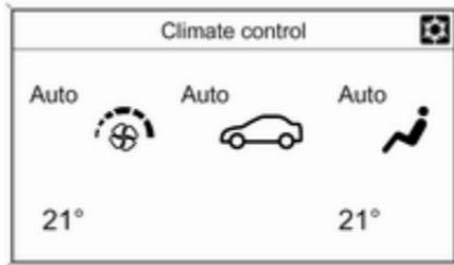
Nastavitve klimatske naprave so prikazane na informacijskem zaslonu. Spremenjene nastavitve se za hip pojavijo na zaslonu preko trenutno dejavnega menija.
