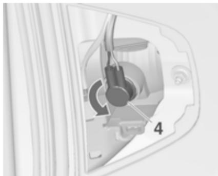
2. Nosilec žarnice odvijte v nasprotno smer urinega kazalca in ga odstranite iz žaromet.
