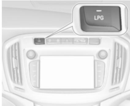
Po pritisku **LPG** se preklon med bencinskim in plinskim pogonom izvrši, takoj ko so izpolnjeni zahtevani pogoji (temperatura hladilne tekočine, temperatura plina in
