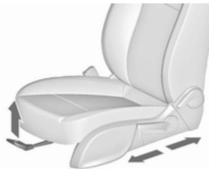
Potegnite ročico, pomaknite sedež, sprostite ročico. Poskusite premakniti sedež nazaj in naprej in se tako prepričajte, da je sedež zavarovan v izbranem položaju.
