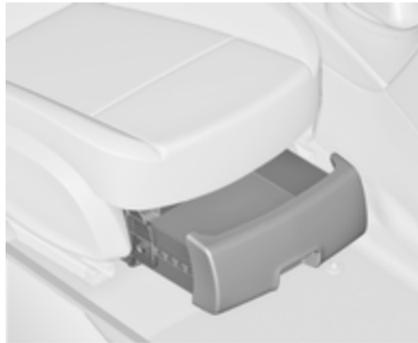
Pritisnite gumb v odprtini in izvlcite predal. Maksimalna nosilnost: 3 kg. Zapiranje predala: potisnite ga pod sedež, da se zatakne.
