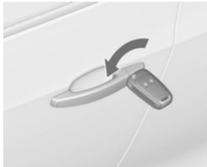
Odklenite voznikova vrata z obratom ključa v ključavnici. Vključite kontakt in pritisnite
