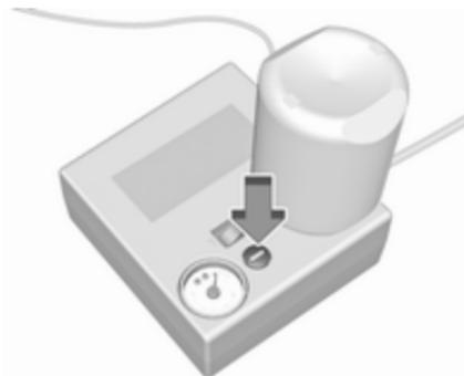
Če predpisan tlak ni dosežen v roku desetih minut, odstranite komplet za popravilo pnevmatik. Premaknite vozilo za en obrat kolesa. Ponovno priključite komplet za popravilo pnevmatik in nadaljujte s postopkom polnjenja pnevmatike še dodatnih deset
