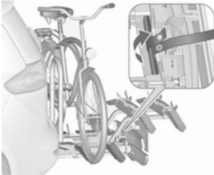
4. Napeljite trak, ki je pritrjen na adapterju, pod ročico za preklon nosilca na zadku vozila. Pritrdite trak.
