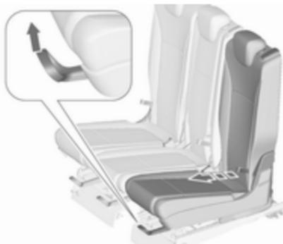
Ko v drugi vrsti sedežev uporabljate otroške varnostne sedeže z vpenjalnimi točkami ISOFIX, vam priporočamo, da ustrezni zunanji sedež namestite v tretji zaskočni položaj od zadaj, glede na osnovni sedež. Če je opremljen počivalni sedež, mora biti v normalnem položaju ⇨ 44.
