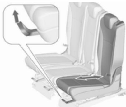
Privzdignite ročico, pomaknite sedež v zeleni položaj, spustite ročico in pustite, da se sedež zaskoči.
