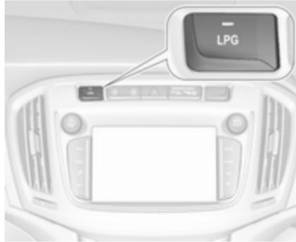
Pritisnite **LPG** za preklapljanje med pogonom na bencin in pogonom na utekočinjen naftni plin. Stanje LED-lučk
