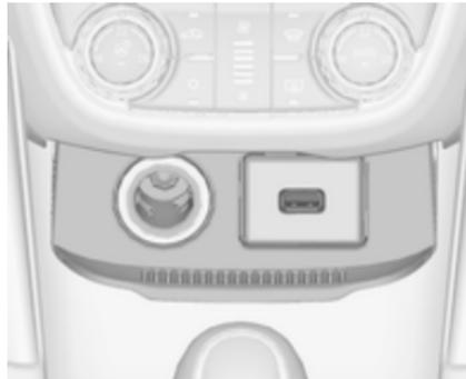
12-voltna električna vtičnica se nahaja v sprednji konzoli. Pokrov preklonite navzdol.
