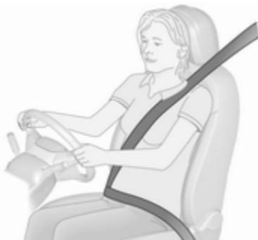
Izvlomite varnostni pas in ga zataknete v zaklep. Bočni del pasu ne sme biti zviti na nobenem delu in se mora tesno prilagati k telesu. Naslonjalo naj ne bo nagnjeno preveč nazaj (priporočen kot nagiba: največ 25°).
