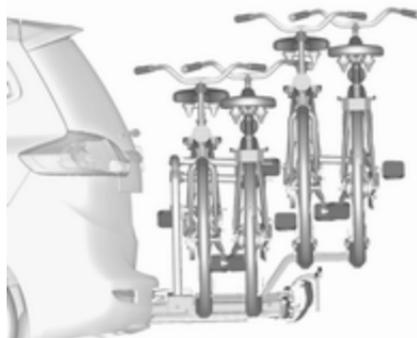
Nosilec na zadku vozila (sistem Flex-Fix) omogoča nameščanje dveh koles na raztegljivi nosilec, ki je vgrajen v dno vozila. Adapter omogoča pritrnitev dveh dodatnih koles. Prevoz drugih stvari ni priporočljiv.
