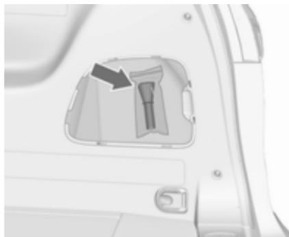
Za to namenjen lijak je v prostoru za spravljanje na desni strani prtljažnika. Lijak uporabite za dolivanje motornega olja v odprtino za motorno olje.
