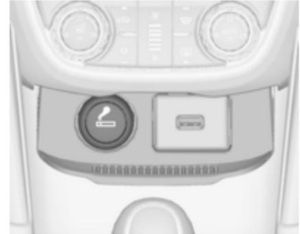
Vžigalnik se nahaja v sprednji konzoli. Pokrov preklonite navzdol.
