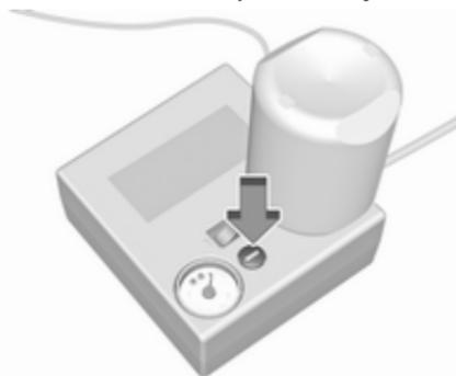
Če predpisan tlak ni dosežen v roku desetih minut, odstranite komplet za popravilo pnevmatik. Premaknite vozilo za en obrat kolesa. Ponovno priklopite komplet za popravilo pnevmatik in nadaljujte s postopkom polnjenja pnevmatike še dodatnih deset minut. Če predpisan tlak tudi po naknadnih 10-ih minutah ni dosežen, je pnevmatika preveč poškodovana. Poiščite strokovno pomoč v servisni delavnici.
