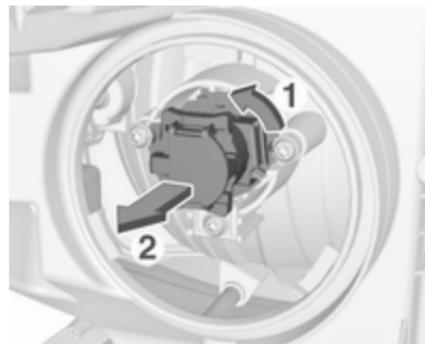
2. Nosilec žarnice obrnite v obratno smer urinega kazalca. Izvlecite držalo žarnice iz ohišja žaromet.
