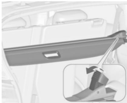
Odmaknite (odkrijte) prekrivalo prtljažnika. Potegnite zaklepni vzvod navzgor. Dvignite desno stran prekrivala tovornega prostora in ga izvlecite iz vodila.
