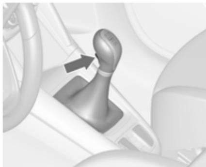
Vzratna prestava: ko vozilo miruje, pritisnite pedal sklopke, pritisnite gumb na prestavni ročici in prestavite.
