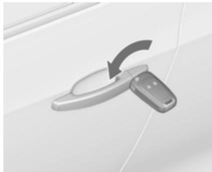
Odklenite voznikova vrata z obratom ključa v ključavnici. Vključite kontakt in pritisnite
