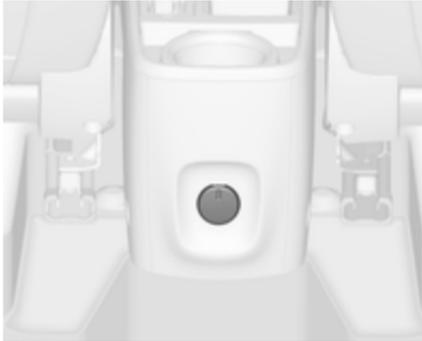
Dodatne 12-voltno električne vtičnice so v zadnji konzoli
