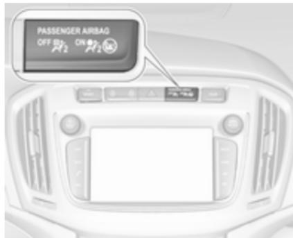
Če sveti kontrolna lučka ON (VKLOP)
