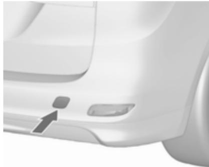
Okoli konice ploskega izvijača ovijte krpo, da preprečite poškodbo laka. Vstavite izvijač v spodnji rob pokrova. Odpnite pokrov s previdnim pomikom izvijača navzdol. Za zaščito vstavite med izvijač in okvir mehko krpo.
