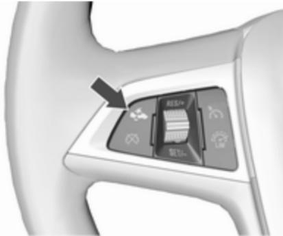
Pritisnite . Trenutna nastavev se prikaže na voznikovem informacijskem zaslonu. Za spremembo občutljivosti opozorila znova pritisnite .
