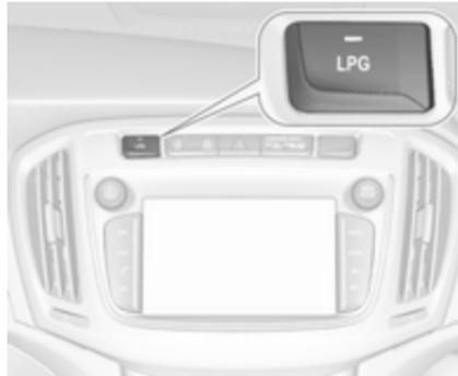
Po pritisku **LPG** se preklon med bencinskim in plinskim pogonom izvrši, takoj ko so izpolnjeni zahtevani pogoji (temperatura hladilne tekočine, temperatura plina in minimalno število vrtljajev motorja). Ti pogoji so običajno izpolnjeni po približno 60 sekundah (odvisno od zunanje temperature) in prvem odločnejšem pritisku na pedal za plin. Lučka LED za stanje kaže trenutni način delovanja.
