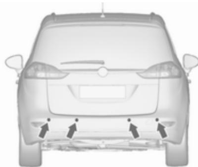
Sistem vsebuje štiri senzorje, vgrajene v zadnjem in sprednjem odbijaču.
