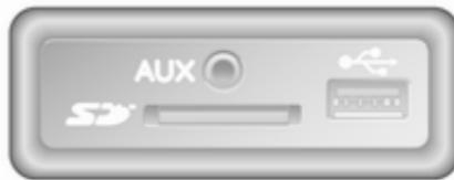
U zavisnosti od verzije, na Infotainment uređaju (ili na instrument tabli) postoji USB utičnica  $\Psi$  za povezivanje spoljašnjih audio izvora.
