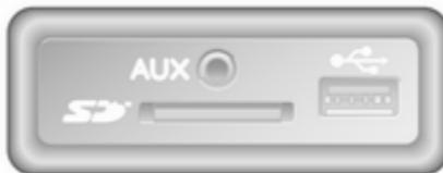
U zavisnosti od verzije, na Infotainment uređaju (ili na instrument tabli) postoji AUX utičnica za povezivanje spoljašnjih audio izvora.
