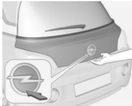
Щоб відімкнути й відкрити двері багажного відділення, натисніть на нижню частину фірмового логотипу.
