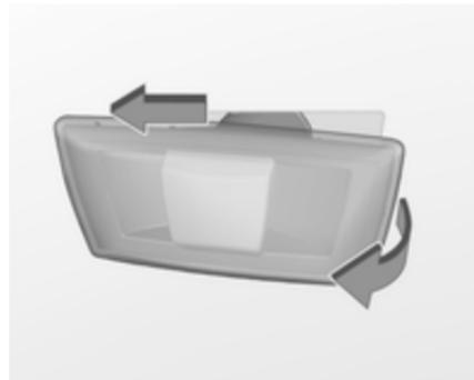
1. На лівому боці автомобіля посуньте лампу вперед і витягніть її з крила за задню частину.
