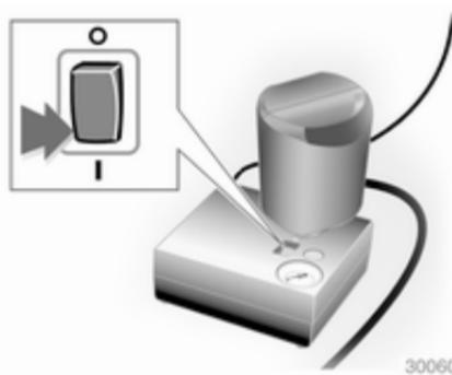
10. Установіть кулісний перемикач на компресорі в положення **I**. Шина наповнюється ущільнювачем.
