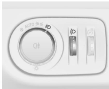
Щоб налаштувати діапазон освітлення фарами відповідно до навантаження автомобіля і запобігти засліпленню, виконайте такі дії: поверніть колесо регулятора
