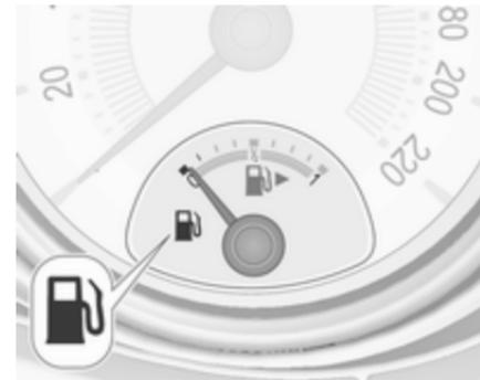
Цей датчик відображує інформацію про рівень палива або газу в баку, залежно від робочого режиму.
