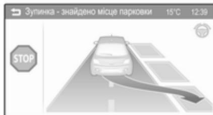
Якщо водій не зупинить автомобіль в межах 10 метрів для паралельного паркування або 6 метрів для перпендикулярного паркування після пропонування відповідного місця, система розпочне місце іншого підходящого місця.
