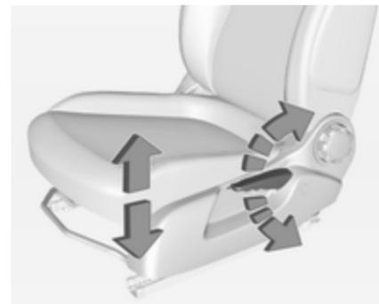
Хід накачування важеля угору = сидіння вище донизу = сидіння нижче
