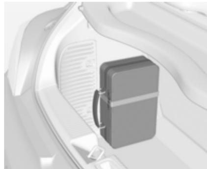
У моделях із задньою системою кріплення або двигуном на зрідженому газі комплект для ремонту шин розміщений у сумці й закріплений ремінцем на лівій стінці в багажнику.
