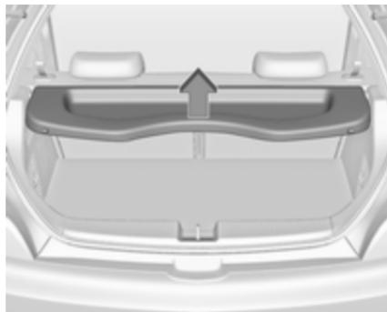
Підніміть покриття з заднього кінця. Воно фіксується майже у вертикальному положенні. Можна також відкривати його і далі - аж до підголівників. Щоб закрити кришку, опустіть її нижче місця фіксації.
