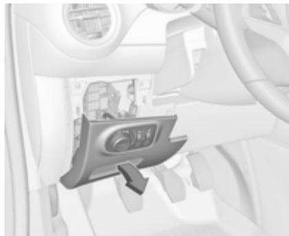
В автомобілях із лівостороннім керуванням коробка запобіжників знаходиться за вимикачем освітлення на панелі приладів.
