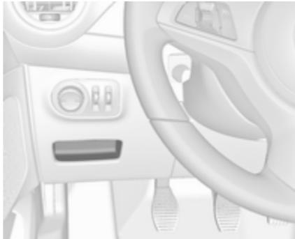
Відділення для зберігання знаходяться під вимикачем світла, на центральній консолі перед важелем селектора, а також на дверцятах (кишені) і на бокових панелях поруч із задніми сидіннями.
