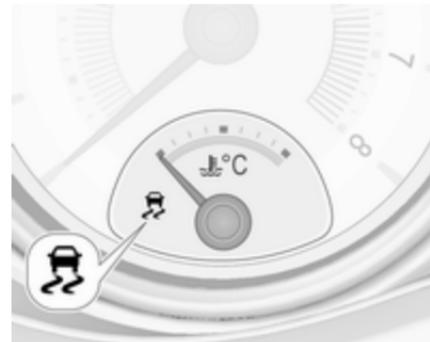
Система ТС готова до роботи після кожного запуску двигуна, щойно контрольний індикатор
