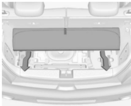
У моделях із коробкою для сабвуфера ремкомплект для шин розташований у скриньці під підлогою багажника. Для використання ремкомплекту шин спочатку зніміть підлогу - складіть задню частину вперед і витягніть покриття назад ↺ 70.
