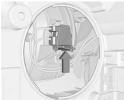
2. Натисніть хомут, щоб звільнити патрон лампи. Вийміть тримач лампи з рефлектора.
