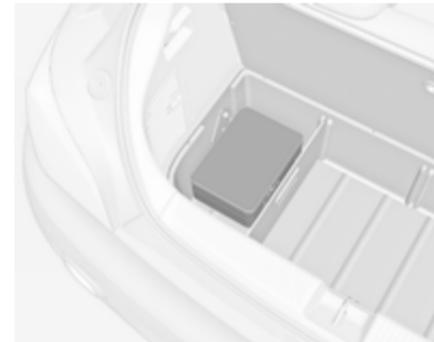
У моделях із коробкою для зберігання речей у багажнику сумка з комплектом для ремонту шин розміщена у відділенні цієї коробки ⇨ 69.
