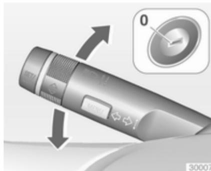
Під час паркування автомобіля можна ввімкнути ліхтарі стоянкового освітлення з одного боку:
