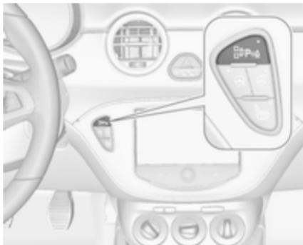
Під час пошуку місця для паркування система приводиться в робочий стан тривалим натисканням кнопки
