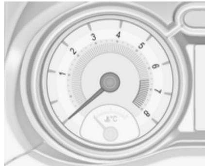
Вказує швидкість роботи двигуна. Їдьте на низьких обертах для кожної передачі настільки довго, наскільки це можливо.
