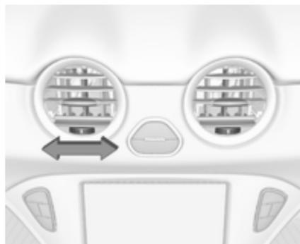
Відрегулюйте потік повітря, що надходить через повітропровід, повернувши колесо регулятора у потрібне положення. Вентиляційний отвір закривається, коли кільцятко регулятора повертається близько до лівого чи правого положення.
