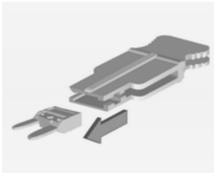
Установіть знімач запобіжника на різні типи запобіжників зверху та витягніть запобіжник.
