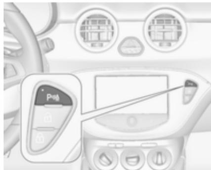
Система автоматично вимикається після вимкнення задньої передачі.
