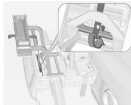
4. Проведіть ремінь, закріплений до адаптера, під важелем для складання задньої системи кріплення назад. Закріпіть ремінь.
