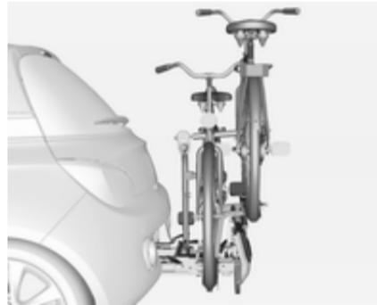
Задня система кріплення багажу (система Flex-Fix) дозволяє закріплювати один велосипед на витяжному тримачі, інтегрованому в полицю автомобіля. Можна закріплювати ще один велосипед на адаптері. Перевезення інших речей заборонено.
