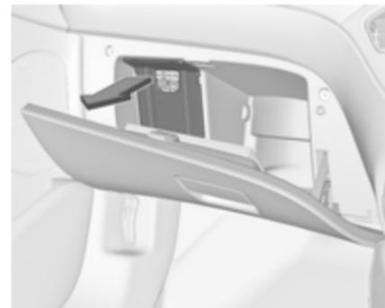
В автомобілях для правостороннього руху коробка запобіжників розташована за кришкою в бардачку. Відкрийте бардачок, після цього відкрийте кришку та складіть її.
