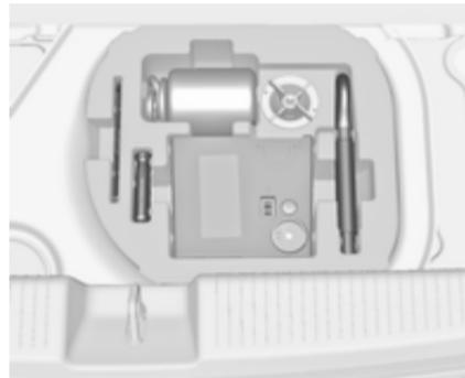
Деякі інструменти, а також буксирна провухина зберігаються разом із комплектом для ремонту шин у ящику для інструментів під килимком у багажному відділенні. У моделях з коробкою для зберігання речей потрібно спершу вийняти цю коробку ↪ 69.
