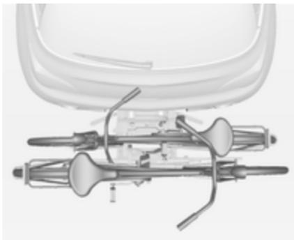
2. Розташуйте велосипеди на задній системі кріплення у шаховому порядку (рулем ліворуч - рулем праворуч).
