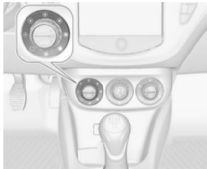
Повертайте лівий обертальний регулятор, щоб зменшити чи збільшити швидкість вентилятора. Швидкість вентилятора позначається на інформаційному дисплеї.
