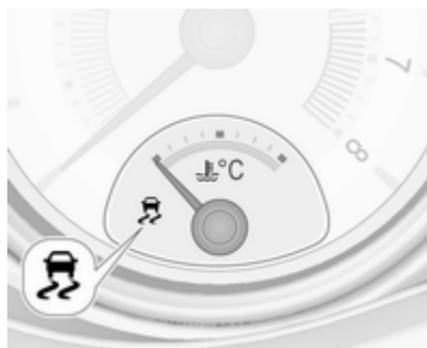
Система ESC готова до роботи після кожного запуску двигуна, щойно контрольний індикатор
