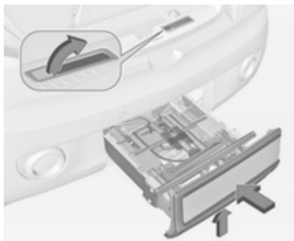
Штовхніть важіль розблокування вгору та утримуйте його в такому положенні. Злегка підніміть систему і посуňte її в бампер до фіксації.
