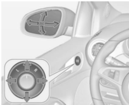
Виберіть потрібне зовнішнє дзеркало, повернувши регулятор ліворуч (**L**) або праворуч (**R**). Потім поверніть регулятор, щоб відрегулювати дзеркало.
