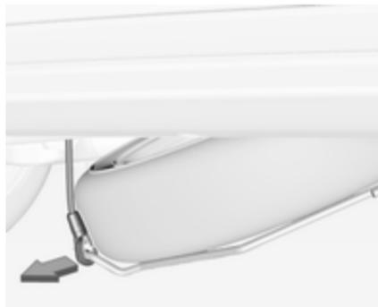
6. Трохи підніміть тримач запасного колеса вгору вручну і від'єднайте запобіжний кабель.
