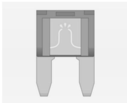
Залежно від типу запобіжника, запобіжник, що перегорів, можна розпізнати за розплавленим дротом. Не замінюйте запобіжник, доки не буде усунута причина несправності.
