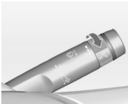
Поверніть колесо регулятора, щоб відрегулювати чутливість:
