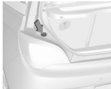
Закріпіть блок ліхтаря в заглибленнях на кузові кріпильними шпильками, а потім затягніть кріпильну гайку зсередини багажного відділення. Витягніть круглий ущільнювач через паз у корпусі лампи.
