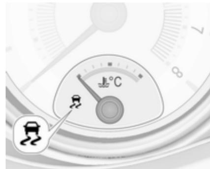
Система ТС готова до роботи після кожного запуску двигуна, щойно контрольний індикатор
