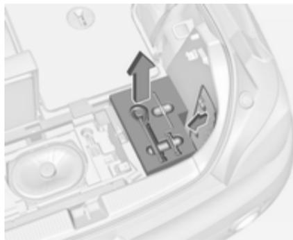
Щоб отримати доступ до відповідного покриття багажника, наприклад, для заміни ламп, складіть задню праву спинку і витягніть скриньку з інструментами, що розташована поруч із сабвуфером.
