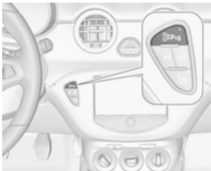
Під час пошуку місця для паркування система приводиться в робочий стан тривалим натисканням кнопки
