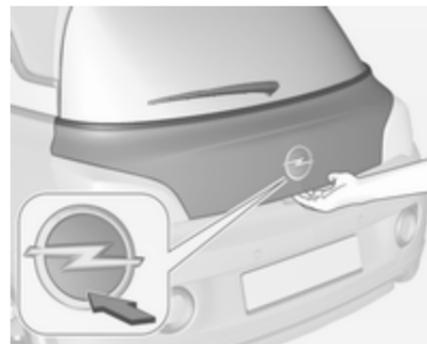
Щоб відчинити двері багажного відділення, натисніть на нижню частину фірмового логотипу.
