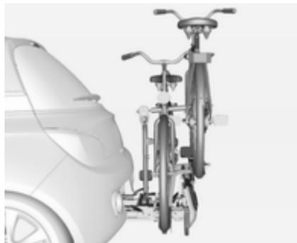
Задня система кріплення багажу (система Flex-Fix) дозволяє закріплювати один велосипед на витяжному тримачі, інтегрованому в полик автомобіля. Можна закріплювати ще один велосипед на адаптері. Перевезення інших речей заборонено.
