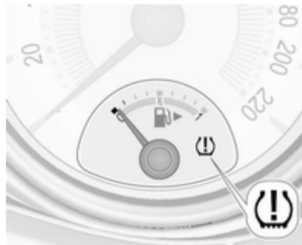
Розпізнавання стану тиску в шинах позначається контрольним індикатором (⚠) ⇨ 94.
