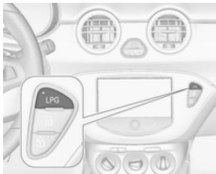
При натисканні кнопки **LPG**, робота автомобіля перемикається з бензину на скраплений газ одразу ж після досягнення необхідних параметрів (температура охолоджувальної рідини, температура газу та мінімальна частота обертів двигуна). Ці параметри зазвичай досягаються приблизно через 60 с після першого активного натискання на педаль акселератора (залежно від температури повітря). Світлодіодний індикатор позначає поточний режим роботи.
