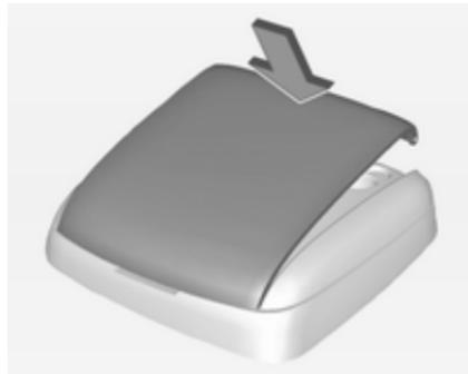
2. Закріпіть кришку на базовій станції.
