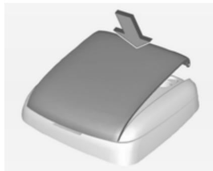
2. Закріпіть кришку на базовій станції.
