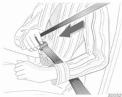
Витягніть пасок із переднатягувача, протягніть його через тіло та вставте язичок защіпки в пряжку. Регулярно підтягайте поясний пасок безпеки під час водіння, натягаючи плечовий пасок.
