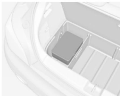
У моделях із коробкою для зберігання речей у багажнику сумка з комплектом для ремонту шин розміщена у відділенні цієї коробки  $\diamond 71$ .
