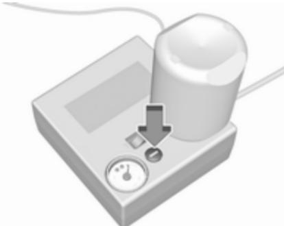
Якщо протягом десяти хвилин вказаного рівня тиску не досягнуто, зніміть набір для ремонту шин. Пересуньте автомобіль на один оберт шини. Повторно приєднайте набір для ремонту шин і продовжуйте процедуру заповнення протягом десяти хвилин. Якщо вказаний тиск у шинах все ще не вдається отримати, це свідчить про серйозне пошкодження шини. Зверніться по допомогу до майстерні.
