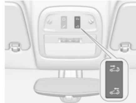
Вимикачем може використовуватися двома способами: коротке натиснення призначено для автоматичного керування, а утримування - для керування вручну.
