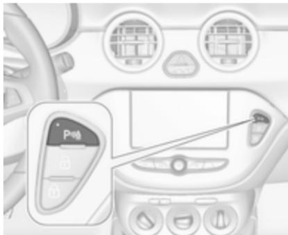
Система автоматично вимикається після вимкнення задньої передачі.
