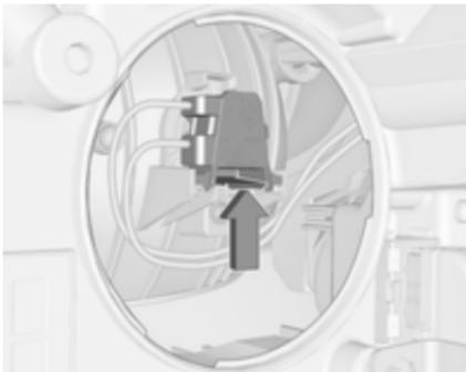
2. Натисніть хомут, щоб звільнити патрон лампи. Вийміть тримач лампи з рефлектора.
