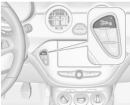
Під час пошуку місця для паркування система приводиться в робочий стан натисненням та утримуванням .
