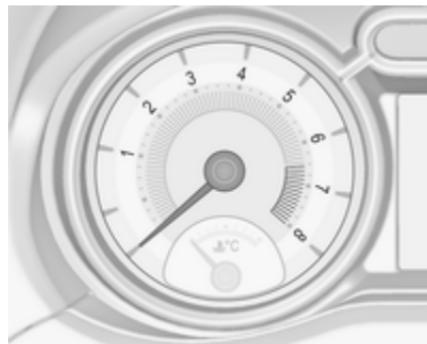
Вказує швидкість роботи двигуна. Їдьте на низких обертах для кожної передачі настільки довго, наскільки це можливо.
