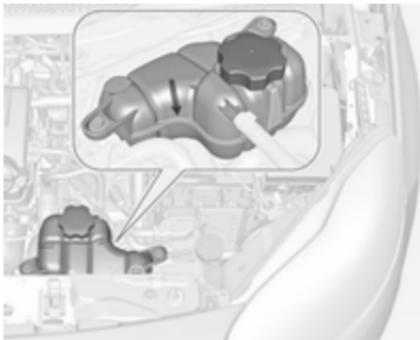
Якщо система холодна, рівень охолоджуючої рідини повинен бути вище лінії наповнення. За умови низького рівня долийте рідину.
