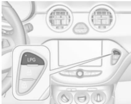
Після натиснення кнопки **LPG** автомобіль перемкнеться з бензину на скраплений газ одразу ж після досягнення необхідних параметрів (температура охолоджувальної рідини, температура газу та мінімальна частота обертів двигуна). Ці параметри зазвичай досягаються
