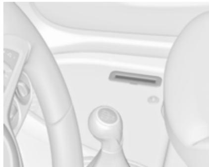
Ідентифікаційний номер автомобіля нанесено на маркувальній табличці, на днищі автомобіля та під покриттям полика, його можна побачити під покриттям.
