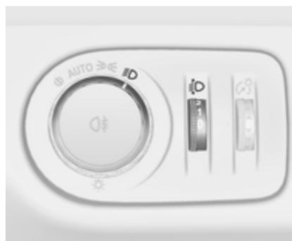
Щоб налаштувати діапазон освітлення фарами відповідно до навантаження автомобіля і запобіти засліпленню, виконайте такі дії: поверніть колесо регулятора  $\text{FO}$  в потрібне положення.
