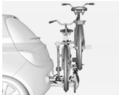
Задня система кріплення багажу (система Flex-Fix) дозволяє закріплювати один велосипед на витяжному тримачі, об'єднаному з підлогою автомобіля. Можна закріплювати ще один велосипед на адаптері. Перевезення інших речей заборонено.
