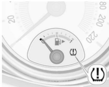
Розпізнавання стану тиску в шинах позначається контрольним індикатором (!)  $\Phi 98$ .
