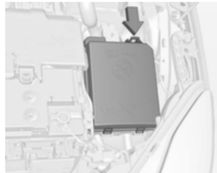
Блок запобіжників розміщується ліворуч скраю відділення для двигуна.
