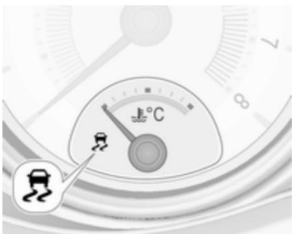
Система ТС готова до роботи після кожного запуску двигуна, щойно контрольний індикатор
