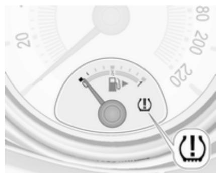
Розпізнавання стану тиску в шинах позначається контрольним індикатором ( )  $\Delta 99$ .
