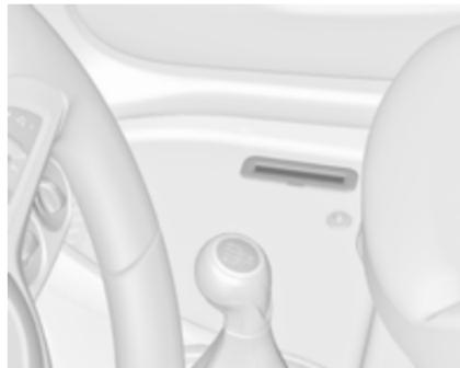
Ідентифікаційний номер автомобіля нанесено на маркувальній табличці, на днищі автомобіля та під покриттям полика, його можна побачити під покриттям.
