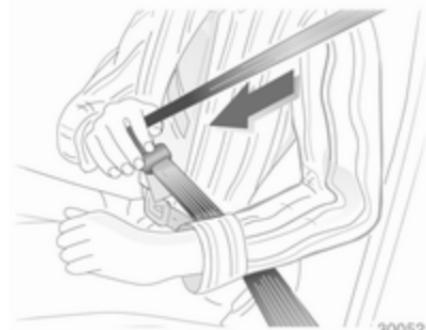
Витягніть пасок із переднатягувача, протягніть його через тіло та вставте язичок защіпки в пряжку. Регулярно підтягайте поясний пасок безпеки під час водіння, натягаючи плечовий пасок.
