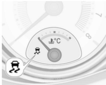
Система ESC готова до роботи після кожного запуску двигуна, щойно контрольний індикатор згасне.
