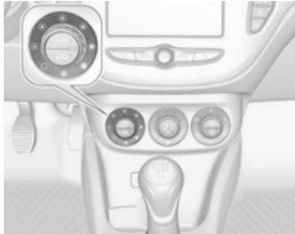
Повертайте лівий обертальний регулятор, щоб зменшити чи збільшити швидкість вентилятора. Швидкість вентилятора позначається на інформаційному дисплеї.
