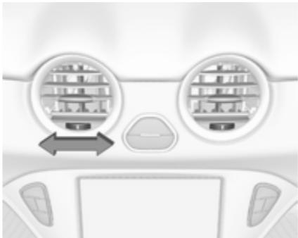
Відрегулюйте потік повітря, що надходить через повітропровід, повернувши колесо регулятора у потрібне положення.
