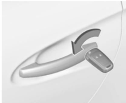
Щоб відімкнути дверцята водія вручну, вставте ключ у замок і поверніть його. Увімкніть запалювання та натисніть кнопку центрального замка , щоб відімкнути дверцята пасажира, багажне відділення і кришку горловини паливного баку.
