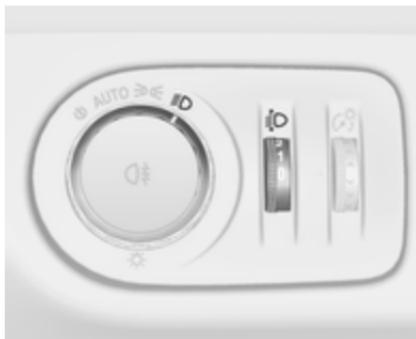
Щоб налаштувати діапазон освітлення фарами відповідно до навантаження автомобіля і запобігти засліпленню, виконайте такі дії: поверніть колесо регулятора в потрібне положення.
