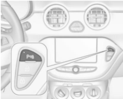
Система автоматично вимикається після вимкнення задньої передачі.
