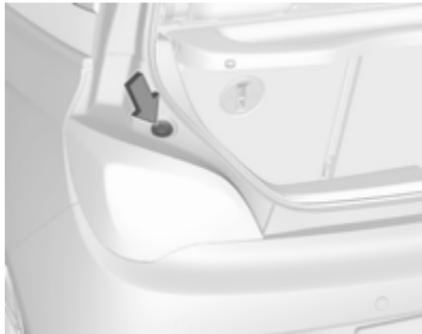
Закріпіть ліхтар у зборі в заглибленнях на кузові кріпильними шпильками, а потім затягніть пластмасову кріпильну гайку зсередини багажного відділення. Витягніть круглий ущільнювач через паз у корпусі лампи.
