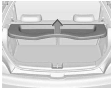
Підніміть покриття з заднього кінця. Воно фіксується майже у вертикальному положенні. Можна відкрити його далі. Щоб закрити кришку, опустіть її нижче місця фіксації.
