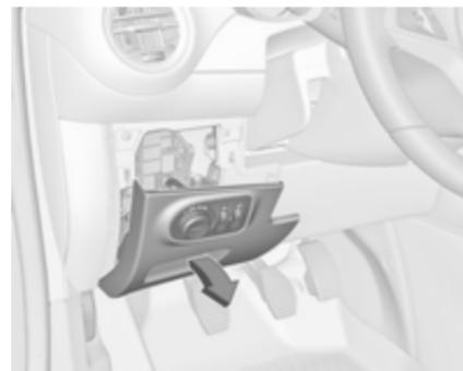
Блок запобіжників розміщується за вимикачем освітлення на панелі приладів.
