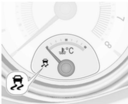
Система ТС готова до роботи після кожного запуску двигуна, щойно контрольний індикатор
