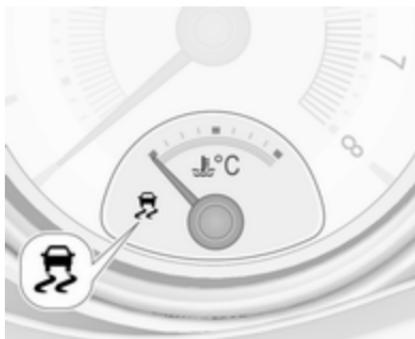
Система ESC готова до роботи після кожного запуску двигуна, щойно контрольний індикатор
