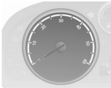
Вказує швидкість роботи двигуна. Вибирайте оптимальні оберти двигуна для кожної передачі.
