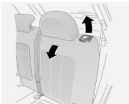
Щоб відрегулювати спинки сидінь, підніміть важіль фіксатора у верхній частині спинки та посуньте спинку вперед/назад у бажане положення.
