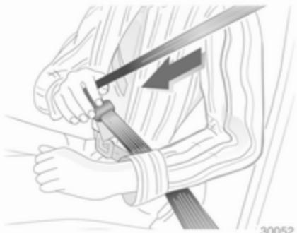
Витягніть пасок із переднатачівача, протягніть його через тіло та вставте язичок защілки в пряжку. Регулярно посилюйте щільність поясного паска безпеки під час водіння, натягуючи плечовий пасок.
