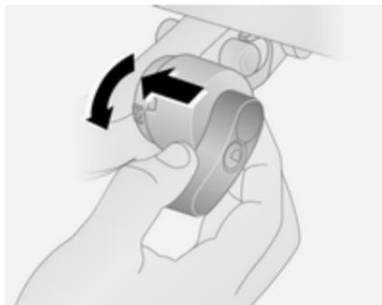
Розблокуйте штангу зі зчіпною кулею та витягніть ключ. Натисніть важіль ліворуч, до штанги зі зчіпною кулею та поверніть її вниз. Витягніть штангу зі зчіпною кулею з її посадкового місця.
