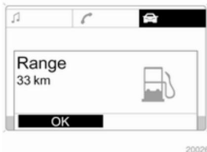
Якщо наявний обсяг палива у баку дозволяє проїхати менше ніж 50 км, на дисплеї з'являється попереджуvalне повідомлення **Range** (Пробіг без дозаправки).
