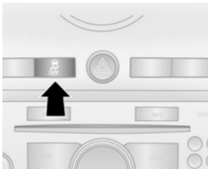
При активній системі ESC колеса не просковзують на мокрій, засніженній дорозі чи при ожеледиці, при цьому частота обертів двигуна може не
