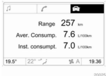
Пробіг без дозаправки обчислюється з урахуванням поточного вмісту баку та дані про миттєву витрату пального. Дисплей показує середні значення.
