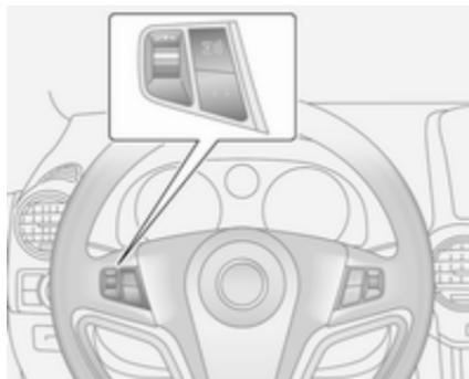
Поверніть колесо регулятора, щоб викликати потрібну функцію.
