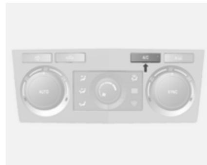
Параметри системи клімат-контролю можна змінити натисканням кнопки **A/C** або шляхом регулювання швидкості вентилятора чи розподілу повітря. При зміні налаштувань автоматичний режим вимикається.
