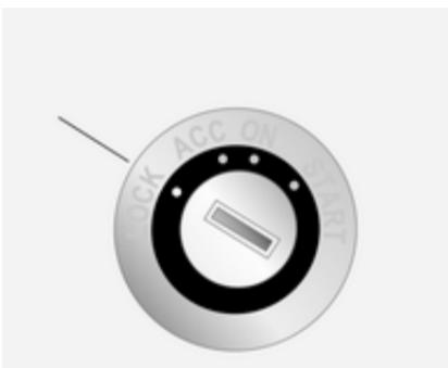
Систему інтегровано у замок запалювання. Вона перевіряє, чи може автомобіль запуститися за допомогою ключа, що використовується.
