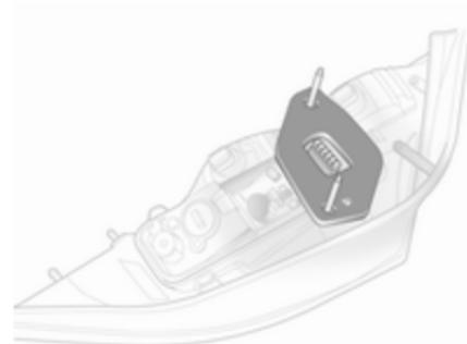
7. Установіть ущільнювач на тримач лампи. Переконайтеся, що в області гвинтів ущільнювач має плоску форму.
