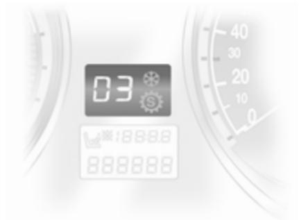
Режим або вибрана передача відображаються на дисплеї трансмісії.
