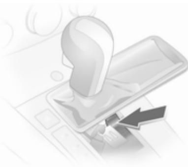
3. Підштовхніть жовтий фіксатор вперед за допомогою викрутки та перемістіть важіль селектора з положення **P**.
