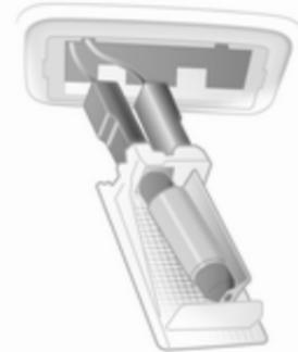
2. Легко натисніть лампу до пружинного затискача та вийміть її.
