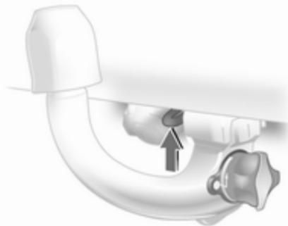
Зabloкуйте штангу поверненням ключа в положення
