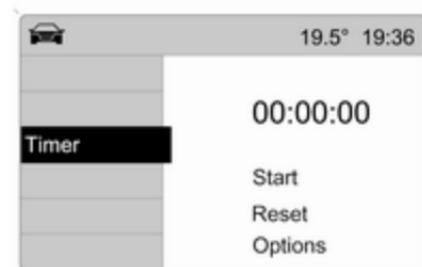
Виберіть пункт меню **Timer (Таймер)** в меню **Board Computer (Бортовий комп'ютер)**.
