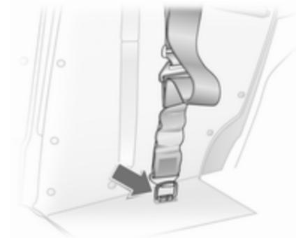
Відрегулюйте довжину пасків сітки безпеки, причепивши верхній гачок до отвору в паску та прикріпивши їх до отворів у правій та лівій частині полиця.
