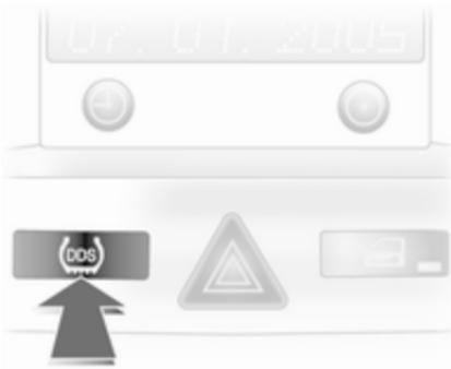
Після заміни колеса система потребує ініціалізації: накачайте шини до вказаного показника тиску, ввімкніть запалення, натисніть і протягом приблизно 4 секунд утримуйте кнопку **DDS**, після чого контрольний індикатор (⚠) спалахне три рази.
