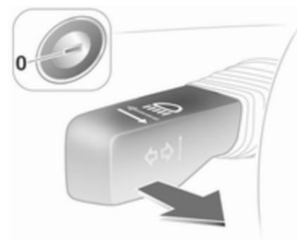
Фари та ліхтарі заднього ходу вмикаються приблизно через 30 секунд після активації системи та закриття дверцят водія.
