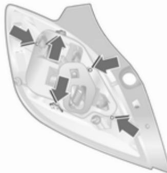
5. Відкрутіть три гвинти за допомогою викрутки. Втисніть заціпки на зовнішній стороні тримача лампи всередину та зніміть тримач лампи.
