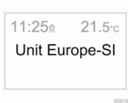
За допомогою кнопок зі стрілками виберіть потрібну одиницю вимірювання.
