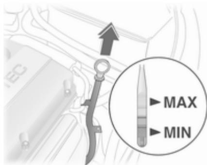
Залежно від варіанта двигуна використовуються різні щупи.
