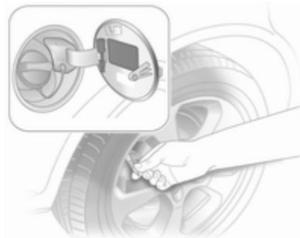
Зніміть ключ ковпачка вентиля з кришки горловини паливного баку та використайте його, щоб відкрити ковпачок вентиля.
