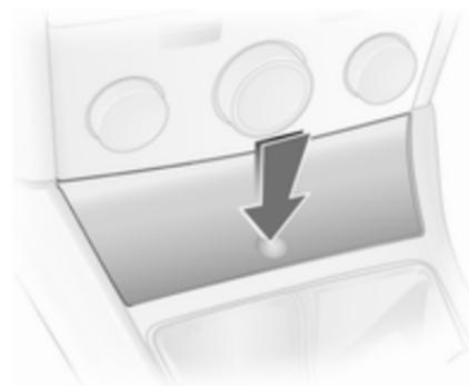
Запальничка розташована за кришкою попільнички. Натисніть кришку попільнички, щоб відчинити її.
