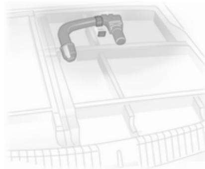
В автомобілях із кузовом "седан" з'єднувальна штанга міститься в торбинці, закріпленій ремінцем у вантажному відсіку багажного
