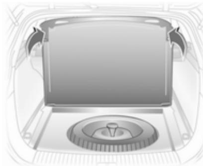
Зніміть адаптер і гачки з напрямних на стінках багажного відділення. Підніміть задні отвори для кріплення та переведіть полик у вертикальне положення, щоб він спирався на панель даху. Закриваючи полик, проведіть отвори для кріплення через щілини в полицю. Автомобілі із вантажним відсіком: демонтаж ⇨ 83.
