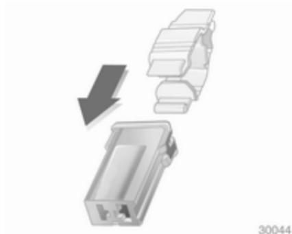
Установіть знімач запобіжника на різні типи запобіжників зверху чи збоку та витягніть запобіжник.
