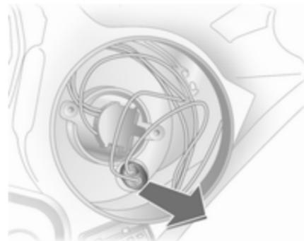
3. Вийміть патрон стоянкового освітлення з рефлектора.
