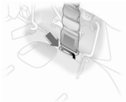
Відрегулюйте довжину пасків сітки безпеки, причепивши верхній гачок до отвору в паску та прикріпивши їх до отворів у правій та лівій частині полика.
