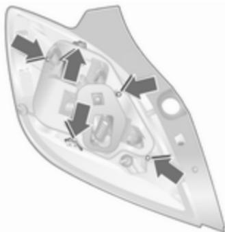
5. Зніміть ущільнювач із кріпильного болта. Витисніть защіпки на зовнішній стороні тримача лампи та зніміть тримач лампи.
