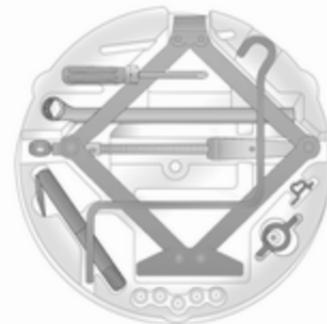
Домкрат та комплект інструментів зберігаються в багажному відділенні під запасним колесом. Запасне колесо ↻ 218
