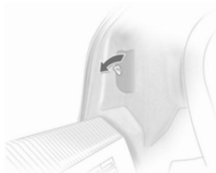
1. Щоб замінити лампи, складіть кришку в багажному відділенні, повернувши затискач.
