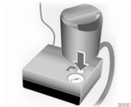
13. Вказаний рівень тиску в шинах досягається протягом 10 хвилин. Тиск у шинах  $\varnothing$  254. Після досягнення належного тиску в шинах компресор вимикається.
