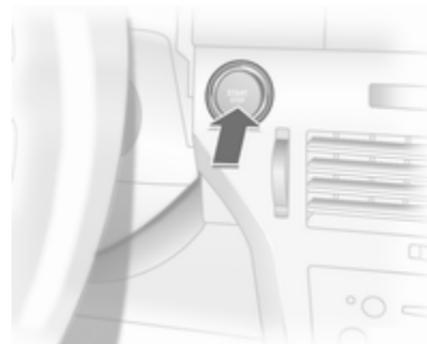
Електронний ключ має бути в салоні автомобіля. Активуйте зчеплення та гальма, автоматична трансмісія перебуває в положенні **P** або **N**, не збільшуйте швидкість двигуна, для дизельних двигунів – натисніть і відпустіть кнопку, щоб розпочати прогрівання, після чого злегка поверніть кермо, щоб
