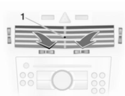
Щоб відчинити повітропровід, поверніть колесо регулятора в положення I.
