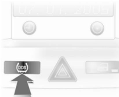
Після відновлення потрібного тиску в шинах або заміни колеса потрібно виконати ініціалізацію системи: ввімкніть запалення, натисніть і протягом приблизно 4 секунд утримуйте кнопку **DDS**, після чого контрольний індикатор (⚠) спалахне три рази.
