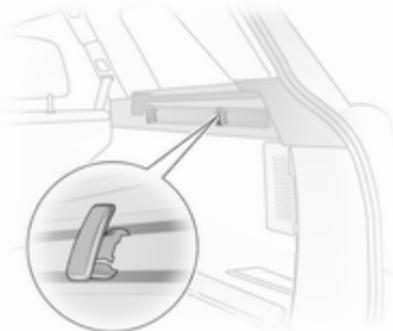
У кузові типу "універсал" установіть гачки у потрібне положення на рейках: вставте гачок у верхній паз рейки та втисніть його у нижній паз.
