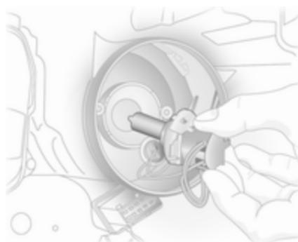
4. Вийміть тримач лампи з лампою з рефлектора.
