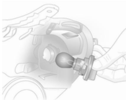
3. Легко втисніть лампу в патрон, поверніть проти годинникової стрілки, зніміть несправну лампу та замініть її на нову.
