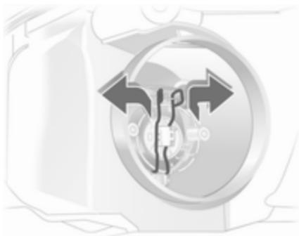
4. Зніміть пружинний затискач із фіксатора натисканням вперед, а потім поверніть його донизу.
