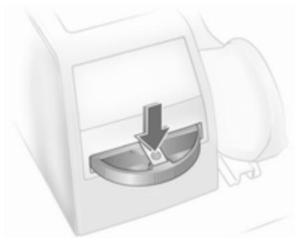
Щоб опорожнити попільничку, натисніть пружину й витягніть попільничку прямо назад.
