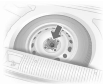
Запасне колесо розташоване в багажному відділенні під покриттям полиця. Воно кріпиться в заглибленні крильчатого гайкою.
