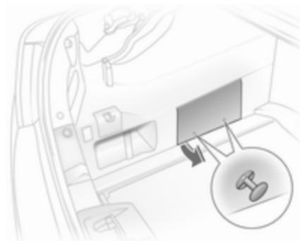
Для відкриття витягніть дві кнопки, зніміть затискачі та складіть кришку вгору.
