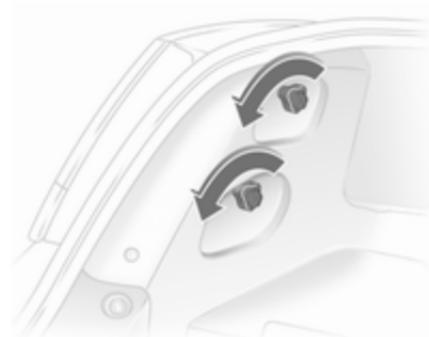
1. Відкрутіть стопорні гайки.
