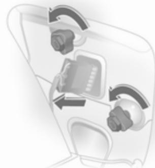
3. Ослабте гайки для кріплення колісним ключем і відкрутіть їх рукою. Інструменти автомобіля ⇨ 206.
