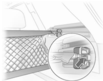
Вставте у кожну рейку адаптер: розкладіть пластину ручки, вставте адаптер у верхній та нижній пази рейки та перемістіть у потрібне положення. Поверніть пластину вверх, щоб заблокувати адаптер. Перед вставленням адаптерів потрібно витягти рейки сітки: повністю витягніть кінцеві деталі та зафіксуйте, повернувши їх за годинниковою стрілкою.
