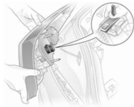
2. Вийміть корпус патрона ззовні. Від'єднайте з'єднувач, натиснувши клапан і вийнявши його з тримача лампи.
