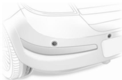
Система допомоги під час паркування полегшує паркування, вимірюючи відстань між автомобілем і перешкодами. Проте лише водій несе повну відповідальність за паркування.
