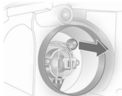
3. Вийміть тримач лампи стоянкового освітлення з рефлектора.
