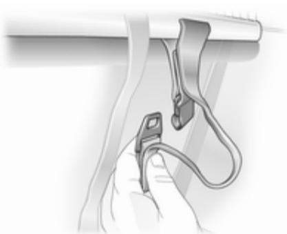
Нахиліть регулятор довжини натяжного ремня сітки вгору та відчепіть ремінь. Зніміть рейки сітки зі скоб на рамі даху. Згорніть сітку та закріпіть її паском.
