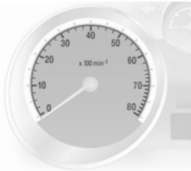
Вказує швидкість роботи двигуна. Вибирайте оптимальні оберти двигуна для кожної передачі.
