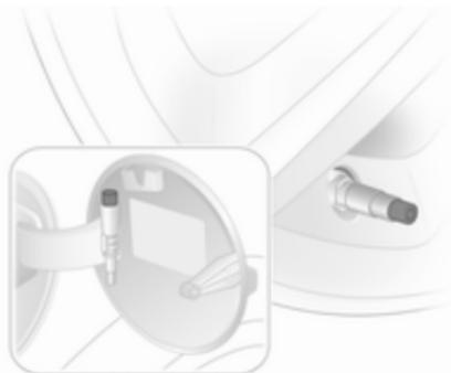
На автомобілях із системою контролю за тиском у шинах відкрутіть адаптер клапана.
