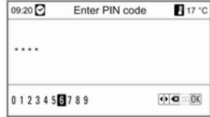
Введіть PIN-код SIM-картки мобільного телефону. Після цього між телефоном і порталом устанавлюється з'єднання. Через портал телефону можна також користуватися послугами оператора мережі мобільного зв'язку.
