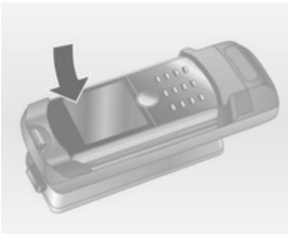
Після цього опустіть передній край. Під час закріплення мобільного телефону має пролунати характерний звук.
