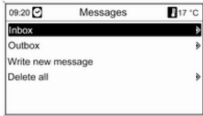
Відразу після під'єднання телефону в режимі SAP можна переглядати, створювати та надсилати повідомлення через портал телефону. У цьому ж меню повідомлення можна видаляти.
