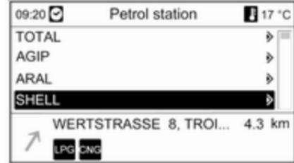
Нижче наводиться список детальної інформації про відмічену АЗС: приблизний напрямок до АЗС, адреса, відстань та наявні типи палива (окрім бензину та дизельного палива).
