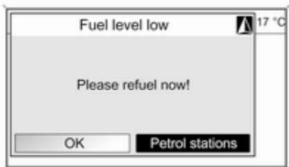
Щоб розпочати пошук АЗС поруч з поточним розташуванням автомобіля, оберіть **Petrol stations** (**Автозаправочні станції**).
