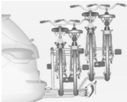
На задній системі кріплення багажу (система Flex-Fix) можна закріплювати два велосипеди на витяжному тримачі, закріплениму на підлозі автомобіля. Можна закріплювати ще два велосипеди на адаптері. Перевезення інших речей заборонено.
