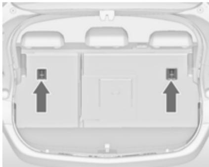
Установивши систему ISOFIX, закріпіть ремінь Top-Tether в отворах для кріплення Top-Tether. Пасок повинен проходити між двома направляючими валиками підголівника.
