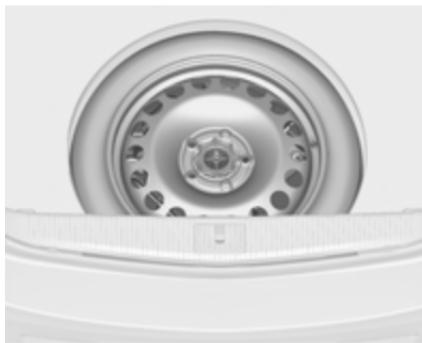
Запасне колесо розташоване в багажному відділенні під покріттям полика. Воно закріплене на місці крильчатою гайкою.
