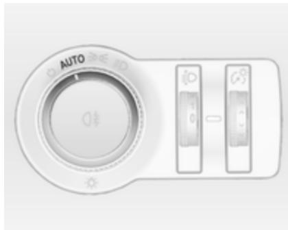
Коли функцію автоматичного керування освітленням увімкнено, а двигун працює, система автоматично змінює режим освітлення при денному світлі та
