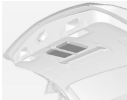
Складіть ремінь. Зберігайте аптечку за паском на внутрішній частині багажника.
