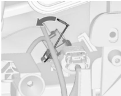
1. Від'єднайте пружинний затискач, після чого поверніть його назад.
