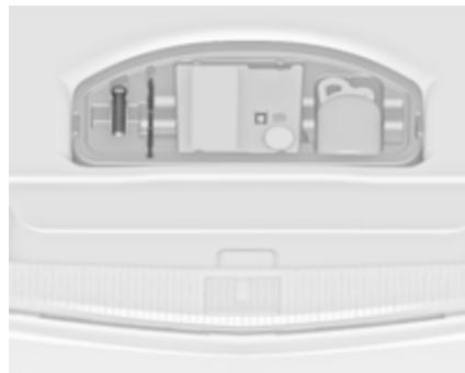
Інструменти та набір для ремонту шин зберігаються під поликом багажного відділення.
