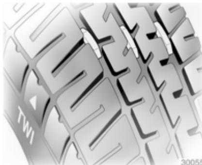
Мінімальна встановлена законодавством глибина малюнку протектора (1,6 мм) досягається, що його зноситься протектор (про що свідчать індикатори зносу (TWI)). Положення цих індикаторів указано позначками на боковій частині.
