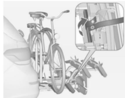
4. Проведіть ремінь, закріплений до адаптера, під важелем для складання задньої системи кріплення назад. Закріпіть ремінь.
