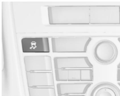
Для максимально розкнутого водіння систему ESC можна дезактивувати: утримуйте кнопку
