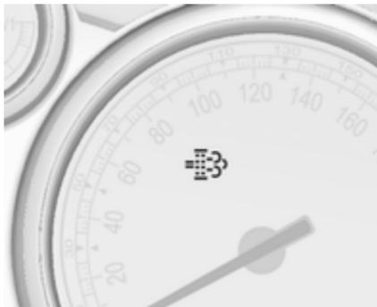
За певних умов водіння, наприклад, під час долання коротких відстаней, система не може виконати очищення автоматично.
