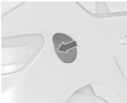
Кришку горловини паливного баку можна відчинити лише, якщо автомобіль розблоковано. Натиснувши кришку горловини паливного баку, зніміть її. Щоб відкрити кришку, повільно поверніть її ліворуч.
