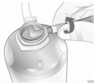
4. Прикрутіть повітропровід компресора до з'єднання на корпусі ущільнювача.
