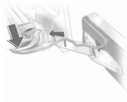
Опустіть блокувальний важіль вниз та посуньте опору лампи у фіксатор, доки вона не зафіксується.
