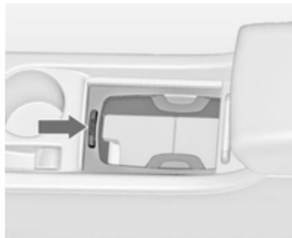
Натисніть на кнопку, щоб зняти корпус тримача для стаканів. Корпус можна зберігати в бардачку.
