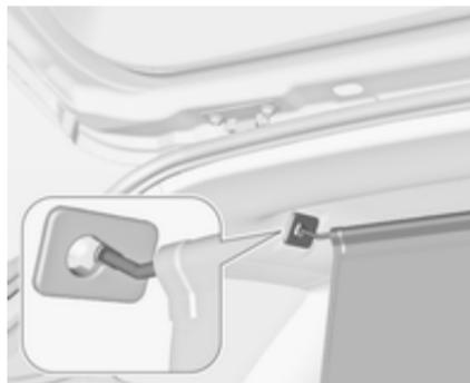
Існує два отвори для встановлення в рамі даху: підвісьте та зафіксуйте рейку сітки з одного боку, стисніть рейку, підвісьте та зафіксуйте її з другої сторони.
