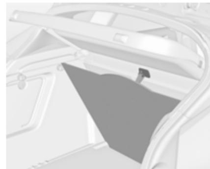
Кришку полика в багажному відділенні можна підняти та підвісити за допомогою ремінця.
