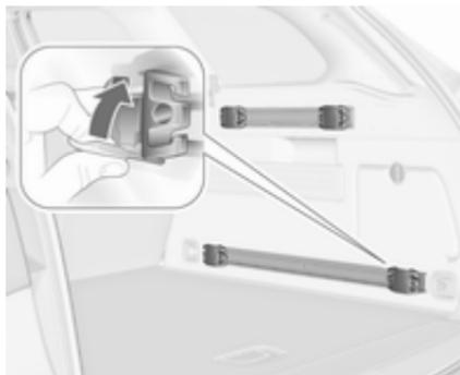
Розкладіть пластину ручки, вставте адаптер у верхній та нижній пази рейки та перемістіть у потрібне положення. Поверніть пластину
