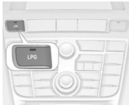
Натискання кнопки **LPG** здійснює перехід між режимом роботи на бензині та режимом скрапленого газу. Світлодіодний індикатор ● позначає поточний режим роботи.
