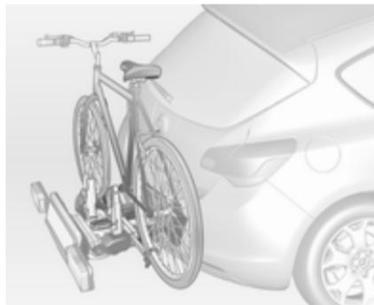
Задня система кріплення багажу (система Flex-Fix) дозволяє закріплювати велосипеди на витяжному тримачі, інтегрованому в полік автомобіля. Перевезення інших речей заборонено.
