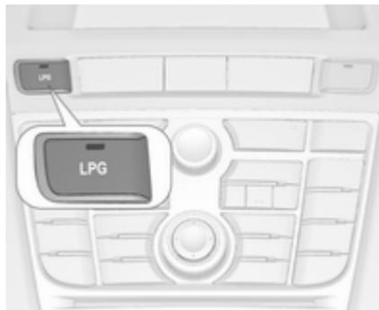
При натисканні кнопки **LPG**, робота автомобіля перемикається з бензину на скраплений газ одразу ж після досягнення необхідних параметрів (температура охолоджувальної рідини, температура газу та мінімальна частота обертів двигуна). Ці параметри зазвичай досягаються через 60 секунд після першого активного натискання на педаль акселератора (залежно від температури повітря). Світлодіодний індикатор позначає поточний режим роботи.
