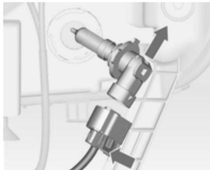
2. Від'єднайте тримач від з'єднувача, натиснувши закріплювач.
