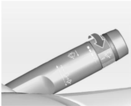
Поверніть колесо регулятора, щоб відрегулювати чутливість:
