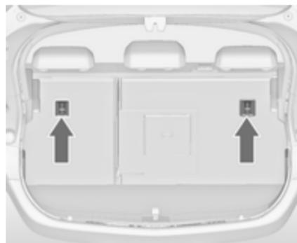
Установивши систему ISOFIX, закріпіть ремінь Top-Tether в отворах для кріплення Top-Tether. Пасок повинен проходити між двома направляючими валиками підголовника.
