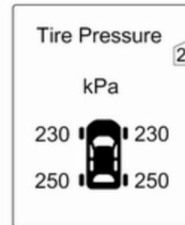
Поверніть колесо регулятора, щоб вибрати систему контролю тиску в шинах.
