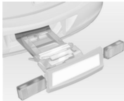
Перевірте положення кабелю та лампи, щоб переконатися в правильному їх установленні та надійному розташуванні.
