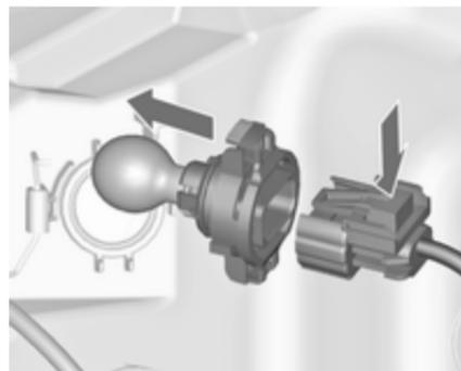
3. Від'єднайте тримач від з'єднувача, натиснувши закріплювач.
