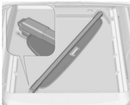
Зняту кришку можна зберігати під задньою частиною підлоги, як показано на малюнку.
