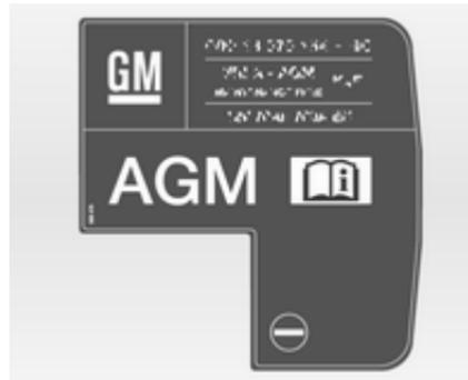
Акумулятор AGM можна розпізнати по ярлику на акумуляторі. Ми рекомендуємо використовувати фірмовий акумулятор Opel.
