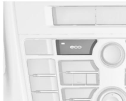
Вимкніть систему стоп-старт вручну, шляхом натискання на кнопку **eco**. Вимкнення підтверджується згасанням світлодіодного індикатора кнопки.
