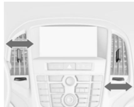
Щоб відкрити повітропровід, поверніть колесо регулятора в напрямку символу більшого розміру
