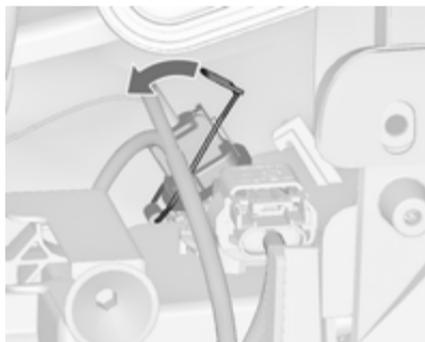
1. Від'єднайте пружинний затискач, після чого поверніть його назад.
