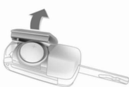
Розкладіть ключ і відчиніть блок. Замініть батарею (тип батареї CR 2032), беручи до уваги її положення під час установлення. Зачиніть блок і здійсніть синхронізацію.
