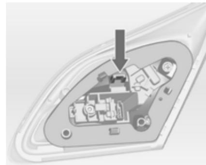
4. Натисніть закріплювач і вийміть тримач лампи з блоку задніх ліхтарів.
