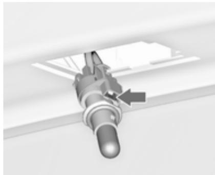
3. Від'єднайте закріплювач і вийміть тримач лампи із затискача.
