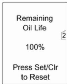
На дисплеї вищого рівня або комбінованому дисплеї вищого рівня в **Vehicle Information Menu (Меню інформації про автомобіль)** відображається час, що залишився до наступної заміни масла.
