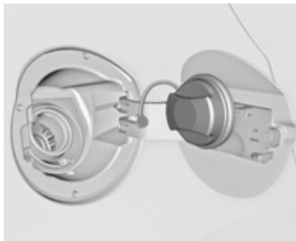
Кришка горловини паливного баку може бути зафіксована в скобі на горловині паливного баку.
