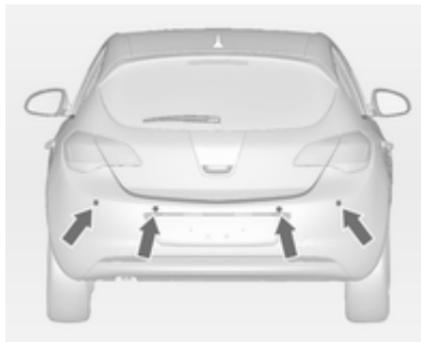
Система допомоги під час паркування полегшує процес паркування, вимірюючи відстань між автомобілем і перешкодами та відтворюючи звуковий сигнал.
