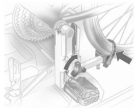
Затягніть закріпний гвинт тримача підшипника педалі вручну до упору.
