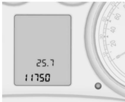
Центр інформації водія (DIC) розташований на панелі приладів між спідометром і тахометром. Він доступний як дисплей середнього чи вищого рівня або комбінований дисплей вищого рівня.
