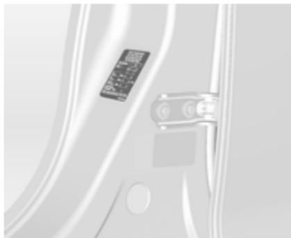
Тиск у шинах  $\diamond$  343 і на ярлику, розташованому на дверній рамі лівих та правих передніх дверцят. Дані про тиск у шинах стосуються холодних шин. Це стосується і літніх, і зимових шин.
