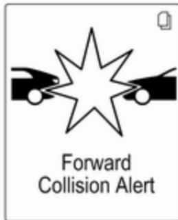
При занадто швидкому наближенні до іншого автомобіля в інформаційному центрі водія з'явиться сторінка попередження про зіткнення. Водночас, пролунає попереджувальний сигнал.
