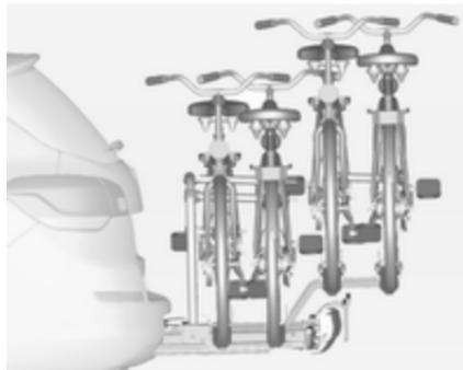
На задній системі кріплення багажу (система Flex-Fix) можна закріплювати два велосипеди на витяжному тримачі, закріпленному на підлозі автомобіля. Можна закріплювати ще два велосипеди на адаптері. Перевезення інших речей заборонено.
