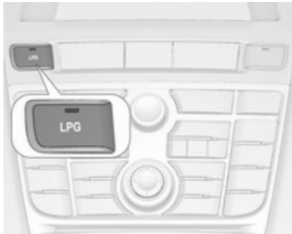
Щоб перейти з режиму роботи на бензині в режим роботи на скрапленому газі та навпаки, натисніть кнопку **LPG**.
