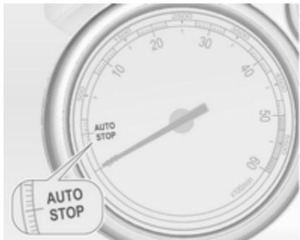
Функція Автостоп позначається стрілкою у положенні **AUTOSTOP** на тахометрі.
