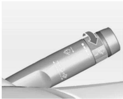
Поверніть колесо регулятора, щоб відрегулювати чутливість:
