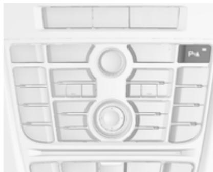
Система допомоги під час паркування вмикається і вимикається натисканням кнопки допомоги при паркуванні  $P\triangle$ . Якщо автомобіль додатково обладнано системою допомоги під час паркування  $\Rightarrow$  224, то її оснащують кнопкою  $\triangle P$ . В обох випадках обидві системи керуються за допомогою кнопки  $\triangle P$ .
