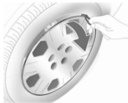
1. Зніміть ковпачки гайок за допомогою викрутки і відкладіть їх в сторону. Щоб зняти ковпак, потягніть його за гачок. Інструменти автомобіля  $\Phi$  287. Легкосплавні диски: Зніміть ковпачки гайок за допомогою викрутки і відкладіть їх в сторону. Щоб захистити колесо, покладіть м'яку тканину між
