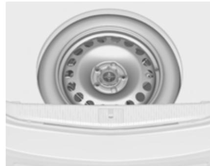
Запасне колесо розташоване в багажному відділенні під покриттям полика. Воно закріплене на місці крильчаткою гайкою.
