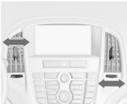
Щоб відкрити повітропровід, поверніть колесо регулятора в напрямку символу більшого розміру
