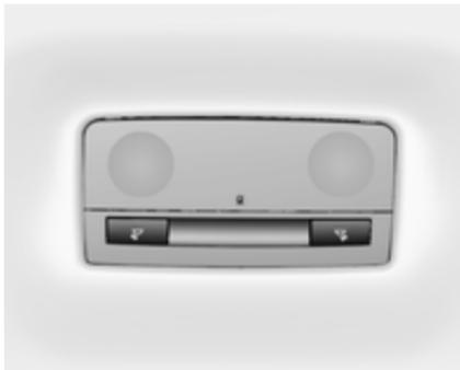
Засвічується одночасно із підсвічуванням салону спереду, залежно від положення кулісного перемикача.
