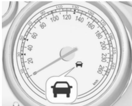
Зелений контрольний індикатор "автомобіль попереду" 🚗 з'являється на спідометрі, коли система розпізнає автомобіль на вашому шляху.
