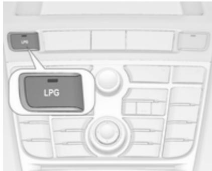
При натисканні кнопки **LPG**, робота автомобіля перемикається з бензину на скраплений газ одразу ж після досягнення необхідних параметрів (температура охолоджувальної рідини, температура газу та мінімальна частота обертів двигуна). Ці параметри зазвичай досягаються через 60 секунд після першого активного натискання на педаль акселератора (залежно від температури повітря).
