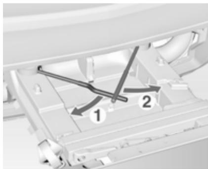
Спочатку поверніть лівий затискний важіль (1), після чого поверніть правий затискний важіль (2) до упору.
