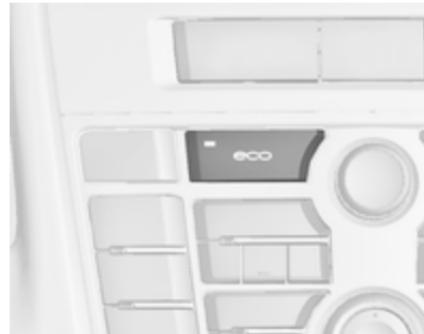
Вимкніть систему стоп-старт вручну, шляхом натискання на кнопку **eco**. Вимкнення підтверджується згасанням світлодіодного індикатора кнопки.
