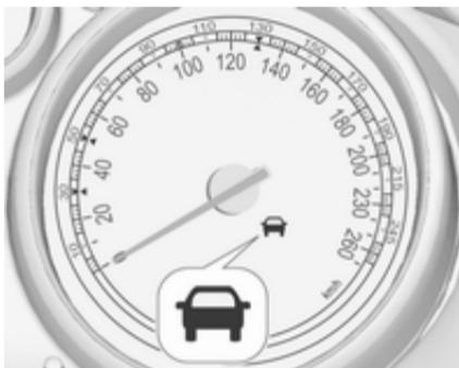
Зелений символ "автомобіль попереду" засвічується на спідометрі, коли система розпізнала автомобіль на вашому шляху. Передумовою для цього є ввімкнення функції повідомлення про небезпеку зіткнення спереду у меню персоналізації автомобіля  $\diamond 147$ , або ж те, що ця система не була потім вимкнена кнопкою (залежно від системи, див. далі).
