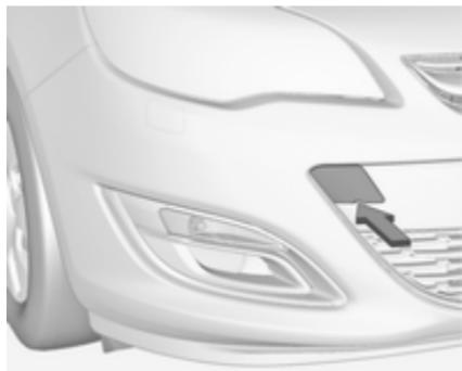
Вставте викрутку в отвір у нижньому вигині кришки. Обережно опускайте викрутку вниз, щоб зняти кришку. Буксируна провушана зберігається разом з інструментами для автомобіля ⇨ 287.
