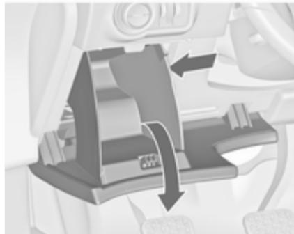
В автомобілях із лівостороннім керуванням коробка запобіжників знаходиться за відділенням для зберігання в панелі приладів.
