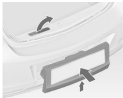
Штовхніть важіль розблокування вгору та утримуйте його в такому положенні. Злегка підніміть систему і посуньте її в бампер до фіксації.
