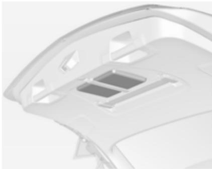
Складіть ремінь. Зберігайте аптечку за паском на внутрішній частині багажника.
