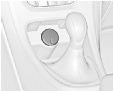
Розетка з напругою 12 В розташована в передній консолі.
