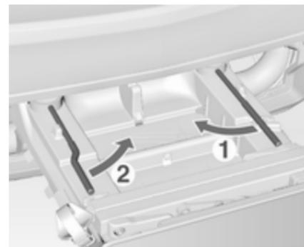
Спочатку поверніть затискний важіль (1), потім лівий (2) до відчутного спротиву.
