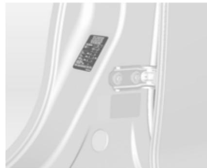
Тиск у шинах  $\varnothing$  338 і на ярлику, розташованому на дверній рамі лівих та правих передніх дверцят.
