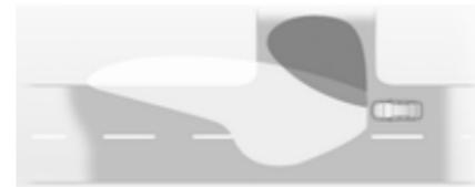
На поворотах з обмеженою видимістю або під час виконання повороту, залежно від кута чи ввімкненого вказівника повороту, ліворуч або праворуч вмикається додатковий рефлектор, який освітлює дорогу в напрямку руху під відповідним кутом. Активується на швидкості 40 км/год.
