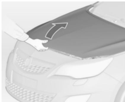
Зсуньте запобіжну зачіпку до лівого боку автомобіля і відкрийте капот.
