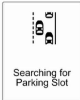
Поки автомобіль із активованою системою допомоги рухається вздовж ряду машин, розширена система допомоги під час паркування здійснює пошук місця для парковки. При розпізнанні підходящого місця надаються візуальні та акустичні сигнали в інформаційному центрі водія.
