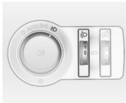
Щоб налаштувати діапазон освітлення фарами відповідно до навантаження автомобіля і запобігти засліпленню, виконайте такі дії: поверніть колесо регулятора  $\text{D}$  в потрібне положення.
