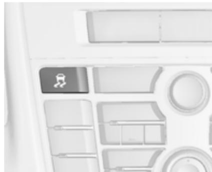
Для агресивнішої їзди системи ESC та ТС можна вимкнути окремо одна від одної:
