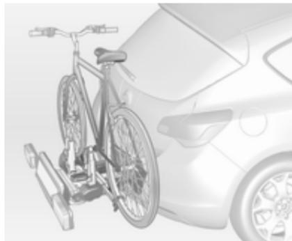
Задня система кріплення багажу (система Flex-Fix) дозволяє закріплювати велосипеди на витяжному тримачі, інтегрованому в полку автомобіля. Перевезення інших речей заборонено.
