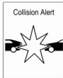
Якщо автомобіль, що рухається попереду, наближається занадто швидко, пролунає попереджувальний звуковий сигнал, і в інформаційному центрі водія з'являється повідомлення.
