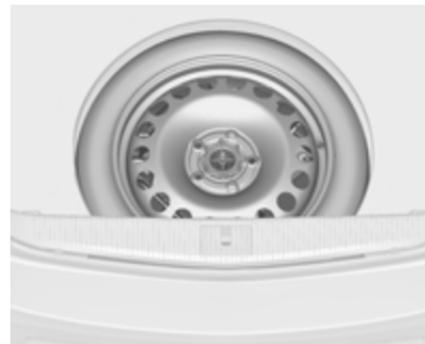
Запасне колесо розташоване в багажному відділенні під покриттям полиця. Воно закріплене на місці крильчатою гайкою.
