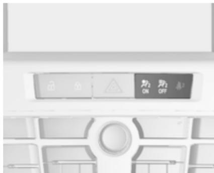
Змініть стан лише тоді, коли автомобіль стоятиме на місці з вимкненою системою запалювання.
