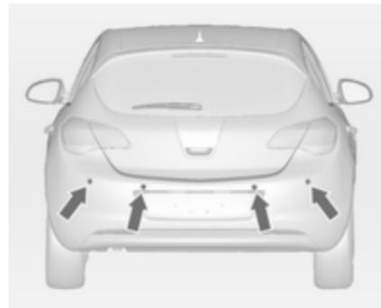
Система допомоги під час паркування полегшує процес паркування, вимірюючи відстань між автомобілем і перешкодами та відтворюючи звуковий сигнал. Проте за виконувани маневри під час паркування відповідає лише водій.
