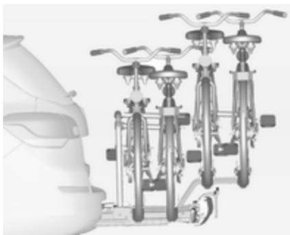
На задній системі кріплення багажу (система Flex-Fix) можна закріплювати два велосипеди на витяжному тримачі, закріпленому на підлозі автомобіля. Можна закріплювати ще два велосипеди на адаптері. Перевезення інших речей заборонено.
