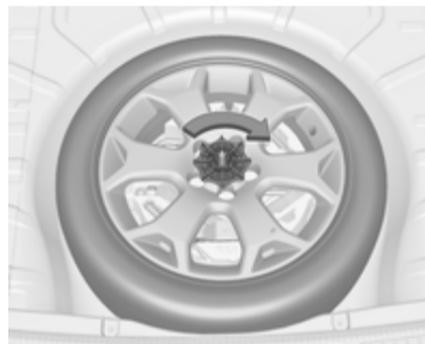
Пошкоджене повнорозмірне колесо слід зберігати у ніші для запасного колеса закріпленим за допомогою крильчастої гайки. Кришку підлоги можна покласти на колесо, що виступає з паза.
