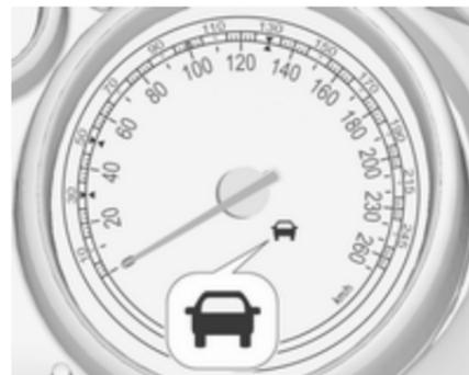
Про наявність автомобіля попереду сигналізує контрольний індикатор 🚗.
