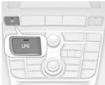
Щоб перейти з режиму роботи на бензині в режим роботи на скрапленому газі та навпаки, натисніть кнопку **LPG**. Світлодіодний індикатор
