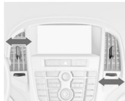
Щоб відкрити повітропровід, поверніть колесо регулятора в напрямку символу більшого розміру
