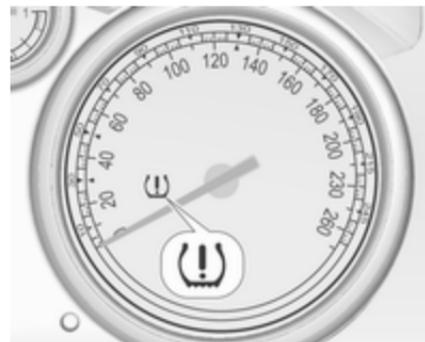
Розпізнавання стану тиску в шинах позначається контрольним індикатором (⚠) ⇨ 129.
