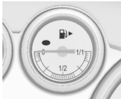
Цей датчик відображує інформацію про рівень палива або газу в баку, залежно від робочого режиму.
