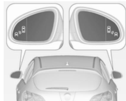
Системи попереджування про об'єкти в мертвій зоні видимості діє при швидкостях від 10 км/год до 140 км/год. В разі перевищення швидкості 140 км/год система вимикається, про що свідчитиме слабке підсвічування попереджувальних символів <sup>AV</sup> в обох зовнішніх дзеркалах. При
