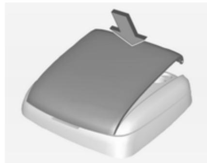
2. Закріпіть кришку на базовій станції.
