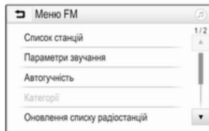
Виберіть **Список станцій** для відповідного діапазону. Відобразяться всі радіостанції відповідного діапазону та поточної зони прийому.
