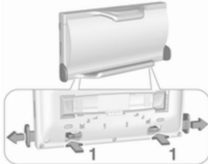
1. Натисніть на обидва фіксатори (1) на задній панелі, щоб від'єднати планки для регулювання ширини, а потім витягніть їх.
