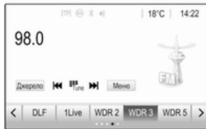
Усього є п'ять списків елементів вибраного, в кожному з яких можна зберегти п'ять радіостанцій.
