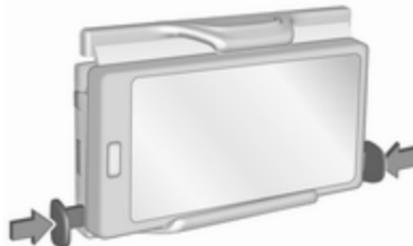
4. Відрегулюйте ширину тримача відповідно до ширини телефону, зсунувши регульовальні планки одна до одної.
