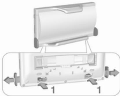
1. Натисніть на обидва фіксатори (1) на задній панелі, щоб від'єднати планки для регулювання ширини, а потім витягніть їх.
