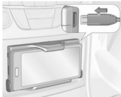
Підключіть смартфон до тримача за допомогою сумісного з'єднувального кабелю. Є різні версії з'єднувальних кабелів, які випускаються як додаткове приладдя.
