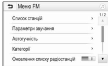
Виберіть **Список станцій** для відповідного діапазону. Відобразяться всі радіостанції відповідного діапазону та поточної зони прийому.
