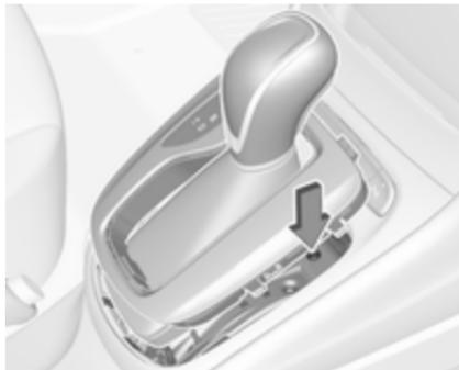
3. Вставте маленьку паличку (наприклад, ручку чи викрутку) в отвір біля важеля селектора. Натисніть на паличку, тримаючи її вертикально, і зсуньте важіль селектора з положення P. Якщо знову вибрати цю передачу, важіль селектора знову буде заблоковано. Для усунення переривання живлення зверніться до майстерні.
