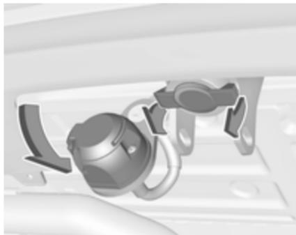
Від'єднайте та відкиньте розетку для підключення. Вийміть ущільнювальну пробку з отвору для штанги та приберіть її.
