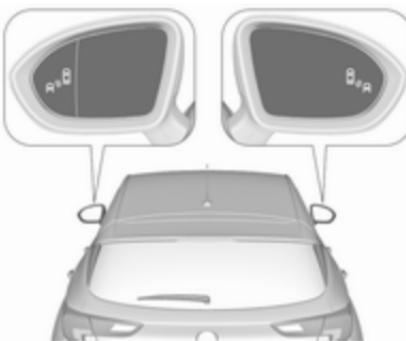
Системи попереджування про об'єкти в мертвій зоні видимості діє при швидкостях від 10 км/год до 140 км/год. В разі перевищення швидкості 140 км/год система вимикається, про що свідчитьime
