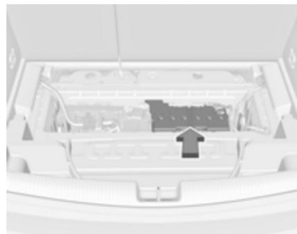
Автомобільний акумулятор знаходиться в багажному відділенні позаду задніх сидінь під задньою кришкою підлоги. Задня кришка підлоги  $\diamond$  89.
