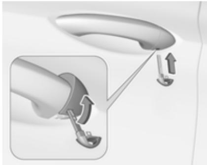
**Електронний ключ:** щоб зняти заглушку, натисніть кнопку з заднього боку і вийміть лезо ключа з корпусу. Вставте ключ у заглиблення з нижнього боку заглушки і поверніть ключ вгору. Система електронного ключа ⚡ 24.
