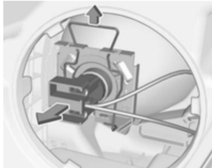
2. Потягніть і від'єднайте пружинний затискач від фікатора. Вийміть патрон лампи з корпусу рефлектора.
