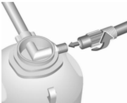
4. Прикрутіть повітропровід компресора до з'єднання на корпусі ущільнювача.
