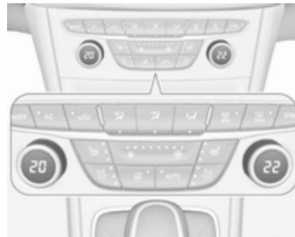
Встановіть температуру на бажане значення. Регулятор з боку пасажира регулює температуру з боку пасажира. Регулятор з боку водія може регулювати температуру з боку водія, а також температуру з обох боків, коли ввімкнuto режим синхронізації **SYNC**.
