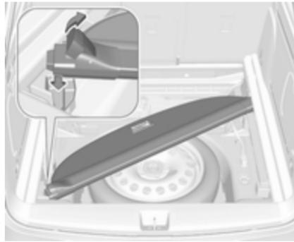
Усі версії двигунів, крім призначених для роботи на стиснутому газі (CNG): зняту роликову штору можна зберігати під задньою кришкою підлоги, як показано на малюнку. Спочатку вставте лівий край згорнутої штори в заглиблення спереду праворуч, потягніть важіль розблокування вгору і вставте правий край штори в заглиблення спереду ліворуч.
