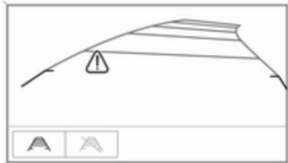
Кольоворовий інформаційний дисплей 7": відображення попереджувальних символів та напрямних можна вимикати за допомогою сенсорних кнопок у нижній частині дисплея.
