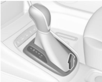
2. Відчепіть оздоблювальну накладку важеля перемикання передач від центральної консолі. Встроміть палець в покриту шкірою заглибину під важелем селектора і виштовхніть оздоблювальну накладку додори. Поверніть оздоблення вліво.
