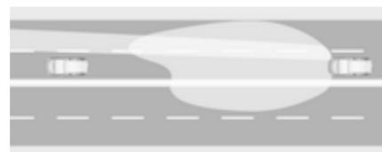
У системі керування дальнім світлом передбачено спеціальний режим для автомагістралей. Під час руху автомагістраллю зі швидкістю понад 115 км/год світловий промінь зменшується для запобігання засліпленню водіїв зустрічних автомобілів. Під час руху за автомобілем або обгону відблиски у дзеркалах цих автомобілів послаблюються.
