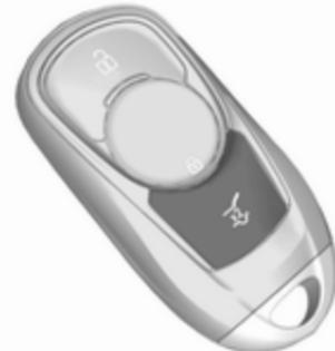
Щоб відчинити чи зачинити двері багажного відділення, двічі натисніть ⏪. Щоб двері багажного
