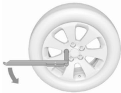
2. Розкладіть ключ і встановіть його, перевіривши надійність його положення, після чого відкрутіть кожну гайку на півверта.
