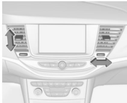
Щоб відкрити повітропровід, поверніть колесо регулятора в напрямку символу більшого розміру
