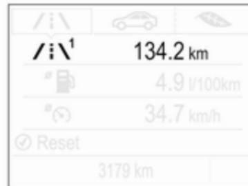
Виберіть **/\** кнопкою **Menu** на важелі перемикання сигналів повороту. Поверніть коліщатко регулятора на важелі перемикання сигналів повороту, а потім виберіть **/\1** або **/\2**. Лічильник щоденного пробігу можна скинути окремо для кожної поїздки, натиснувши на кілька секунд **SET/CLR** на важелі перемикання сигналів повороту, коли відкрито відповідне меню.
