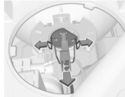
2. Від'єднайте пружинний затискач від фіксатора, переміщаючи його вперед і вбік. Поверніть пружинний затискач донизу.
