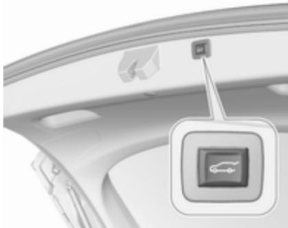
4. Натисніть і утримуйте кнопку на внутрішній стороні відкритих дверей багажного відділення протягом трьох секунд.
