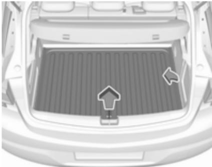
Кришка полика в задній частині автомобіля знімається. Перед зняттям кришки полика в задній частині автомобіля підніміть її та трохи поверніть з одного боку.
