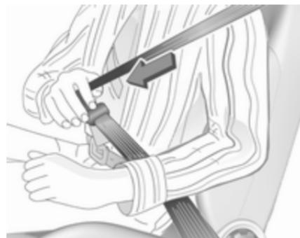
Витягніть пасок із натягувача, протягніть його через тіло та вставте язичок защіпки в пряжку. Регулярно посилюйте щільність поясного паска безпеки під час водіння, натягуючи плечовий пасок.
