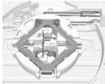
Домкрат, буксирна серга, ремінець для закріплення пошкодженого колеса та інструменти зберігаються в скриньці з інструментами під запасним колесом. Запасне колесо  $\diamond$  309.
