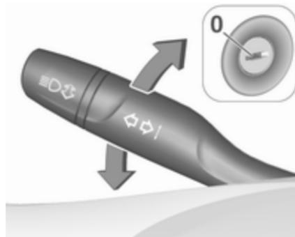
Під час паркування автомобіля можна активувати ліхтарі стоянкового освітлення з одного боку:
