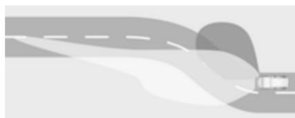
Для поліпшення освітлення під час поворотів вмикаються додаткові світлодіоди відповідно до кута повороту та швидкості автомобіля.
