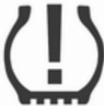
Розпізнавання стану тиску в шинах позначається контрольним індикатором  $\diamond 126$ .
