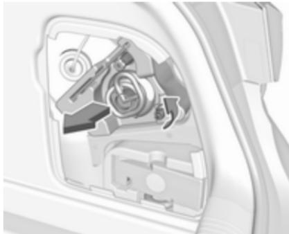
2. Автомобілі з комплектом для ремонту шин: Щоб замінити лампи з правого боку, спочатку відкрутіть пластикову гайку і вийміть вставку з пляшкою з ущільнювачем.
