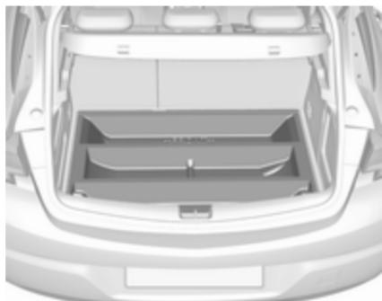
У багажнику розміщується ящик для зберігання речей. Зніміть кришку, щоб дістатися до ящика для зберігання речей. Кришка полика для розміщення багажу в задній частині автомобіля ⌈ 89.
