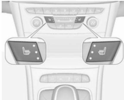
Відрегулюйте підігрів до потрібного значення, натиснувши для відповідного сидіння один або кілька разів. Контрольний індикатор у кнопкі вказує параметр. Людям із чутливою шкірою не рекомендується використовувати найвищий рівень підігріву протягом тривалого періоду.
