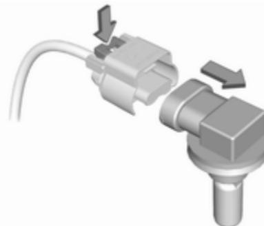
2. Від'єднайте патрон від з'єднувача, натискаючи на вушко фіксатора.
