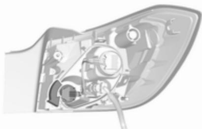
У модифікаціях зі світлодіодними задніми ліхтарями й світлодіодними стоп-сигналами замінювати можна лише лампу вказівника повороту: поверніть патрон лампи й вийміть його з блоку ліхтаря. Замініть лампу в патроні.
