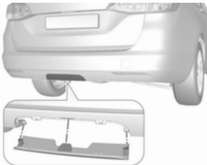
У моделі з кузовом "універсал" встановіть кришку на задній бампер, як показано на рисунку.
