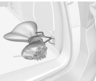
Покладіть кульовий зчіпний пристрій у чохол і закріпіть його ремінцем, протягнутим через праву задню петлю для кріплення. Обмотайте чохол ремінцем двічі та затягніть його.
