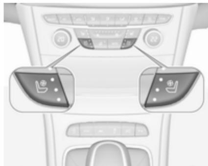
Відрегулюйте вентиляцію до потрібного рівня, натиснувши для відповідного сидіння один або кілька разів. Контрольний індикатор у кнопці вказує параметр.
