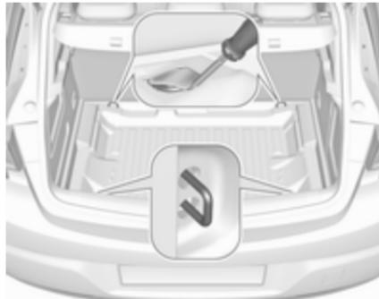
У автомобілях, укомплектованих набором для ремонту шин, передні вушка для кріплення знаходяться позаду задніх сидінь під кришкою полика. Щоб отримати доступ до вушок для кріплення, відкрийте перфоровані частини кришки за допомогою викрутки. Інструменти автомобіля → 293.
