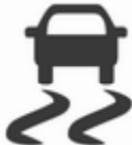
Електронна система курсової стійкості (ESC) переводиться в робочий стан після кожного запуску двигуна, як тільки згасне індикатор
