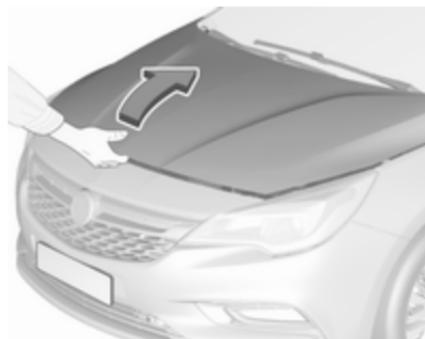
Зсуньте запобіжну защіпку до лівого боку автомобіля і відкрийте капот.
