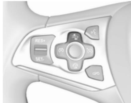
Коли кнопка натискається вперше, у центрі інформації для водія відображається поточне значення. При повторних натисканнях це значення змінюється. Виbrane значення діє до наступної зміни. Завчасність попередження залежить від швидкості автомобіля. Чимвища швидкість, тим на більшій дистанції спрацює функція попереджень. При виборі завчасності попереджень слід враховувати умови дорожнього руху та погодні умови.
