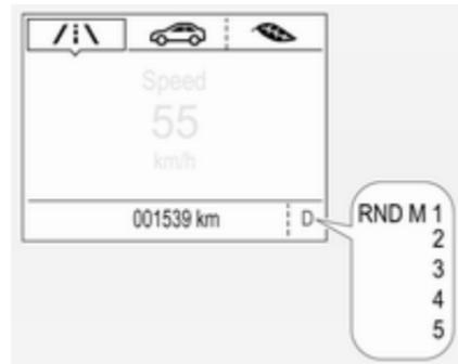
В автоматичному режимі програма керування автомобілем позначається за допомогою **D** в інформаційному центрі водія.
