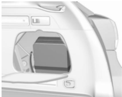
У моделях із кузовом "універсал" комплект для ремонту шин зберігається в сумці, розміщенні праворуч за кришкою в багажному відділенні. Сумка закріплена за допомогою ремінця.
