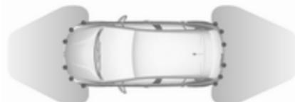
Розширення допомоги при паркуванні завжди поєднується із системою допомоги під час паркування переднім й заднім ходом. Обидві системи використовуються ті самі датчики на передньому та задньому бампері.
