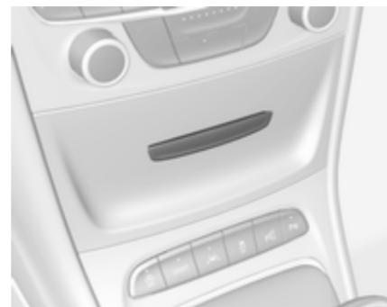
Рознім живлення (PowerFlex) приєднано до кришки блоку запобіжників панелі приладів. До розніму живлення можна підключити ароматизатор повітря (AirWellness) або тримач телефону.
