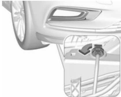
1. Поверніть патрон лампи проти годинникової стрілки та вийміть його з корпусу рефлектора.
