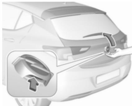
5-дверна модель з кузовом "хетчбек": щоб відкрити двері багажного відділення, натисніть сенсорний вимикач під емблемою фірми.
