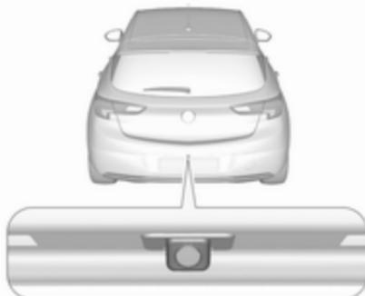
У 5-дверній моделі з кузовом "хетчбек" камера встановлюється між ліхтарями освітлення номерного знака.
