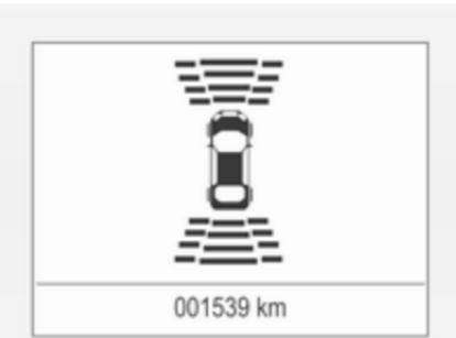
Вказування відстані може перериватися повідомленнями системи автомобіля з вищим пріоритетом. Після вимкнення повідомлення відстань відображатиметься знову.
