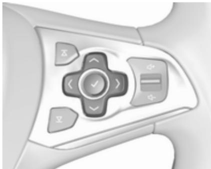
На дисплеї вищого рівня виберіть меню **Інфо** за допомогою кнопок на кермі, а потім виберіть сторінку допоміжної системи визначення дорожніх знаків за допомогою або 129.
