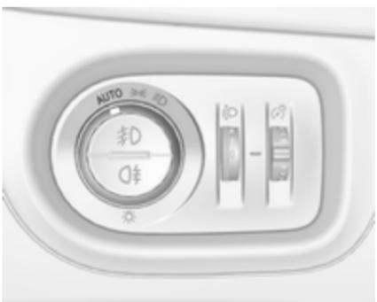
Коли функцію автоматичного керування освітленням увімкнено, а двигун працює, система автоматично перемикається на режим освітлення при денному світлі або на режим увімкнення
