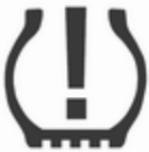
Розпізнавання стану тиску в шинах позначається контрольним індикатором  $\diamond 127$ .
