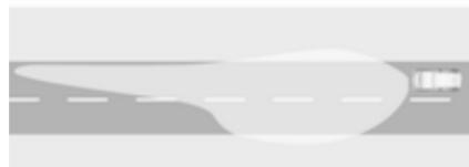
Вмикається автоматично під час руху в сільській місцевості, коли швидкість перевищує 55 км/год. Попідшене освітлення смуги руху та узбіччя дороги. Не засліплює водіїв автомобілів, які рухаються попереду або а протилежному напрямку.
