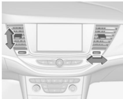
Щоб відкрити повітропровід, поверніть колесо регулятора в напрямку символу більшого розміру
