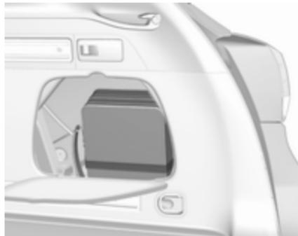
У моделях із кузовом "універсал" комплект для ремонту шин зберігається в сумці, розміщений праворуч за кришкою в багажному відділенні. Сумка закріплена за допомогою ремінця.
