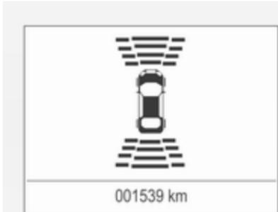
Вказування відстані може перериватися повідомленнями системи автомобіля з вищим пріоритетом. Після вимкнення повідомлення відстань відображатиметься знову.
