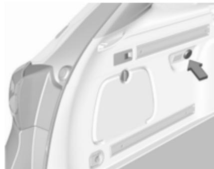
Модель з кузовом "універсал": Розетка з напругою 12 В розташована на лівій боковій стінці багажного відділення.
