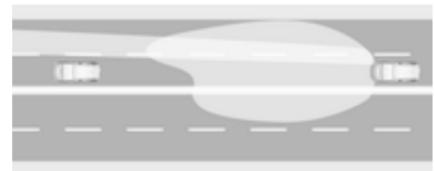
У системі керування дальнім світлом передбачено спеціальний режим для автомагістралей. Під час руху автомагістралю зі швидкістю понад 115 км/год світловий промінь зменшується для запобігання засліпленню водіїв зустрічних автомобілів. Під час руху за автомобілем або обгону відблиски у дзеркалах цих автомобілів послаблюються.
