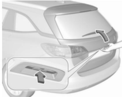
Щоб відкрити двері багажного відділення, натискайте сенсорний перемикач під молдингом, доки двері багажного відділення не почнуть рухатися. Коли автомобіль замкнений, електронний ключ має бути зовні автомобіля на відстані не більше одного метра від дверей багажного відділення.
