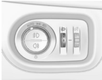
Щоб налаштувати діапазон освітлення фарами відповідно до навантаження автомобіля і запобігти засліпленню, виконайте такі дії: поверніть колесо регулятора в потрібне положення.
