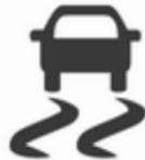
Протибуксовальна гальмівна система (ТС) переводиться в робочий стан після кожного запуску двигуна, як тільки згасне індикатор
