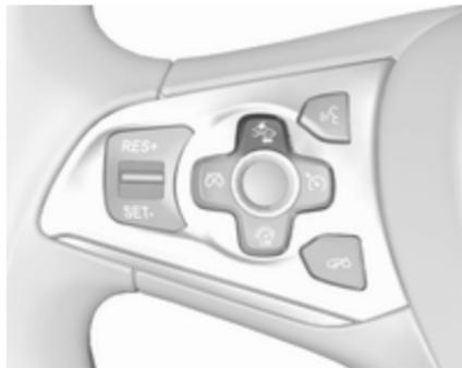
Коли кнопка натискається вперше, у центрі інформації для водія відображається поточне значення. При повторних натисканнях це значення змінюється. Вибране значення діє до наступної зміни. Завчасність попередження залежить від швидкості автомобіля. Чимвища швидкість, тим на більшій дистанції спрацює функція попереджень. При виборі завчасності попереджень слід враховувати умови дорожнього руху та погодні умови.
