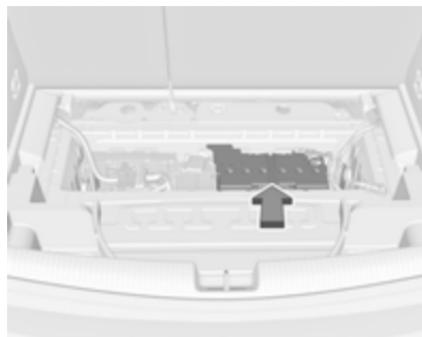
Автомобільний акумулятор знаходитьться в багажному відділенні позаду задніх сидінь під задньою кришкою підлоги. Задня кришка підлоги  $\diamond$  90.
