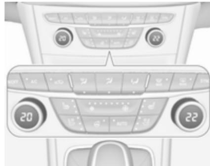
Встановіть температуру на бажане значення. Регулятор з боку пасажира регулює температуру з боку пасажира. Регулятор з боку водія може регулювати температуру з боку водія, а також температуру з обох боків, коли ввімкнено режим синхронізації **SYNC**.
