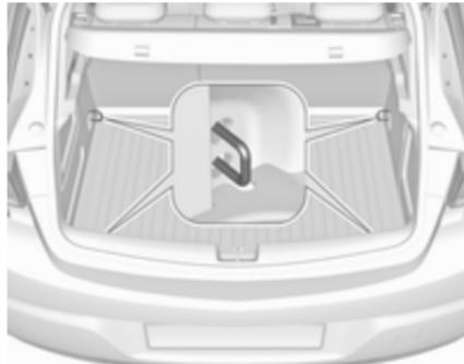
У автомобілях, укомплектованих запасним колесом, передні вушка для кріплення знаходяться на бічних стінках.
