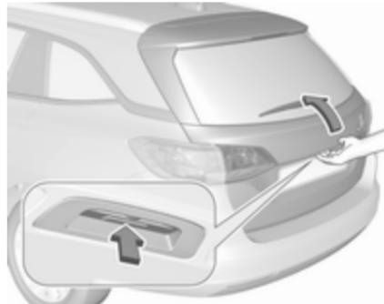
Після відмикання натисніть сенсорний вимикач під молдингом дверей багажного відділення й відчиніть їх вручну.
