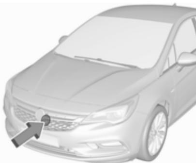
Датчик радара встановлено за радіаторною решіткою або нижче фірмового логотипу.
