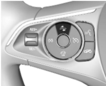
Коли кнопка натискається вперше, у центрі інформації для водія відображається поточне значення. При повторних натисканнях це значення змінюється. Вибране значення діє до наступної зміни. Завчасність попередження залежить від швидкості автомобіля. Чим вища швидкість, тим на більшій дистанції спрацює функція попереджень. При виборі завчасності попереджень слід враховувати умови дорожнього руху та погодні умови.
