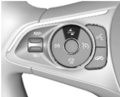
У автомобілях, оснащених передньою камерою, для вимкнення системи активного екстреного гальмування натисніть декілька разів вимикач , щоб встановити значення **Вимкнути**, 223. Після вимкнення в інформаційному центрі для водія з'явиться повідомлення.
