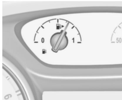
Залежно від поточного робочого режиму відображає інформацію про рівень пального в баку або вміст газу (CNG) в балоні.
