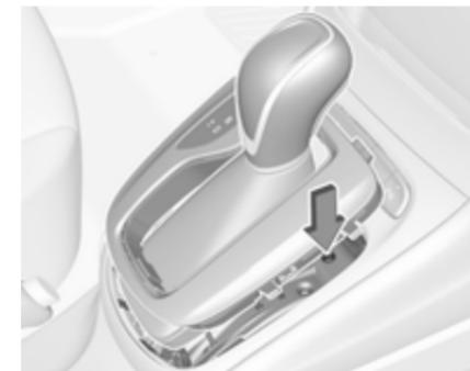
3. Вставте маленьку паличку (наприклад, ручку чи викрутку) в отвір біля важеля селектора. Натисніть на паличку, тримаючи її вертикально, і зсуньте важіль селектора з положення **P**. Якщо знову вибрати цю передачу, важіль селектора знову буде заблоковано. Для усунення переривання живлення зверніться до майстерні.
