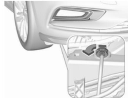
1. Поверніть патрон лампи проти годинникової стрілки та вийміть його з корпусу рефлектора.
