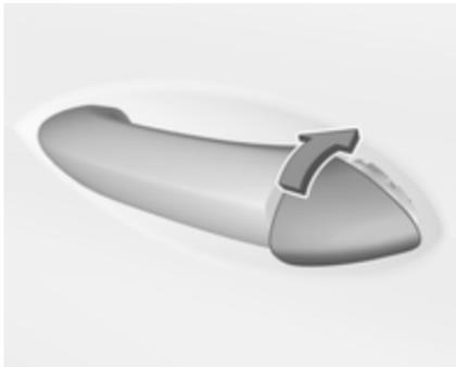
Після замикання закрійте отвір замка заглушкою: вставте заглушку нижнім боком у заглиблення, поверніть її притисніть, щоб закріпiti її з верхнього боку.
