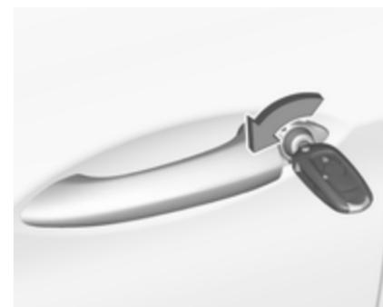
Вставте ключ в отвір замка і поверніть його, щоб відчинити дверцята водія вручну. Щоб відчинити інші дверцята, двічі потягніть за ручку з внутрішнього боку дверцят або натисніть на панелі дверцят водія. Багажне
