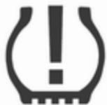
Розпізнавання стану тиску в шинах позначається контрольним індикатором  $\diamond 124$ .
