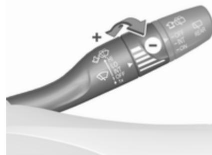
Важіль очисника в положенні **INT**. Поверніть колесо регулятора, щоб відрегулювати частоту промивання.
