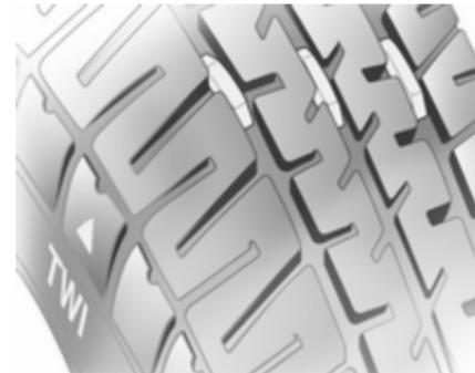
Мінімальна встановлена законодавством глибина малюнку протектора (1,6 мм) досягається, що зноситься протектор (про що свідчать індикатори зносу (TWI)). Положення цих індикаторів указано позначками на боковій частині.
