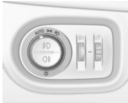
**AUTO** : система автоматичного регулювання освітлення автоматично перемикає освітлення при денному світлі на світло фар
