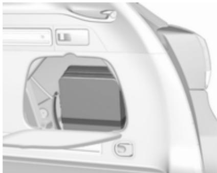
У моделях із кузовом "універсал" комплект для ремонту шин зберігається в сумці, розміщений праворуч за кришкою в багажному відділенні. Сумка закріплена за допомогою ремінця.
