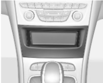
Комбіноване місце для зберігання речей та відділення для мобільного пристрою розміщене на центральній консолі панелі приладів.
