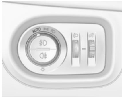
Коли функцію автоматичного керування освітленням увімкнено, а двигун працює, система автоматично перемикається на режим освітлення при денному світлі або на режим увімкнення
