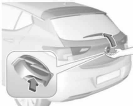
Відімкніть двері багажного відділення і відчиніть їх, натиснувши сенсорний вимикач під емблемою фірми.
