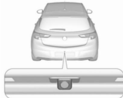
У 5-дверній моделі з кузовом "хетчбек" камера встановлюється між ліхтарями освітлення номерного знака.
