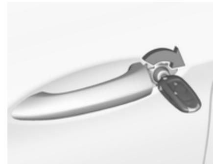
Натисніть кнопки дверних замків всіх дверцят, за винятком водійських або натисніть на панелі дверцят водія. Потім закройте дверцята водія і замкніть їх іззовні за допомогою ключа. Двері багажного відділення і
