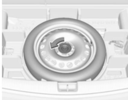
2. Запасне колесо зафіксоване крильчастою гайкою. Відкрутіть гайку і вийміть запасне колесо. Під запасним колесом знаходиться скринька з інструментами.
