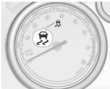
Електронна система курсової стійкості (ESC) переводиться в робочий стан після кожного запуску двигуна, як тільки згасне індикатор
