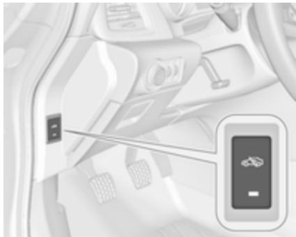
Вимикайте функцію моніторингу пасажирського відділення та нахилу автомобіля у випадках, коли в автомобілі залишаються тварини. Інакше високооб'ємні ультразвукові сигнали або рух тварини можуть спричинити спрацювання сигналізації. Вимикайте цю функцію також у випадках, коли автомобіль перебуває на поромі чи потязі.
