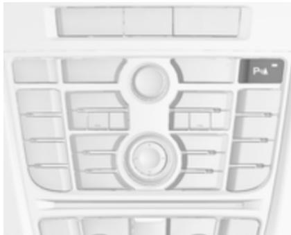
Передню та задню систему допомоги під час паркування обладнано кнопкою  $P\triangle$ . Якщо автомобіль додатково обладнано вдосконаленою системою допомоги під час паркування, система обладнується кнопкою  $\triangle P$ . Окремий опис наводиться далі в тексті. В обох випадках обидві системи керуються за допомогою кнопки  $\triangle P$ .
