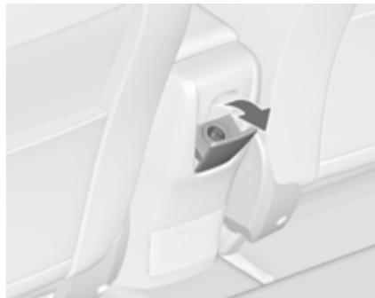
Ще одна розетка з напругою 12 В розташована в задній панелі. Складіть кришку вниз.
