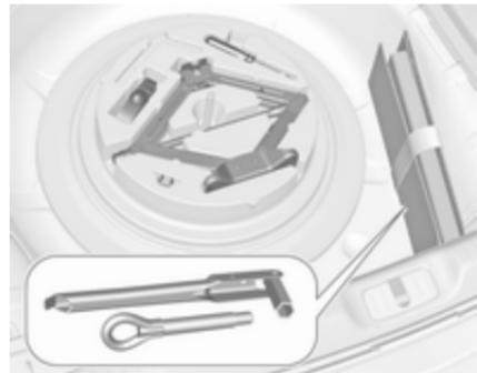
Під запасним колесом розміщені ящик та сумка з інструментами для автомобіля.
