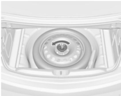
3. Запасне колесо закріплене в заглибленні підлоги крильчастою гайкою. Відкрутіть гайку, зніміть конус і витягніть запасне колесо.
