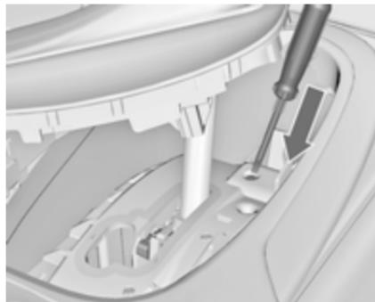
3. Вставте викрутку в отвір до кінця та перемістіть важіль селектора з положення **P** або **N**. У разі повторного вибору **P** або **N** важіль селектора буде знову заблоковано в положенні. Для усунення переривання живлення зверніться до майстерні.
