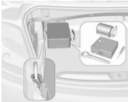
Деякі інструменти та буксирна провушина складені разом із комплектом для ремонту шин у сумці, яка кріпиться до переднього лівого кріпильного вушка в багажнику.
