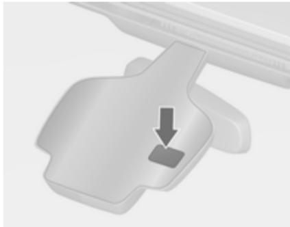
Підтримуйте чистоту датчика, запобігаючи потраплянню на нього пилу, бруду та льоду.
