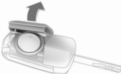
Розкладіть ключ і відчиніть блок. Замініть батарею (тип батареї CR 2032), звертаючи увагу на її положення під час встановлення. Зачиніть блок і здійсніть синхронізацію.
