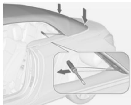
18. Сильно притисніть натяжну дугу вниз з обох боків. Одночасно повільно та поступово тягніть мотузку вперед, вставивши стержень викрутки у петлю. Для зручності можна взятися другою рукою за раму дверей.
