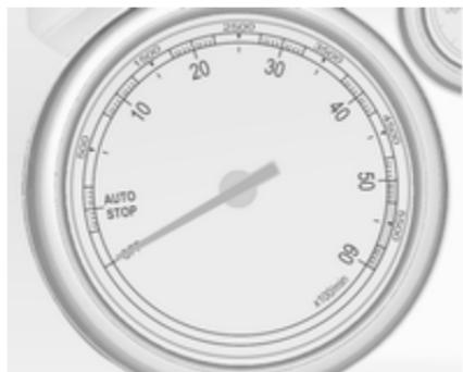
Указує швидкість роботи двигуна. Для економії пального вибираєте оптимальну кількість обертів двигуна для кожної передачі.
