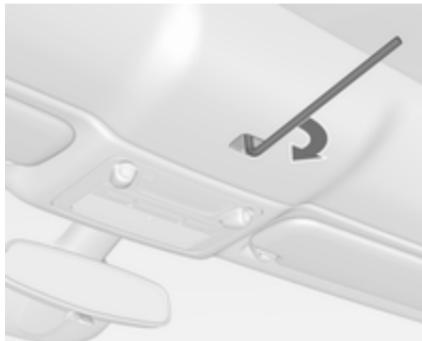
15. Вставте торцевий ключ із шестигранною голівкою 6 мм в отвір і заблокуйте защілку, повернувши торцевий ключ за годинниковою стрілкою до його крайнього положення.
