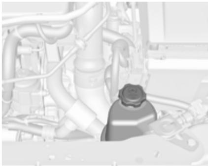
Рівень робочої рідини гідропідсилювача керма зазвичай не потрібно перевіряти. Якщо під час керування кермом чути незвичний шум або гідропідсилювач керма незвично реагує на керування, зверніться по допомозу на станцію технічного обслуговування.
