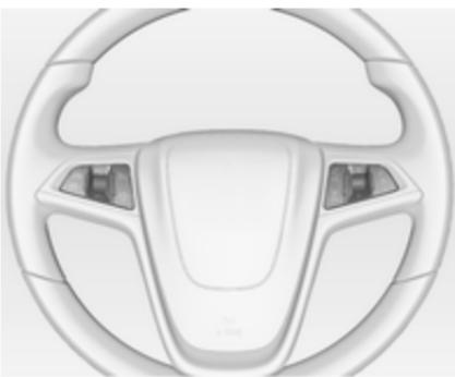
Інформаційно-розважальною системою, деякими допоміжними системами водія і підключенім мобільним телефоном можна керувати за допомогою засобів на кермі.
