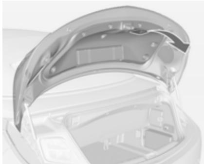
Користуйтесь внутрішньою ручкою. Не доторкайтесь до фірмового логотипу під час закривання, оскільки це приведе до повторного відімкнення кришки багажника.
