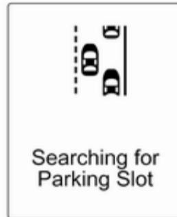
Поки автомобіль із активованою системою допомоги рухається вздовж ряду машин, вдосконалена система допомоги під час паркування здійснює пошук місця для паркування. При розпізнанні підходящого місця надаються візуальні та акустичні сигнали в інформаційному центрі водія.
