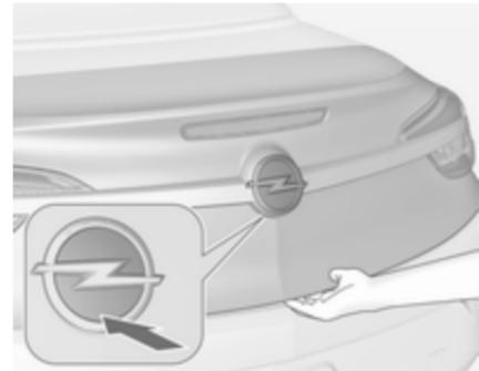
Щоб відчинити кришку багажника, натисніть на нижню частину фірмового логотипу.
