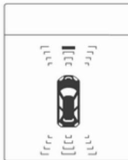
Позначення дистанції в інформаційному центрі водія може перекриватися повідомленнями автомобіля, що мають вищий пріоритет. Після підтвердження повідомлення кнопкою **SET/CLR** на підкермовому перемикачі поворотів, значення дистанції з'являється знову.
