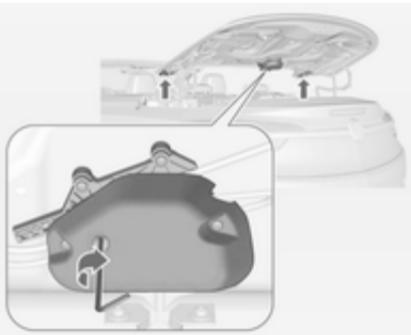
6. Вставте торцевий ключ із шестигранною голівкою 4 мм в позначеному положенні привода відкидання даху. Поверніть торцевий ключ за годинниковою стрілкою до кінця так, щоб бокові кожухи повернулися всередину.
