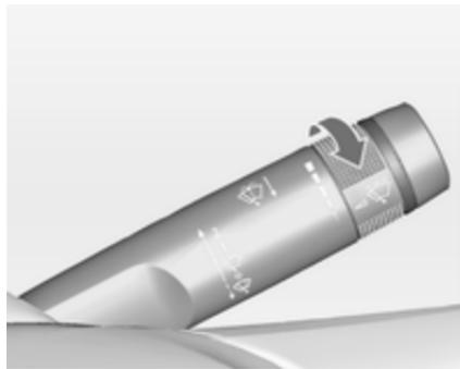
Поверніть колесо регулятора, щоб відрегулювати чутливість:
