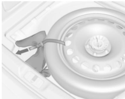
Сумка з причіпним пристроєм розміщується поряд із запасним колесом під кришкою підлоги багажника.
