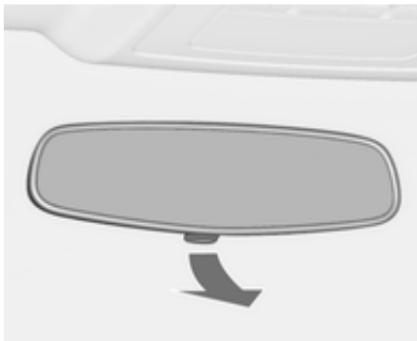
Щоб зменшити засліплювальну дію світла, поверніть важіль на зворотному боці корпусу дзеркала. Внутрішнє дзеркало  $\diamond$  33, внутрішнє дзеркало із системою автоматичного зменшення засліплюючої дії світла  $\diamond$  34.
