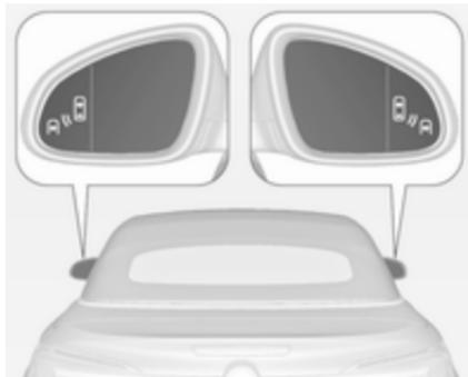
Система попереджування про об'єкти в мертвій зоні діє при швидкостях від 10 км/год до 140 км/год. В разі перевищення швидкості 140 км/год система вимикається, про що свідчиме слабке підсвічування попереджуvalьних символів
