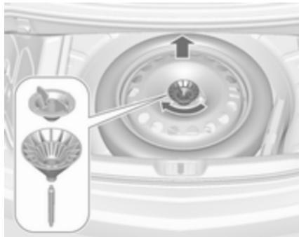
5. Вставте ексцентричний конус у заглиблення в запасному колесі та поверніть його так, щоб колесо змістилося якомога далі вперед. Закріпіть запасне колесо, закрутити крильчасту гайку проти годинникової стрілки.
