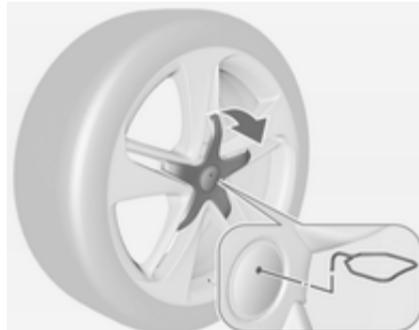
Легкосплавні диски з центральною кришкою болтів: Розблокуйте центральний ковпак, для цього вставте і потягніть за екстрактор  $\Phi$  223 у паз з фірмовим логотипом.
