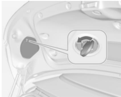
1. Відкрийте та знімте кришку на внутрішній панелі кришки багажника, відкрутивши гвинт монетою.
