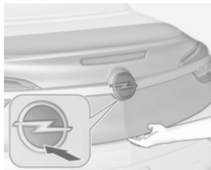
Щоб відкрити кришку багажника, натисніть кнопку на пульті дистанційного керування або після його відмкнення натисніть на нижню частину фірмового логотипу.
