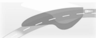
Пучок світла повертається відповідно до кута керма та швидкості, покращуючи освітлення на поворотах.
