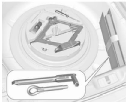
Відкрийте кришку підлоги багажника. Домкрат, інструменти та ремінець для закріплення пошкодженого колеса зберігаються в інструментальному ящику нижче запасного колеса в багажному відділенні. Колісний ключ і буксирна провушина
