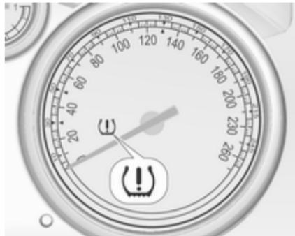
Розпізнавання стану тиску в шинах позначається контрольним індикатором (!
