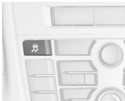
Для агресивнішої їзди системи ESC та TC можна вимкнути окрім одної від одної:
