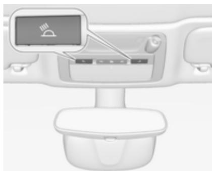
Для керування використовуються кнопки та на панелі керування освітленням, що вмикається під час відчинення дверей.
