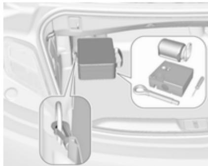
В іншій моделі сумка з комплектом для ремонту шин прикріплюється до лівого заднього кріпильного вушка в багажнику.
