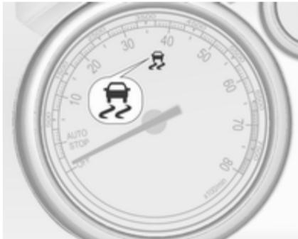
Протибуксовальна гальмівна система (TC) переводиться в робочий стан після кожного запуску двигуна, як тільки згасне індикатор  $\text{»}$ .
