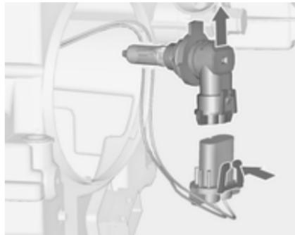
3. Від'єднайте тримач від з'єднувача, натиснувши закріплювач.
