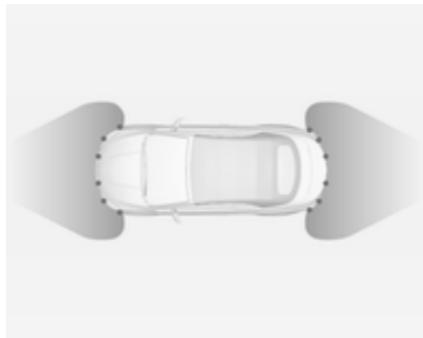
Вдосконалена система допомоги під час паркування відображує в інформаційному центрі водія інструкції та відтворює звукові сигнали, керуючись якими водій може припаркуватися в належному місці. Водієві потрібно керувати
