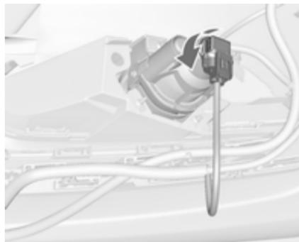
1. Поверніть патрон лампи проти годинникової стрілки та вийміть його з рефлектора.
