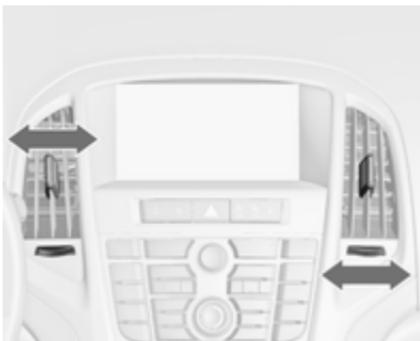
Щоб відкрити повітропровід, поверніть колесо регулятора в напрямку символу більшого розміру
