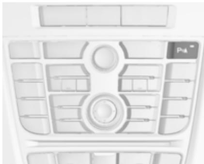
Систему можна також вимкнути вручну коротким натисненням кнопки системи допомоги під час паркування **P** чи **R**.
