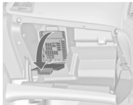
В автомобілях для правостороннього руху коробка запобіжників розташована за кришкою в бардачку. Відкрийте бардачок, після цього відкрийте кришку та складіть її.
