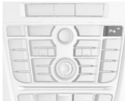
Система автоматично вимикається після вимкнення задньої передачі.
