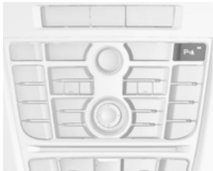
Передню та задню систему допомоги під час паркування обладнано кнопкою **P $\uparrow\downarrow$** . Якщо автомобіль додатково оснащений вдосконаленою системою допомоги під час паркування, в системі є кнопка  **$\Delta$** . Окремий опис наведено далі. В цьому разі керування обома системами здійснюється кнопкою  **$\Delta$** .
