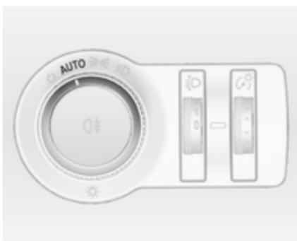
Коли функція автоматичного регулювання освітлення ввімкнута і двигун працює, ця система автоматично змінює режим освітлення при денному світлі та режим увімкнення фар відповідно до стану зовнішнього освітлення та інформації від системи датчиків дощу.
