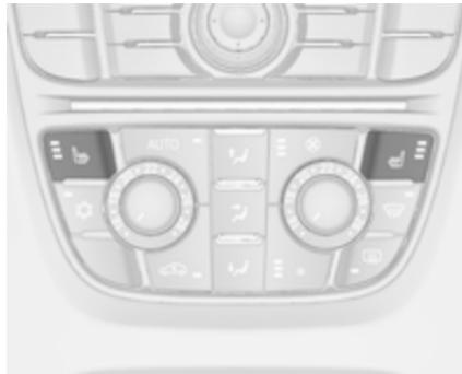
Відрегулюйте підігрів до потрібного параметра натисканням кнопки для відповідного сидіння один або декілька разів. Світлодіоди у кнопкі вказують на вибраний параметр.
