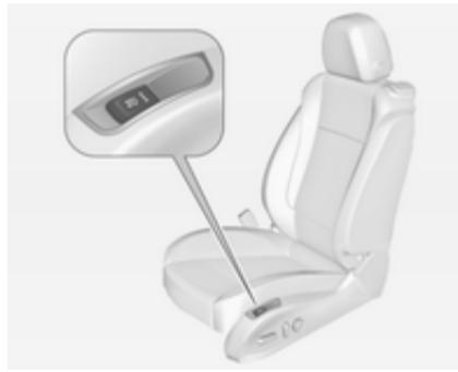
Відрегулюйте інтенсивність вентиляції до потрібного значення кнопкою для відповідного сидіння один або кілька разів.
