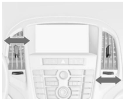
Щоб відкрити повітропровід, поверніть колесо регулятора в напрямку символу більшого розміру ■. Відрегулюйте потік повітря, що надходить через повітропровід, повертаючи колесо регулятора в потрібне положення.
