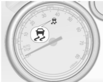
Протибуксувальна гальмівна система (ТС) переводиться в робочий стан після кожного запуску двигуна, як тільки згасне індикатор
