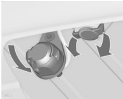
Відключіть та складіть розетку. Вийміть ущільнювальну пробку з отвору для причіпного пристрою та покладіть її для зберігання.
