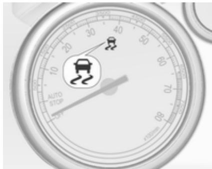
Електронна система курсової стійкості (ESC) переводиться в робочий стан після кожного запуску двигуна, як тільки згасне індикатор  $\diamond$ .
