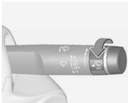
Поверніть колесо регулятора, щоб відрегулювати чутливість:
