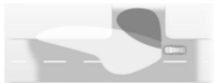
На поворотах з обмеженою видимістю або під час виконання повороту, залежно від кута чи ввімкненого сигналу повороту, ліворуч або праворуч вмикається додатковий рефлектор, який освітлює дорогу в напрямку руху під відповідним кутом. Активується на швидкості 40 км/год.
