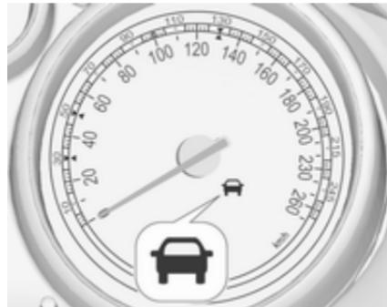
Про наявність автомобіля попереду сигналізує контрольний індикатор
