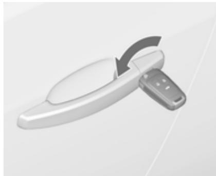
Розблокуйте вручну водійські дверцята за допомогою ключа. Увімкніть запалювання і натисніть кнопку центрального замка , щоб відімкнути дверцята водія, багажне відділення та кришку горловини паливного бака. Після ввімкнення запалювання система запобігання викраденню автомобіля дезактивується.
