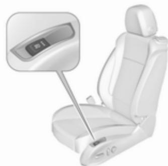
Відрегулюйте інтенсивність вентиляції до потрібного значення кнопкою для відповідного сидіння один або кілька разів.
