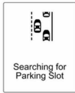
Поки автомобіль із активованою системою допомоги рухається вздовж ряду машин, вдосконалена система допомоги під час паркування здійснює пошук місця
