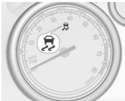
Електронна система курсової стійкості (ESC) переводиться в робочий стан після кожного запуску двигуна, як тільки згасне індикатор ⚡.
