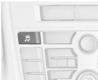
Протибуксувальну гальмівну систему (TC) можна вимкнути, коли потрібне пробуксовування ведучих коліс.
