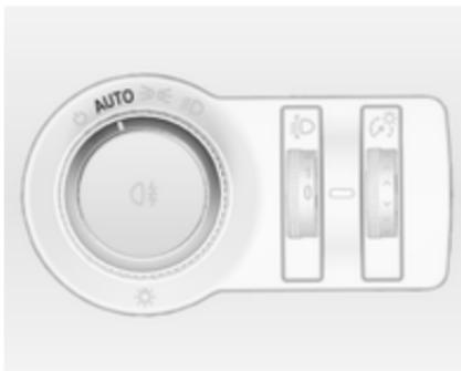
Коли функція автоматичного регулювання освітлення ввімкнута і двигун працює, ця система автоматично змінює режим освітлення при денному свіtlі та режим увімкнення фар відповідно до стану зовнішнього освітлення та інформації від системи датчиків дощу.
