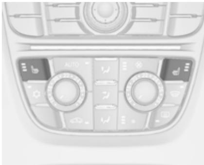
Відрегулюйте підігрів до потрібного параметра натисканням кнопки для відповідного сидіння один або декілька разів. Світлодіоди у кнопці вказують на вибраний параметр.
