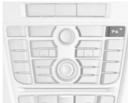
Система автоматично вимикається після вимкнення задньої передачі. Щоб увімкнути систему знову, увімкніть задню передачу.
