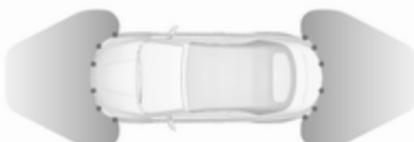
Розширенена система допомоги під час паркування показує інструкції в центрі інформації для водія та видає звукові сигнали, керуючись якими водій може запаркувати автомобіль в належному місці. Водій має керувати кермом, а також, прискоренням, гальмуванням, та перемиканням передач.
