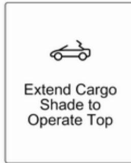
Якщо перегородка багажника розкладена не повністю і не відкрита відкидна кришка отвору для довгих предметів за задніми сидіннями, при натисненні перемикача відкривання м'якого верху пролунає попереджувальний звуковий сигнал, а в інформаційному центрі для водія з'явиться повідомлення.
