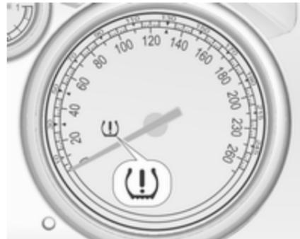
Розпізнавання стану тиску в шинах позначається контрольним індикатором  $\diamond 102$ .
