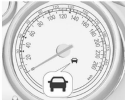
Про наявність автомобіля попереду сигналізує контрольний індикатор
