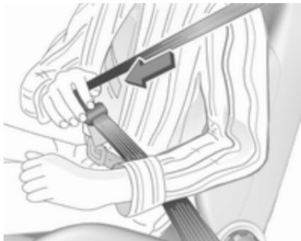
Витягніть пасок із переднатягувача, протягніть його через тіло та вставте язичок защіпки в пряжку. Регулярно посилюйте щільність поясного паска безпеки під час водіння, натягуючи плечовий пасок.
