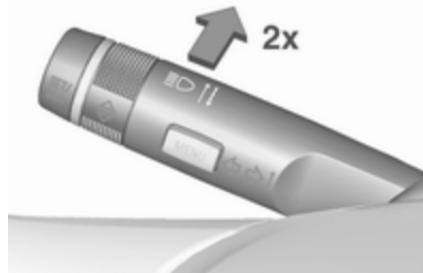
Функції розумного регулювання дальноті освітлення та автоматичного ввімкнення дальнього світла вмикаються одночасно шляхом подвійного натискання на важіль індикатора. Вони можуть вмикатися при ввімкненому запаленні.
