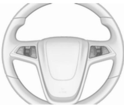
Інформаційно-розважальною системою, деякими допоміжними системами водія і підключенім мобільним телефоном можна керувати за допомогою засобів на кермі.
