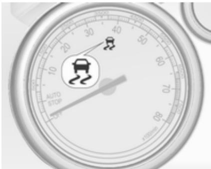
Протибуксувальна гальмівна система (TC) переводиться в робочий стан після кожного запуску двигуна, як тільки згасне індикатор
