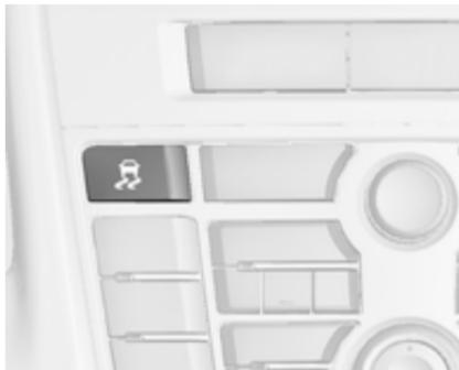
Для агресивнішої їзди системи ESC та TC можна вимкнути окремо одна від одної:
