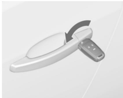
Розблокуйте вручну водійські дверцята за допомогою ключа. Увімкніть запалювання і натисніть кнопку центрального замка , щоб відмкнути дверцята водія, багажне відділення та кришку заливної горловини паливного баку.
