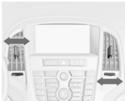
Щоб відкрити повітропровід, поверніть колесо регулятора в напрямку символу більшого розміру ▲. Відрегулюйте потік повітря, що надходить через повітропровід, повертуючи колесо регулятора в потрібне положення.
