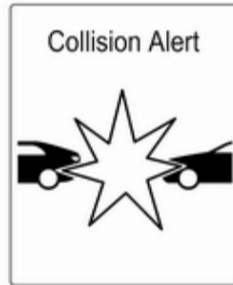
Якщо автомобіль, що рухається попереду, наближається занадто швидко, пролунає попередкувальний звуковий сигнал, і в інформаційному центрі водія (DIC) з'явиться попередження.
