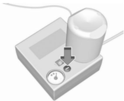
14. Зніміть набір для ремонту шин. Натисніть пристрій захоплення на кронштейні, щоб зняти корпус ущільнювача з кронштейна. Прикрутіть шланг для накачування шин до вільного місця під'єднання корпусу ущільнювача. Це
