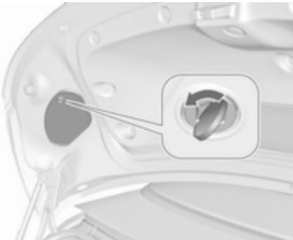
1. Відкрийте та зніміть кришку на внутрішній панелі кришки багажника, відкрутивши гвинт монетою.
