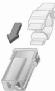
Установіть знімач запобіжника на різні типи запобіжників зверху чи збоку та витягніть запобіжник.
