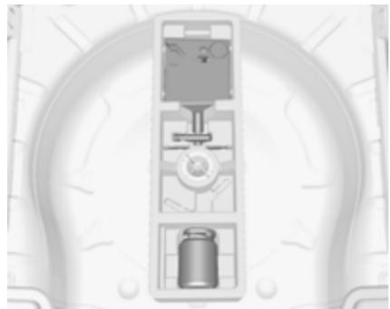
Деякі інструменти, а також буксирна провушина зберігаються разом із комплектом для ремонту шин у ящику для інструментів під килимком у багажному відділенні.
