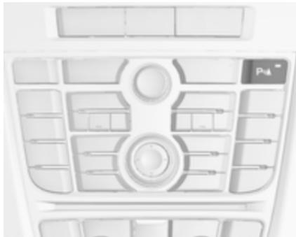
Передню та задню систему допомоги під час паркування обладнано кнопкою **P/▲**. Якщо автомобіль додатково оснащений вдосконаленою системою допомоги під час паркування, в системі є кнопка **■P/▲**. Окремий опис наведено далі. В цьому разі керування обома системами здійснюється кнопкою **■P/▲**.
