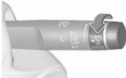
Поверніть колесо регулятора, щоб відрегулювати чутливість:
