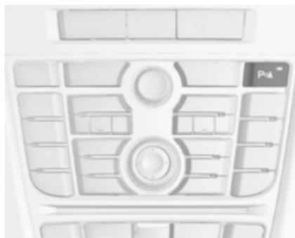
Систему можна також вимкнути вручну коротким натисненням кнопки системи допомоги під час паркування **P**
