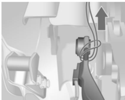
10. Обмотайте приєднані мотузки навколо позначок на шарнірах з обох боків, а потім протягніть кінець мотузки крізь петлю, як показано на малюнку.
