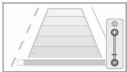
**Navi 650/Navi 950:** щоб відрегулювати яскравість, натисніть, а потім поверніть зовнішнє кільце багатофункціонального регулятора.
