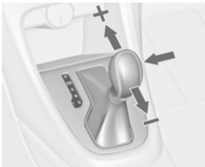
Для переходу на ручний режим **D**, переведіть важіль селектора з положення **M** ліворуч.
