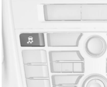
Протибуксувальну гальмівну систему (ТС) можна вимкнути, коли потрібне пробуксовування ведучих коліс.
