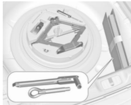
Під запасним колесом розміщені ящик та сумка з інструментами для автомобіля.
