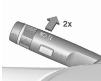
Функції розумного регулювання дальності освітлення та автоматичного ввімкнення дальнього світла вмикаються одночасно шляхом подвійного натискання на важіль індикатора. Вони можуть вмикатися при ввімкненому запаленні.
