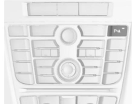
Для передньої та задньої системи допомоги під час паркування передбачено **P**⚠. Якщо автомобіль додатково оснащений розширеною системою допомоги під час паркування, для неї в системі встановлено **P**⚠. Окремий опис наведено далі. Обома системами можна керувати, натискаючи **P**⚠.
