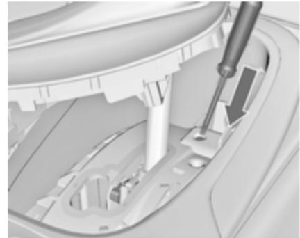
3. Вставте викрутку в отвір до кінця та перемістіть важіль селектора з положення **P** або **N**. У разі повторного вибору **P** або **N** важіль селектора буде знову заблоковано в положенні. Для усунення переривання живлення зверніться до майстерні.
