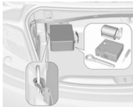
Деякі інструменти та буксирна провущина складені разом із комплектом для ремонту шин у сумці, яка кріпиться до переднього лівого кріпильного вушка в багажнику.
