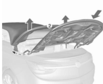
16. Підніміть натяжну дугу (2) м'якого верху з обох боків. Підніміть кришку відсіку для м'якого верху приблизно наполовину, повільно натискаючи на неї, а потім відпустіть, щоб вона посунулася в закрите положення.
