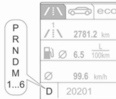
Режим або вибрана передача відображаються на дисплеї трансмісії.
