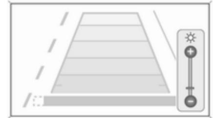
**Navi 650/Navi 950:** щоб відрегулювати яскравість, натисніть, а потім поверніть зовнішнє кільце багатофункціонального регулятора.
