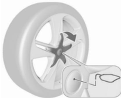
Легкосплавні диски з центральною кришкою болтів: Розблокуйте центральний ковпач, для цього вставте і потягніть за екстрактор ⇨ 236 у паз з фірмовим логотипом.
