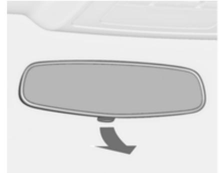
Щоб зменшити засліплювальну дію світла, поверніть важіль на зворотному боці корпусу дзеркала. Внутрішнє дзеркало ⇨ 34.
