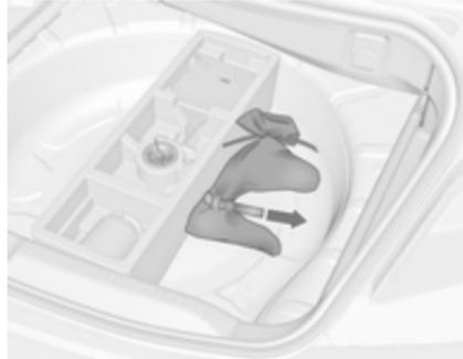
Сумка з причіпним пристроєм розміщується поряд із коробкою з комплектом для ремонту шин під кришкою підлоги багажника.
