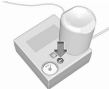
Якщо протягом 10 хвилин вказаного рівня тиску не досягнуто, вийміть набір для ремонту шин. Пересуньте автомобіль на один оберт шини. Повторно під'єднайте набір для ремонту шин і продовжуйте
