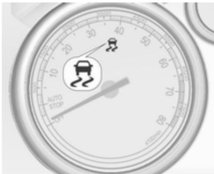
Електронна система курсової стійкості (ESC) переводиться в робочий стан після кожного запуску двигуна, як тільки згасне індикатор
