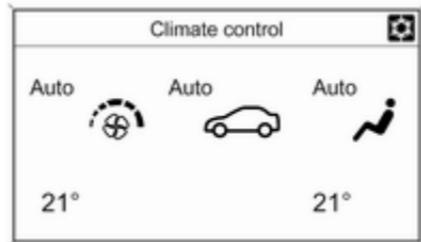
Налаштування клімат-контролю відображаються на графічному інформаційному дисплеї або (залежно від версії) - на кольоровому інформаційному дисплеї. Налаштування модифікацій відображаються у вигляді коротких спливаючих повідомлень на обох дисплеях, поверх поточного меню.
