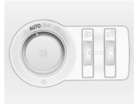
Коли функція автоматичного регулювання освітлення увімкнута і двигун працює, ця система автоматично змінює режим освітлення при денному світлі та режим увімкнення фар відповідно
