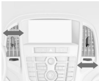
Щоб відкрити повітропровід, поверніть колесо регулятора в напрямку символу більшого розміру
