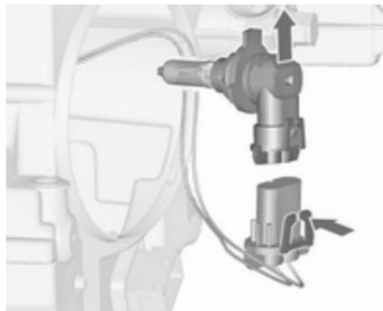
3. Від'єднайте тримач від з'єднувача, натиснувши закріплювач.
