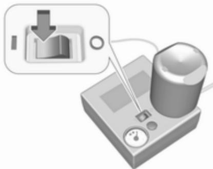
10. Установіть кулісний перемикач на компресорі в положення I. Шина наповнюється ущільнювачем.
