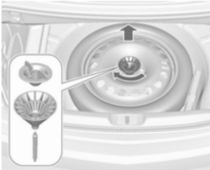
5. Вставте ексцентричний конус у заглиблення в запасному колесі та поверніть його так, щоб колесо змістилося якомога далі вперед. Закріпіть запасне колесо, закрутивши крильчасту гайку проти годинникової стрілки.
