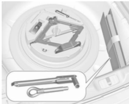
Відкрийте кришку підлоги багажника. Домкрат, інструменти та ремінець для закріплення пошкодженого колеса зберігаються в інструментальному ящику нижче запасного колеса в багажному відділенні. Колісний ключ і буксирна провущина зберігаються в сумці для інструментів, розміщеній у ніші для
