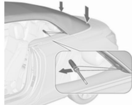
18. Сильно притисніть натяжну дугу вниз з обох боків. Одночасно повільно та поступово тягніть мотузку вперед, вставивши стержень викрутки у петлю. Для зручності можна взятися другою рукою за раму дверей.
