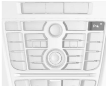
Систему можна також вимкнути вручну коротким натисненням кнопки системи допомоги під час паркування **P** з трикутником або **P** з трикутником.
