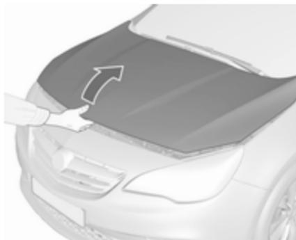
Зсуньте запобіжну заціпку до лівого боку автомобіля і відкрийте капот.
