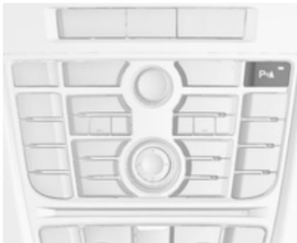
Система автоматично вимикається після вимкнення задньої передачі.
