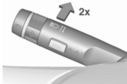
Система керування дальнім світлом вмикається при подвійному натисканні важеля індикатора на швидкості вище 40 км/г.
