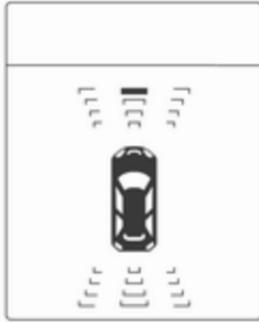
Відстань до перешкод попереду й позаду позначається зміною ліній відстані навколо автомобіля.
