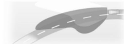
Пучок світла повертається відповідно до кута керма та швидкості, покращуючи освітлення на поворотах.
