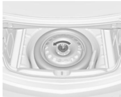
3. Запасне колесо закріплене в заглибленні підлоги крильчатою гайкою. Відкрутіть гайку, зніміть конус і витягніть запасне колесо.
