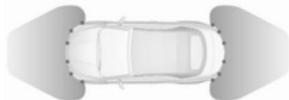
Розширена система допомоги під час паркування показує вказівки в інформаційному центрі водія та подає звукові сигнали, керуючись якими водій може припаркувати автомобіль у належному місці. Водій має керувати кермом, а також контролювати прискорення й гальмування та перемикання передач.
