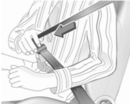
Витягніть пасок із переднягувача, протягніть його через тіло та вставте язичок защіпки в пряжку. Регулярно посилюйте щільність поясного паска безпеки під час водіння, натягуючи плечовий пасок.
