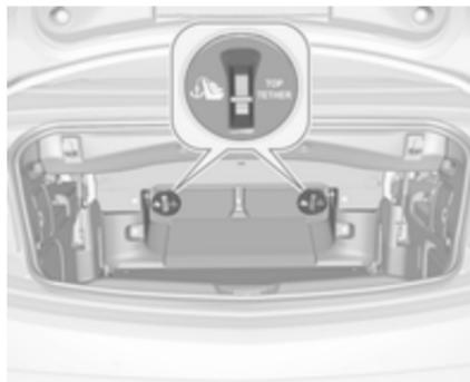
Крім кріплення ISOFIX, пристебніть ремінець кріплення Top-Tether до вушок кріплення Top-Tether на
