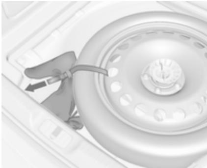
Сумка з причіпним пристроєм розміщується поряд із запасним колесом під кришкою підлоги багажника.
