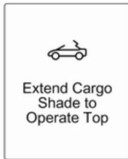
Якщо перегородка багажника розкладена не повністю і не відкрита відкидна кришка отвору для довгих предметів за задніми сидіннями, при натисненні перемикача відкриття м'якого верху пролунає попереджувальний звуковий сигнал, а в інформаційному центрі для водія з'явиться повідомлення.
