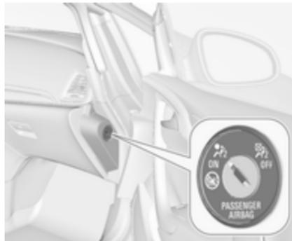
Систему подушок безпеки переднього пасажиратора можна дезактивувати за допомогою перемикача, що приводиться в дію ключем, справа на панелі інструментів.
