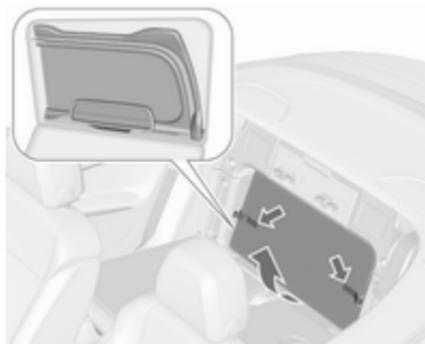
Автомобіль оснащено двома вітрозахисними обтічниками, які зберігаються в сумці за спинками задніх сидінь. Опустіть спинки
