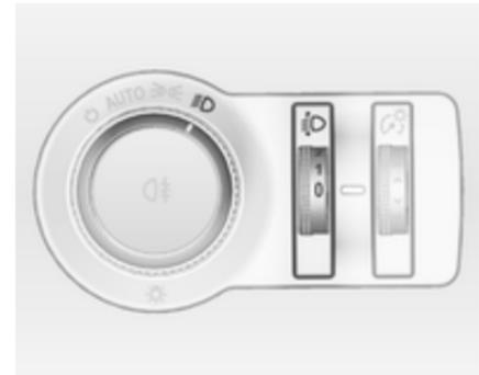
Щоб адаптувати діапазон освітлення фарами до навантаження автомобіля для запобігання засліпленню: поверніть колесо регулятора
