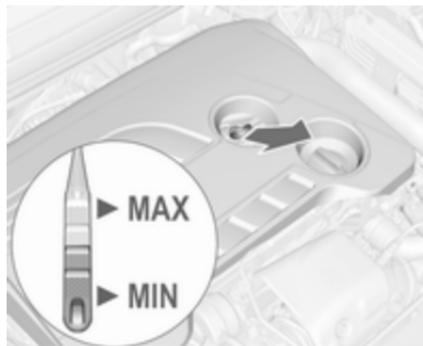
Залежно від варіанта двигуна використовуються різні щупи.
