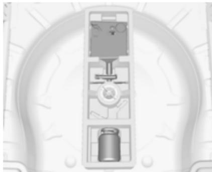
Деякі інструменти, а також буксирна провущина зберігаються разом із комплектом для ремонту шин у ящику для інструментів під килимком у багажному відділенні.
