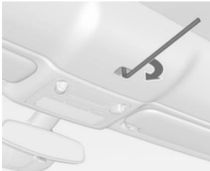
15. Вставте торцевий ключ із шестигранною голівкою 6 мм в отвір і заблокуйте заціпку, повернувши торцевий ключ за годинниковою стрілкою до його крайнього положення.
