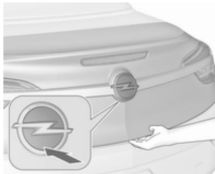
Щоб відчинити кришку багажника, натисніть на нижню частину фірмового логотипу.
