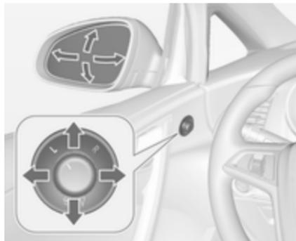
Виберіть потрібне зовнішнє дзеркало та відрегулюйте його. Випуклі зовнішні дзеркала ⇨ 32, електричне регулювання ⇨ 32, зовнішні дзеркала, що складаються ⇨ 33, зовнішні дзеркала з підігрівом ⇨ 33.
