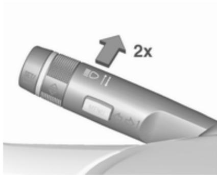
Система керування дальнім світлом вмикається при подвійному натисканні важеля перемикання сигналів повороту при швидкості понад 40 км/год.
