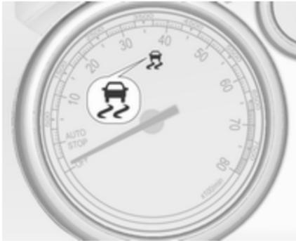
Протибуксувальна гальмівна система (ТС) переводиться в робочий стан після кожного запуску двигуна, як тільки згасне індикатор
