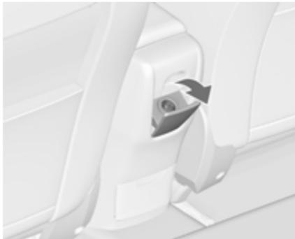
Ще одна розетка з напругою 12 В розташована в задній панелі. Складіть кришку вниз.
