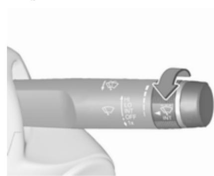
Поверніть колесо регулятора, щоб відрегулювати чутливість:
