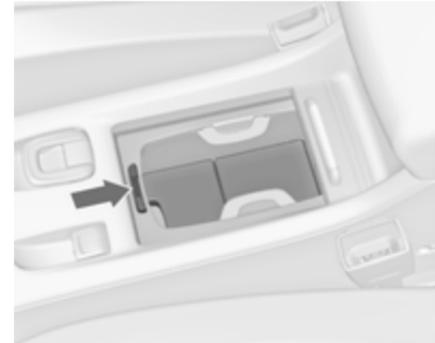
Натисніть на кнопку, щоб зняти корпус тримача для стаканів. Корпус можна зберігати в бардачку.
