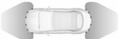
Розширена система допомоги під час паркування показує вказівки в інформаційному центрі водія та подає звукові сигнали, керуючись якими водій може припаркувати автомобіль у належному місці. Водій має керувати кермом, а також контролювати прискорення й гальмування та перемикання передач.
