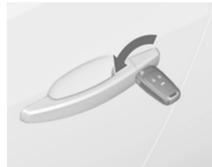
Розблокуйте вручну водійські дверцята за допомогою ключа. Увімкніть запалювання і натисніть кнопку центрального замка , щоб відімкнути дверцята водія, багажне відділення та кришку горловини паливного баку.
