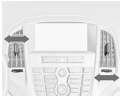
Щоб відкрити повітропровід, поверніть колесо регулятора в напрямку символу більшого розміру
