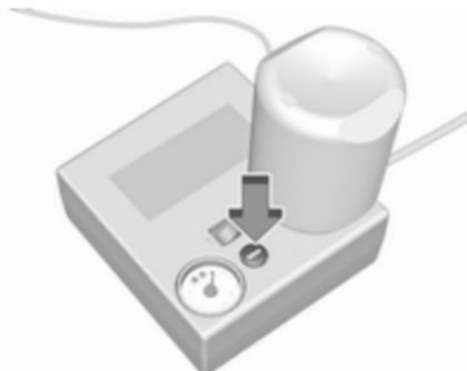
Якщо протягом 10 хвилин вказаного рівня тиску не досягнуто, вийміть набір для ремонту шин. Пересуньте автомобіль на один оберт шини. Повторно під'єднайте набір для ремонту шин і продовжуйте процедуру заповнення протягом 10 хвилин. Якщо вказаний тиск у шинах все ще не вдається отримати, це свідчить про серйозне пошкодження шини. Зверніться до допомогу до майстерні.
