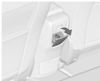
Ще одна розетка з напругою 12 В розташована в задній панелі.
