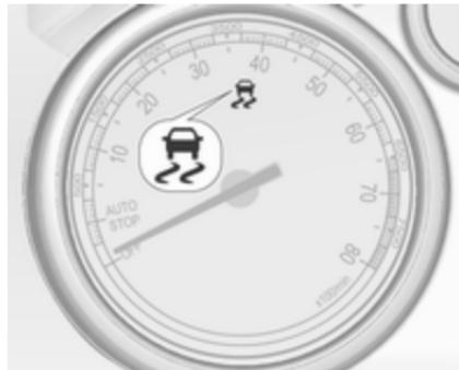
Електронна система курсової стійкості (ESC) переводиться в робочий стан після кожного запуску двигуна, як тільки згасне індикатор  $\Delta$ .
