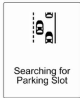
Поки автомобіль із активованою системою допомоги рухається вздовж ряду машин, вдосконалена система допомоги під час паркування здійснює пошук місця для паркування. Виявивши потрібне місце, система
