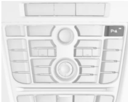
Для передньої та задньої системи допомоги під час паркування передбачено  $P\triangle$ . Якщо автомобіль додатково оснащений розширеною системою допомоги під час паркування, для неї в системі встановлено  $\triangle$ . Окремий опис наведено далі. Обома системами можна керувати, натискаючи  $\triangle$ .
