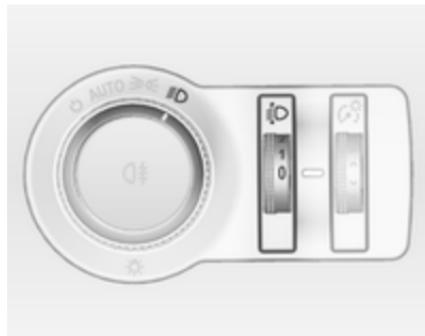
Щоб адаптувати діапазон освітлення фарами до навантаження автомобіля для запобігання засліпленню: поверніть колесо регулятора в потрібне положення.
