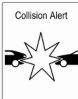
Якщо автомобіль, що рухається попереду, наближається занадто швидко, пролунає попереджувальний звуковий сигнал, і в інформаційному центрі водія (DIC) з'явиться попередження.
