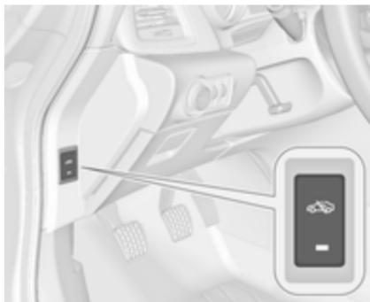
Вимикайте функцію моніторингу пасажирського відділення та нахилу автомобіля у випадках, коли, наприклад, в автомобілі залишаються тварини. Інакше потужні ультразвукові сигнали або рух тварин можуть спричинити спрацювання сигналізації. Вимикайте цю функцію також у випадках, коли автомобіль перебуває на поромі чи потязі.
