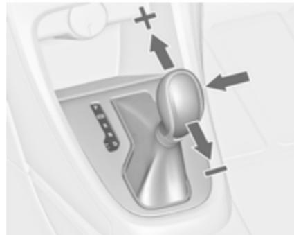
Для переходу на ручний режим **D**, переведіть важіль селектора з положення **M** ліворуч.
