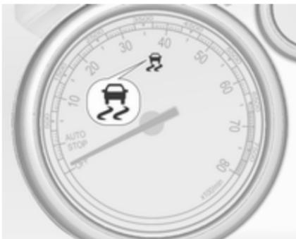
Протибуксувальна гальмівна система (TC) переводиться в робочий стан після кожного запуску двигуна, як тільки згасне індикатор  $\diamond$ .
