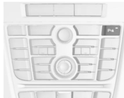
Система автоматично вимикається після вимкнення задньої передачі.
