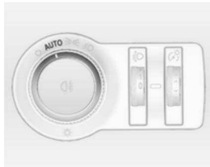
Коли функція автоматичного регулювання освітлення ввімкнута і двигун працює, ця система автоматично змінює режим освітлення при денному свіtlі та режим увімкнення фар відповідно
