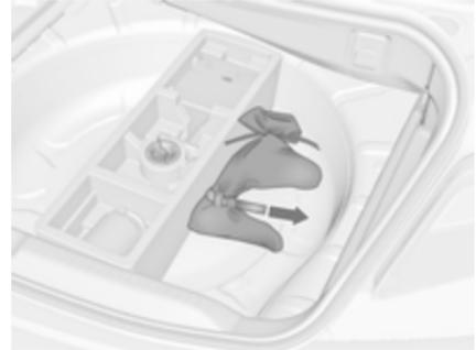
Сумка з причіпним пристроєм розміщується поряд із коробкою з комплектом для ремонту шин під кришкою підлоги багажника.
