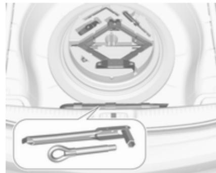
Відкрийте кришку підлоги багажника. Домкрат, інструменти та ремінець для закріплення пошкодженого колеса зберігаються в інструментальному ящику підлоги запасного колеса в багажному відділенні.
