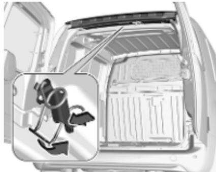
1. Натисніть на важіль і від'єднайте пружинний затискач від фіксатора, потягнувши за нього.
