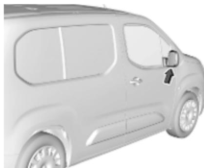
Ця камера встановлюється в нижній частині зовнішнього дзеркала зі сторони пасажира. Зображення з камери показується на дисплеї заднього виду ⌂ 127.
