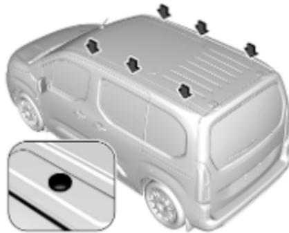
Щоб закріпити багажник на даху, відкрутіть кришки в накладних смугах на даху. Вставте елементи кріплення у фіксатор, дотримуючись вказівок.
