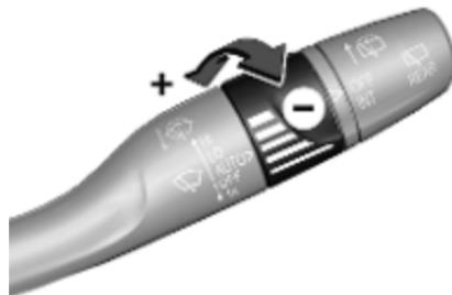
Поверніть колесо регулятора, щоб відрегулювати чутливість.
