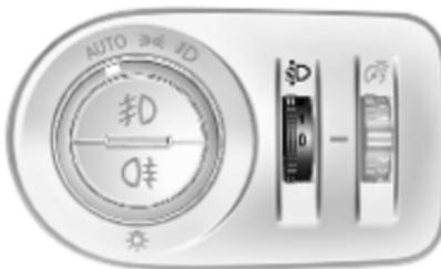
Щоб налаштувати діапазон освітлення фарами відповідно до навантаження автомобіля і запобігти засліпленню, виконайте такі дії: поверніть колесо регулятора в потрібне положення.
