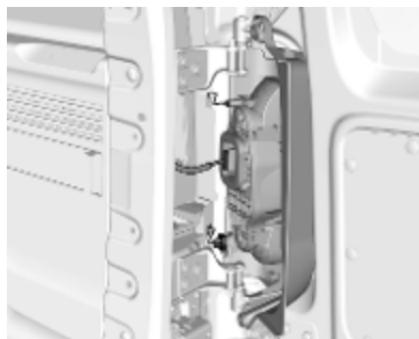
2. Обережно вийміть блок заднього ліхтаря з ніші та зніміть його. Будьте обережні, канал кабелю повинен залишатися на місці.
