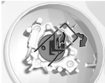
2. Від'єднайте пружинний затискач від фіксатора, перемістивши його вправо. Поверніть пружинний затискач донизу. Вийміть патрон лампи з корпусу рефлектора.
