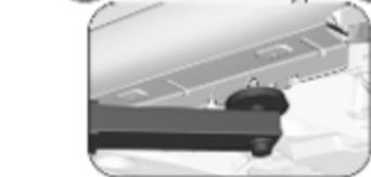
Розміщення заднього кронштейна підйомної платформи по центру під відповідною точкою встановлення домкрата.
