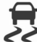
Системи ESC і TC готові до роботи після кожного запуску двигуна, як тільки згасне контрольний індикатор
