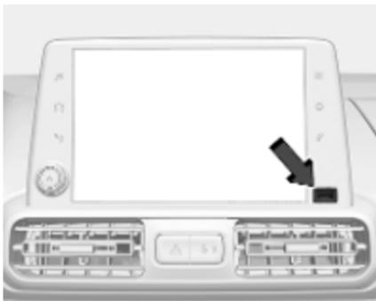
USB-порт розміщено на панелі приладів поруч з інформаційним дисплеєм.
