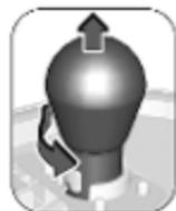
5. Відігніть затискач назад і потягніть за лампову панель, щоб від'єднати її від інших затискачів. Вставте нову лампу: Протитуманна фара (1)
