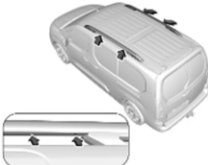
Точки кріплення розміщені в нижній частині поздовжньої дуги.
