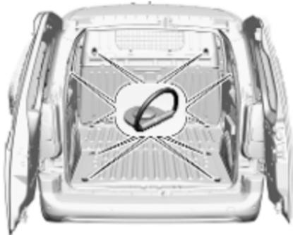
Кріпильні петлі можуть розміщуватися на підлозі автомобіля та на боковій стінці. Кількість та місця розміщення кріпильних петель можуть бути різними залежно від автомобіля.
