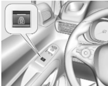
Залежно від версії кнопка ⚡ може розміщуватися на дверцях водія або під вимикачем освітлювальних приладів.
