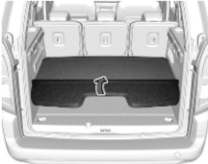
Полицю багажного відділення можна підняти із задньої частини багажника для ефективнішого використання місця в багажному відділенні.
