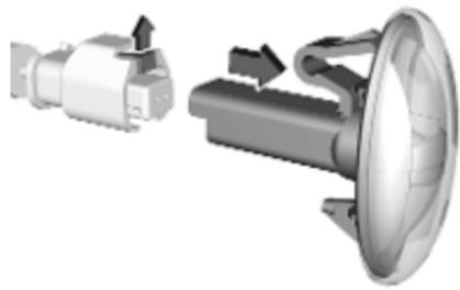
2. Відігніть затискач угору та від'єднайте патрон лампи від роз'єму.
