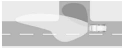
Вмикається під час повороту на швидкості до 40 км/год. Залежно від того, на який кут повернуто колеса та чи ввімкнено освітлювальні прилади, передня протитуманна фара освітлюватиме напрямок руху.
