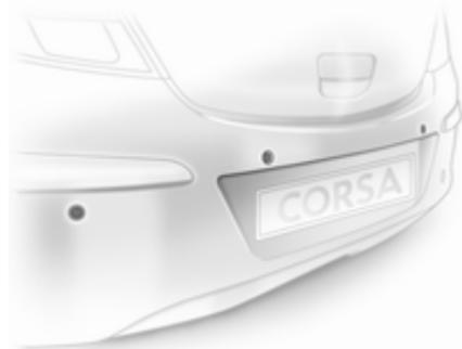
Система допомоги під час паркування полегшує паркування, вимірюючи відстань між автомобілем і перешкодами. Проте лише водій несе повну відповідальність за паркування.
