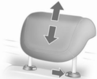
Висоту підголівників можна відрегулювати у двох положеннях. Для встановлення першого положення потягніть підголівник вперед, для другого – натисніть пружинний затискач, зображений на рисунку, і потягніть підголівник угору до максимально можливого положення. Щоб опустити підголівник уніз, задійте зображеній на рисунку затискач і опустіть підголівник уніз, натискаючи його.
