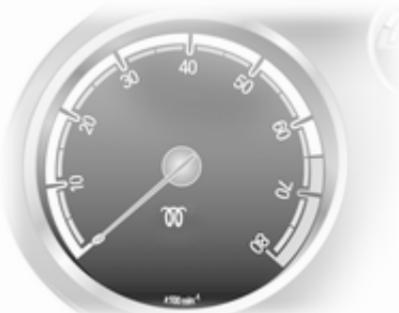
Контрольний індикатор гасне відразу після виконання операції із самоочистки.
