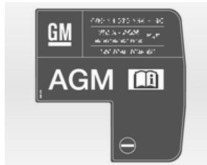
Акумулятор AGM можна розпізнати по ярлику на акумуляторі. Ми рекомендуємо використовувати фірмовий акумулятор Opel.
