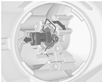
3. Зніміть пружинний затискач із утримувача, повертуючи його вбік.
