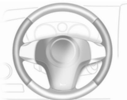
Під час роботи двигуна та при активній функції Autostop, кермове колесо підігрівається у ділянках, показаних на ілюстрації.
