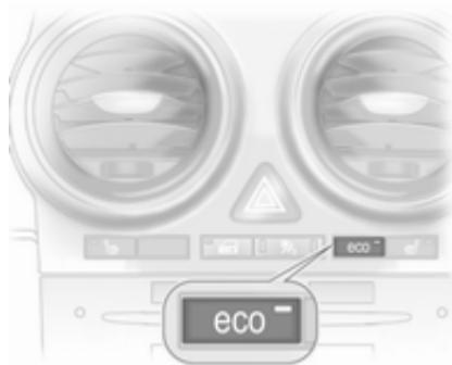
Вимкніть систему стоп-старт вручну, шляхом натискання на кнопку **eco**. Вимкнення підтверджується тим, що світлодіодний індикатор у кнопці гасне.
