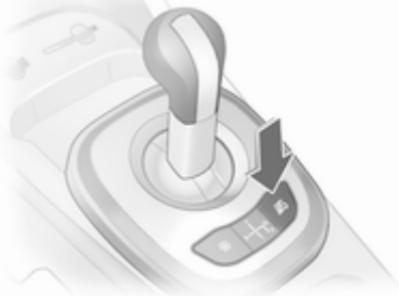
У спортивному режимі інтервали перемикання передач скорочуються, а трансмісія перемикає передачі на більш високих обертах двигуна (окрім випадків, коли ввімкнено систему круїз-контролю).
