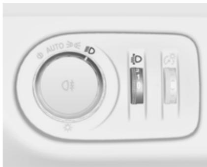
Щоб адаптувати діапазон освітлення фарами до навантаження автомобіля для запобігання засліпленню: Повертайте колесо регулятора ↴, доки на дисплеї пробігу в кілометрах не відобразиться потрібний параметр. Інформація на дисплеї відображається протягом
