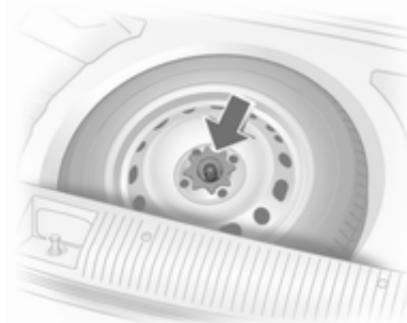
Запасне колесо розташоване в багажному відділенні під покриттям полика. Воно закріплюється крильчатою гайкою.
