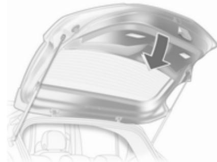
Використовуйте внутрішню ручку. Закриваючи багажник, не натискайте кнопку під молдингом, оскільки внаслідок цього його буде знову розблоковано.
