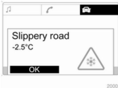
В автомобілях з Graphic-Info-Display або Color-Info-Display на дисплеї відображається повідомлення з попередженням про ожеледицю на дорозі. У разі, якщо температура є нижчою -5°C, повідомлення не відображається.
