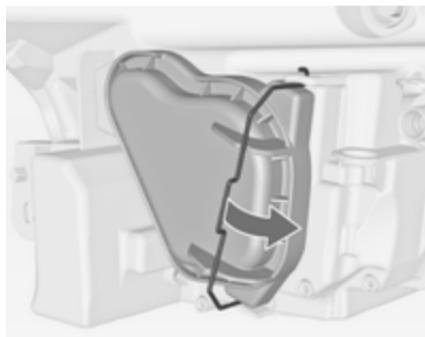
1. Від'єнайте затискач електропровідні та вийміть захисну кришку 1.
