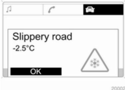
В автомобілях з Graphic-Info-Display або Color-Info-Display на дисплеї відображається повідомлення з попередженням про ожеледицю на дорозі. У разі, якщо температура є нижчою  $-5^{\circ}\text{C}$ , повідомлення не відображається.
