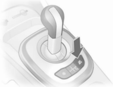
У спортивному режимі інтервали перемикання передач скорочуються, а трансмісія перемикає передачі на більш високих обертах двигуна (окрім випадків, коли ввімкнено систему круїз-контролю).
