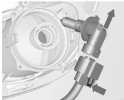
2. Від'єднайте тримач від з'єднувача, натиснувши закріплювач.
