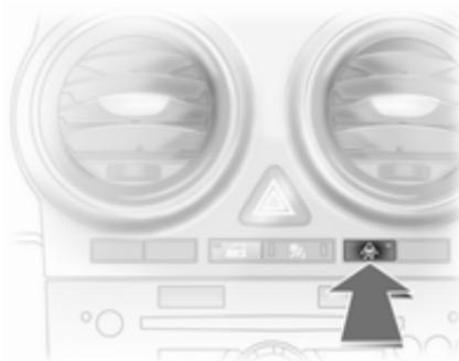
Систему ESP<sup>Plus</sup> можна вимкнути натисканням кнопки
