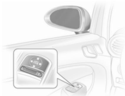
Спершу виберіть відповідне зовнішнє дзеркало, після чого за допомогою регулятора відрегулюйте положення дзеркала.
