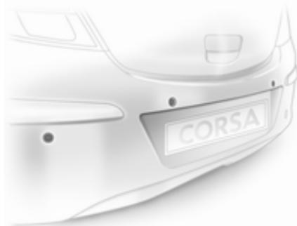
Система допомоги під час паркування полегшує паркування, вимірюючи відстань між автомобілем і перешкодами. Проте лише водій несе повну відповідальність за паркування.
