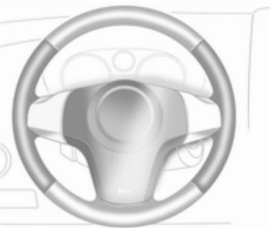
Під час роботи двигуна та при активній функції Автостоп, кермове колесо підігрівається у ділянках, показаних на ілюстрації.
