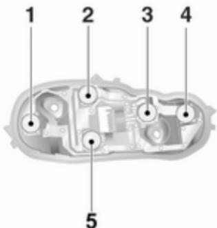
6. Легко втисніть лампу в патрон, поверніть проти годинникової стрілки, зніміть несправну лампу та замініть її на нову.
