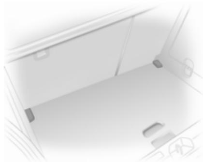
Якщо полик розміщений у піднятому положенні, простір між ним і кришкою заглиблення для запасного колеса може використовуватися як відділення для зберігання.
