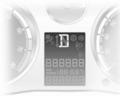
Режим або вибрана передача відображаються на дисплеї трансмісії.
