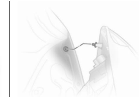
9. Вставте корпус патрона в кузов автомобіля, закрутівши гайки рукою. Вставте штекерний з'єднувач. Закрійте кришку.
