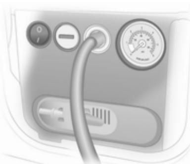
8. Натисніть вимикач компресора on/off. Шина наповнюється ущільнювачем.
