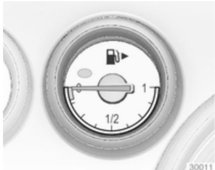
Цей датчик відображає інформацію про рівень палива або тиск газу в баку, залежно від робочого режиму.
