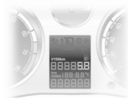
Бортовий комп'ютер постійно фіксує інформацію щодо подорожі, виконує її цифрову обробку та відображає на дисплеї.
