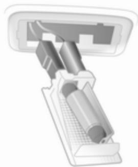
2. Легко натисніть лампу до пружинного зажиму та вийміть її.
