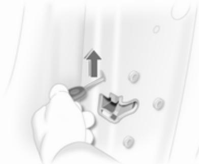
Вставте ключ в отвір, розташований на внутрішній стороні дверцят над замком, та активуйте блокування, піднявши ключ угору до характерного клацання. Потім зачиніть дверцята. Процедура повинна виконуватися для кожних дверцят. Дверцята водія також можна заблокувати ззовні за допомогою ключа. Кришку заливної горловини паливного баку та багажник заблокувати не можна.
