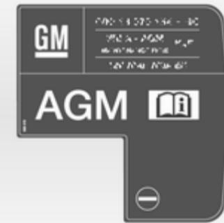
Акумулятор AGM можна розпізнати по ярлику на акумуляторі. Ми рекомендуємо використовувати фірмовий акумулятор Opel.
