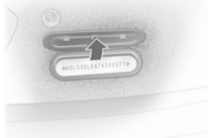
Ідентифікаційний номер автомобіля нанесено на маркувальній табличці, на днищі автомобіля та під покриттям полика, його можна побачити під покриттям.
