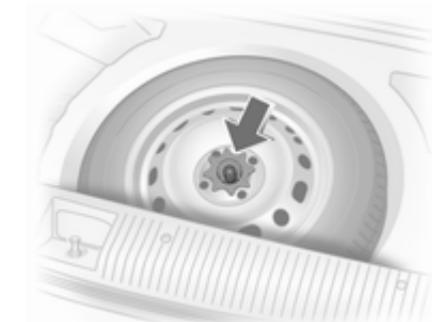
Запасне колесо розташоване в багажному відділенні під покриттям полика. Воно закріплюється крильчаткою гайкою.
