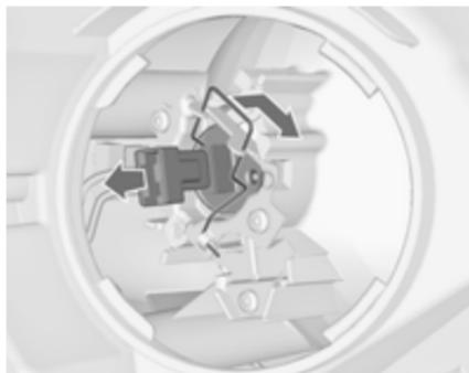
3. Зніміть пружинний затискач із утримувача, повертаючи його вбік.
