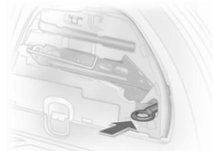
Буксирна провушинна зберігається разом з інструментами до автомобіля  $\Phi$  193. Буксирна провушинна знаходитьться у виступі.
