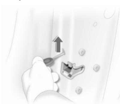
Вставте ключ в отвір, розташований на внутрішній стороні дверцят над замком, та активуйте блокування, піднявши ключ угору до характерного клацання. Потім зачиніть дверцята. Процедура повинна виконуватися для кожних дверцят. Дверцята водія також можна заблокувати ззовні за допомогою ключа. Кришку заливної горловини паливного бака та багажник заблокувати не можна.
