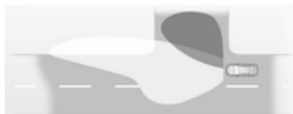
На поворотах з обмеженою видимістю чи під час звертання з дороги, залежно від кута керма чи сигналу індикатора, ліворуч або праворуч вмикається додатковий рефлектор, який освітлює дорогу в напрямку руху. Вона активується на швидкості 40 км/год.
