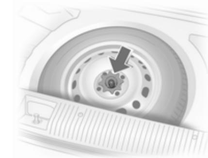
Запасне колесо розташоване в багажному відділенні під кришкою підлоги. Воно закріплюється крильчатою гайкою.
