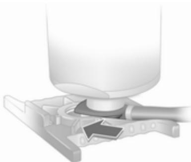
2. Відчепіть повітряний шланг від кронштейна та прикрутіть його на з'єднання пляшки з ущільнювачем.
