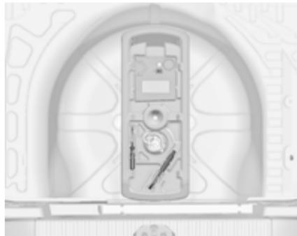
Варіант 2: набір інструментів зберігається в відділенні багажника під кришкою підлоги разом із набором для ремонту шин.
