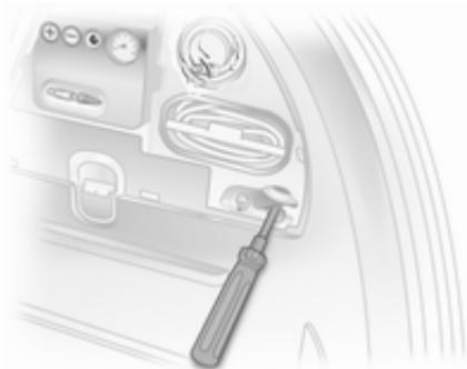
Варіант 1: набір інструментів зберігається в правому відділенні багажника разом із набором для ремонту шин.
