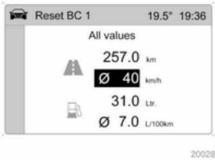
Інформацію двох бортових комп'ютерів можна скинути окремо, що робить можливим відображення різних відстаней.
