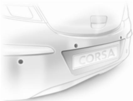
Система допомоги під час паркування полегшує процес паркування, вимірюючи відстань між автомобілем і перешкодами та відтворюючи звуковий сигнал. Проте за виконувані маневри під час паркування відповідає лише водій.
