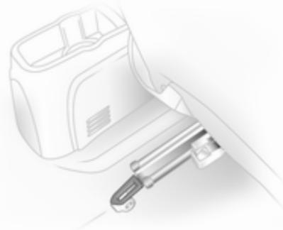
На обшивці задніх опор даху та в точках кріплення розташовані символи, які позначають отвори кріплення для встановлення дитячого автокрісла.
