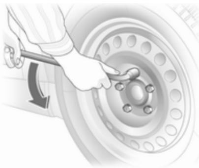
2. Встановіть ключ і переконайтесь, що він розташований надійно. На півверти послабте кожен болт. Колеса можуть бути захищені за допомогою стопорних колісних болтів. Щоб ослабити ці спеціальні болти, спершу приєднайте перехідник ключа
