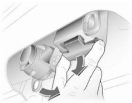
Відключіть та складіть розетку. Вийміть ущільнючу пробку з отвору для штанги та приберіть її.
