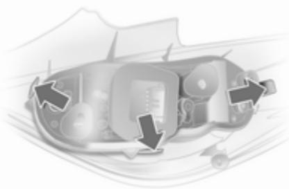
5. Злегка витисніть три блокувальні закріплювачі на зовнішній стороні корпуса патрона та зніміть тримач лампи.
