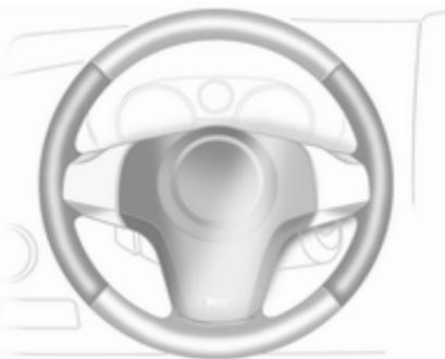
Під час роботи двигуна та при активній функції Автостоп, кермове колесо підігрівається у ділянках, показаних на ілюстрації.
