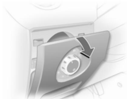
В автомобілях із лівостороннім керуванням блок запобіжників розміщений за вимикачем вимикачем світла. Потягніть за верхній край панелі та відкрийте.
