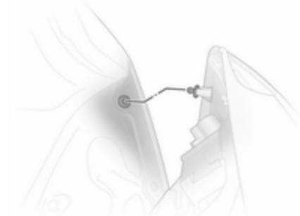
9. Вставте корпус патрона в кузов автомобіля, закрутівши гайки рукою. Вставте штекерний з'єднувач. Закройте кришку.
