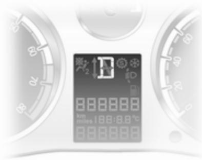
Режим або вибрана передача відображаються на дисплеї трансмісії.
