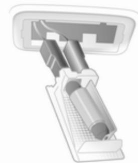
2. Легко натисніть лампу до пружинного зажиму та вийміть її.
