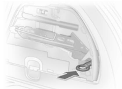
Буксирна провушинна зберігається разом з інструментами до автомобіля  $\Phi 188$ . Буксирна провушинна знаходитьться у виступі.
