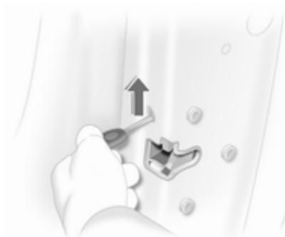
Вставте ключ в отвір, розташований на внутрішній стороні дверцят над замком, та активуйте блокування, піднявши ключ угору до характерного класання. Потім зачиніть дверцята. Процедура повинна виконуватися для кожних дверцят. Дверцята водія також можна заблокувати ззовні за допомогою ключа. Кришку заливної горловини паливного бака та багажник заблокувати не можна.
