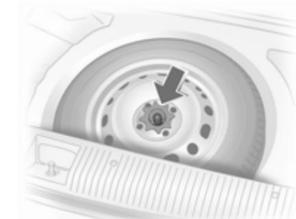
Запасне колесо розташоване в багажному відділенні під покриттям полика. Воно закріплюється крильчатою гайкою.
