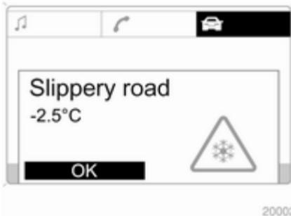
В автомобілях з Graphic-Info-Display або Colour-Info-Display на дисплеї відображається повідомлення з попередженням про ожеледицю на дорозі. У разі, якщо температура є нижчою -5 °C, повідомлення не відображається.
