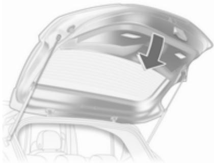
Користуйтесь внутрішньою ручкою. Закриваючи багажник, не натискайте кнопку під молдингом, оскільки внаслідок цього його буде знову розблоковано.
