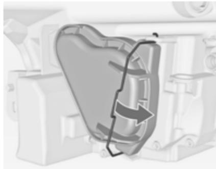
1. Від'єрайте затискач електропровідні та вийміть захисну кришку 1.
