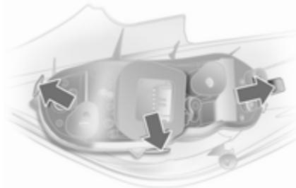
5. Злегка витисніть три блокувальні закріплювачі на зовнішній стороні корпуса патрона та зніміть тримач лампи.
