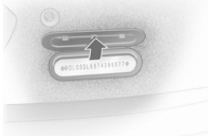
Ідентифікаційний номер автомобіля нанесено на маркувальній табличці, на днищі автомобіля та під покриттям полика, його можна побачити під покриттям.
