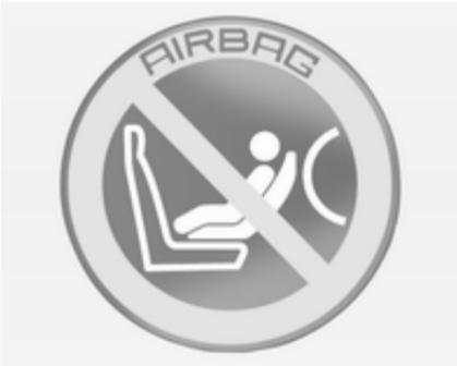
Окрім цього, є наліпка з попередженням з боку панелі приладів, яку видно, коли дверцята переднього пасажира відчинені, а також на сонцевахисному козирку пасажира.
