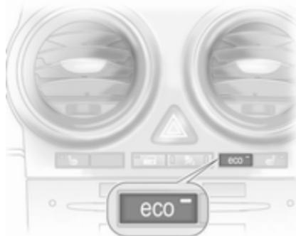
Вимкніть систему стоп-старт вручну, шляхом натискання на кнопку **eco**. Вимкнення підтверджується тим, що світлодіодний індикатор у кнопці гасне.
