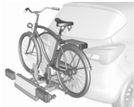
Задня система кріплення багажу (система Flex-Fix) дозволяє закріплювати велосипеди на витяжному тримачі, інтегрованому в підлогу автомобіля. Перевезення інших речей заборонено.
