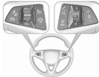
Круїз-контролем, обмежувачем швидкості, налаштуваннями системи попередження про зіткнення спереду, інформаційно-розважальною системою та підключеним мобільним телефоном можна керувати за допомогою органів керування на кермі.
