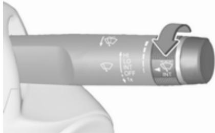
Поверніть колесо регулятора, щоб відрегулювати чутливість:
