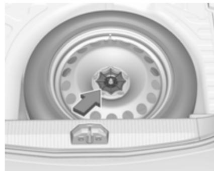
Запасне колесо розташоване в багажному відділенні під кришкою підлоги. Воно закріплюється крильчаткою гайкою.
