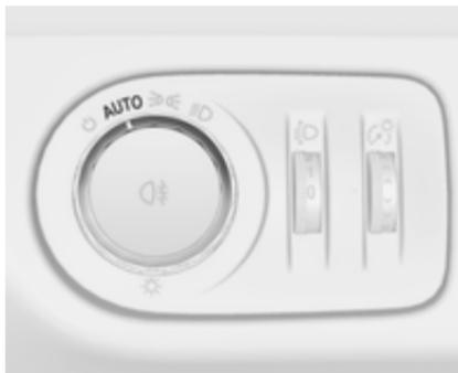
Коли функцію автоматичного керування освітленням увімкнено і двигун працює, система автоматично перемикається з ліхтарів денного освітлення на фари й навпаки залежно від умов освітлення та даних, які надходять із системи датчиків дощу.
