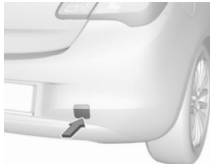
Вставте викрутку в отвір у нижньому вигині кришки. Обережно опускайте викрутку вниз, щоб зняти кришку. Буксирна провушина зберігається разом з інструментами до автомобіля ⇨ 223.
