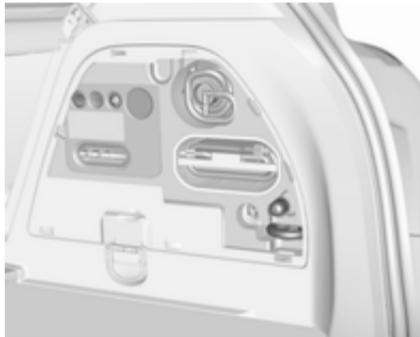
У моделях із задньою системою кріплення або подвійним дном інструменти зберігаються разом із буксирною сергою та комплектом для ремонту шин під кришкою багажного відділення з правого боку.
