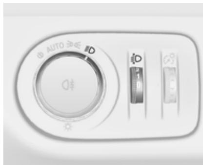
Щоб налаштовувати діапазон освітлення фарами відповідно до навантаження автомобіля і запобігти засліпленню, виконайте такі дії: поверніть колесо регулятора ⚡ в потрібне положення.
