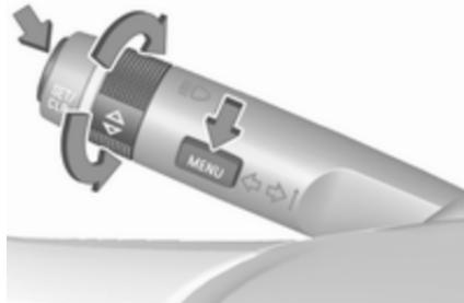
Дорожні знаки відображаються у центрі інформації для водія на сторінці **Система визначення дорожніх знаків**. Виберіть кнопкою "Меню" пункт **Автомобіль**, а потім виберіть пункт **Система визначення дорожніх знаків** коліщатком регулятора на важелі перемикання сигналів повороту  $\diamond 103$ .
