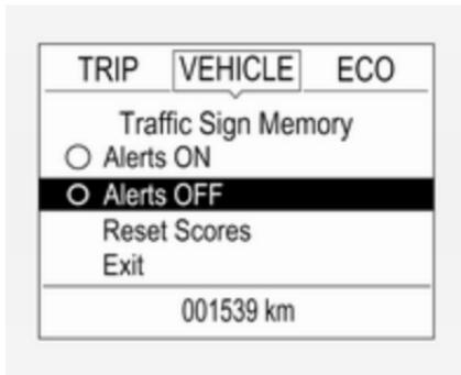
На сторінці налаштувань виберіть **Увімкнути сповіщення**, щоб активувати функцію спливних сповіщень. Щоб вимкнути цю функцію, виберіть **Вимкнути сповіщення**. Після ввімкнення запалювання функція сповіщень вимикається.
