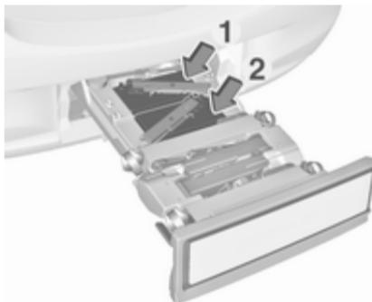
Складіть кронштейни ламп на зворотній частині задніх габаритних ліхтарів.
