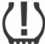
Розпізнавання стану тиску в шинах позначається контрольним індикатором 101.
