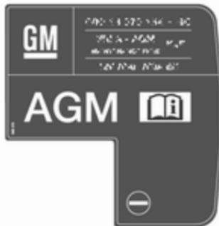
Акумулятор AGM можна розпізнати по ярлику на акумуляторі. Ми рекомендуємо використовувати фірмовий акумулятор Opel.
