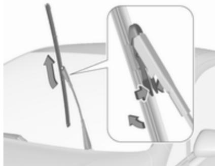
Установіть важіль склоочисника у підняте положення. Натисніть на фіксатори з обох боків, нахиліть щітку склоочисника під кутом 90° до важеля склоочисника і зніміть її, піdnімаючи вгору.
