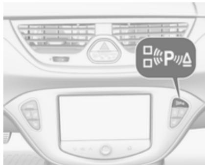
Автомобілі з передньою та задньою системою допомоги під час паркування та системою розширеної допомоги під час паркування обладнано кнопкою **P** ⊞ **Δ**.
