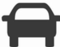
Про наявність автомобіля попереду сигналізує контрольний індикатор
