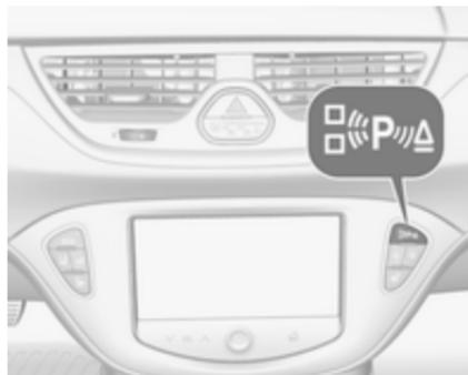
Під час пошуку місця для паркування система приводиться в робочий стан тривалим натиснанням кнопки
