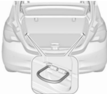
Кріпильні кільця призначені для кріплення предметів, наприклад, за допомогою пасків або сітки для багажу, щоб запобігти їх ковзанню.
