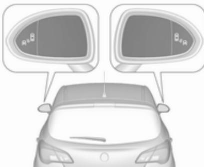
Система попереджує про об'єкти в мертвій зоні діє при швидкостях від 10 км/год до 140 км/год. В разі перевищення швидкості 140 км/год система вимикається, про що свідчиме слабке підсвічування попереджувальних символів ⚠ в обох зовнішніх дзеркалах. При зменшенні швидкості попереджувальні символи гаснуть. Якщо після цього буде розпізнаний автомобіль у мертвій зоні видимості, попереджувальні символи ⚠ будуть засвічуватися, як зазвичай, з відповідного боку.
