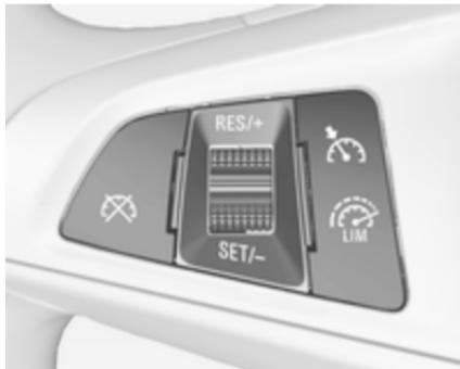
Натисніть кнопку . Якщо круїз-контроль вже ввімкнений, після ввімкнення обмежувача швидкості він вимикається, і контрольний індикатор гасне.
