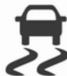
Система ESC готова до роботи після кожного запуску двигуна, щойно контрольний індикатор
