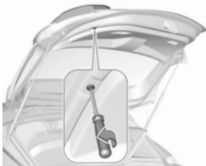
1. Викрутіть гвинт у дверях багажного відділення.
