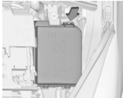
Блок запобіжників знаходитьться ліворуч, скраю відділення для двигуна.
