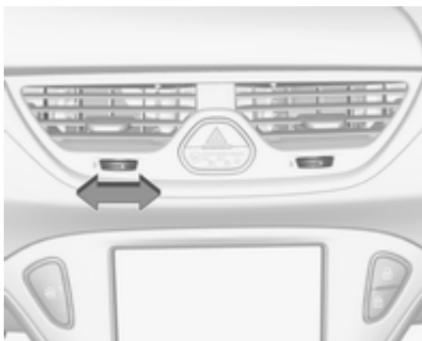
Відрегулюйте потік повітря, що надходить через повітропровід, повернувши колесо регулятора у потрібне положення.
