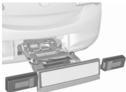
Перевірте положення кабелю та лампи, щоб переконатися в правильному їх установленні та надійному розташуванні.
