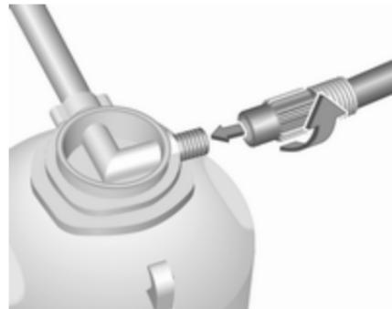
4. Прикрутіть повітропровід компресора до з'єднання на корпусі ущільнювача.
