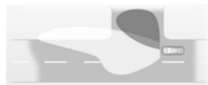
На поворотах з обмеженою видимістю чи під час звертання з дороги, залежно від кута керма чи сигналу індикатора, ліворуч або праворуч вмикається додатковий рефлектор, який освітлює дорогу в напрямку руху. Вона активується на швидкості 40 км/год.
