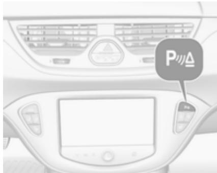
Автомобілі з задньою або передньою та задньою системою допомоги під час паркування обладнано кнопкою **P** ⊞ **Δ**.
