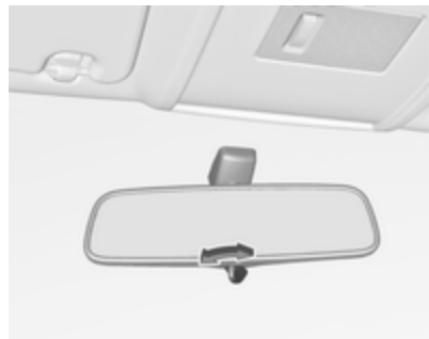
Щоб зменшити засліплювальну дію світла, поверніть важіль на зворотному боці корпусу дзеркала. Внутрішнє дзеркало ⇨ 33.
